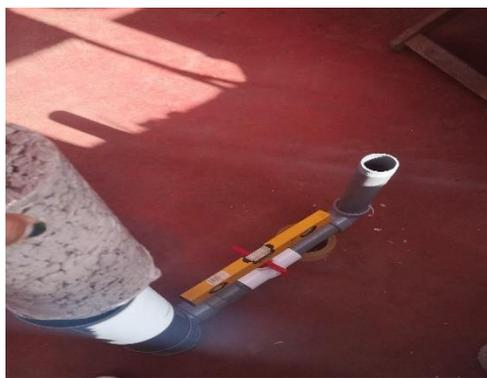
**Figura 98.** Colocado del testigo en el tubo del permeámetro
