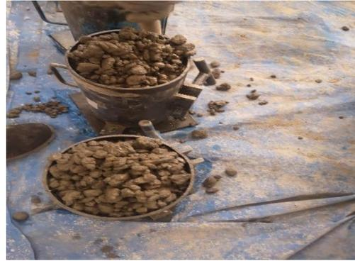
**Figura 89.** Vaciado del concreto en los moldes
