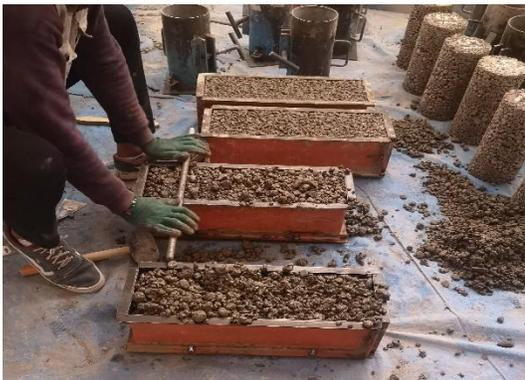
**Figura 92.** Moldeo de Vigas
