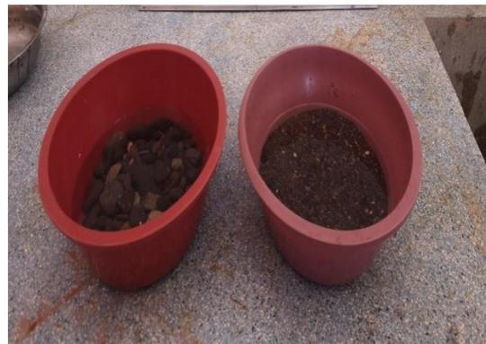
**Figura 81.** Saturación 24 horas del agregado grueso y fino
