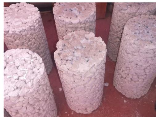
**Figura 99.** Testigos para permeabilidad
