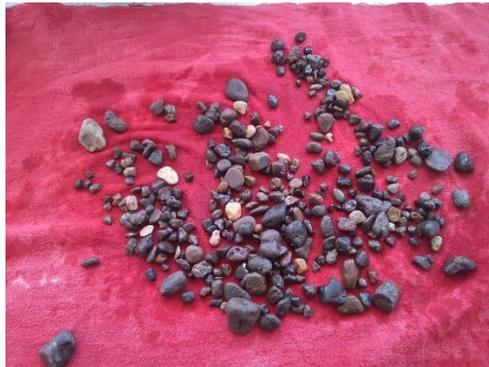
**Figura 84.** Secado del agregado grueso
