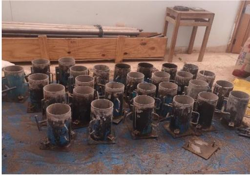
**Figura 88.** Moldes para los testigos
