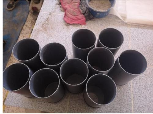
**Figura 95.** Moldes de permeabilidad
