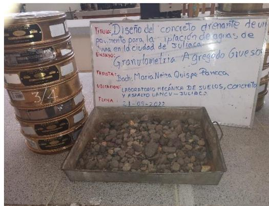
**Figura 76.** Granulometría del agregado grueso
