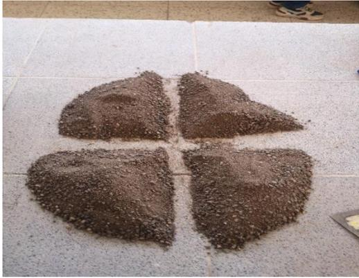
**Figura 71.** Cuarteo de agregado fino
