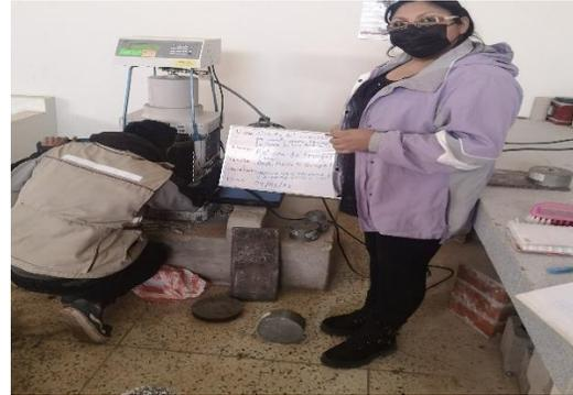
**Figura 91.** Rotura de testigos para resistencia a compresión
