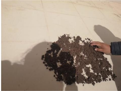
**Figura 82.** Secado de agregado fino
