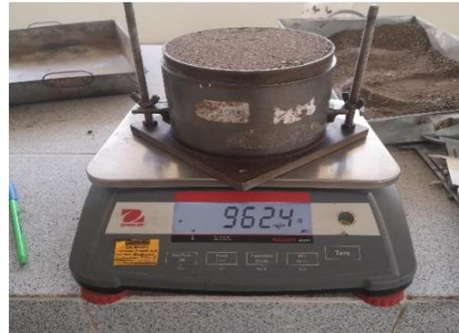
**Figura 79.** Peso unitario compacto del agregado fino
