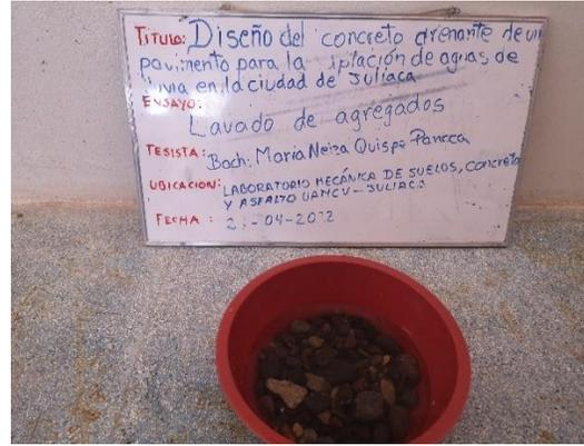
**Figura 72.** Lavado de agregado grueso
