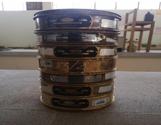
**Figura 75.** Tamices para agregado grueso
