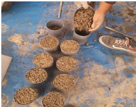
**Figura 96.** Vaciado de testigos para permeabilidad
