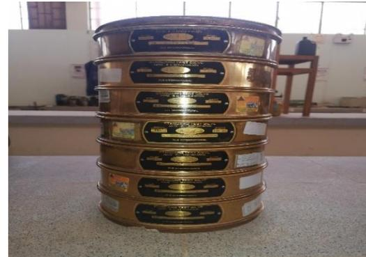
**Figura 74.** Tamices para agregado fino
