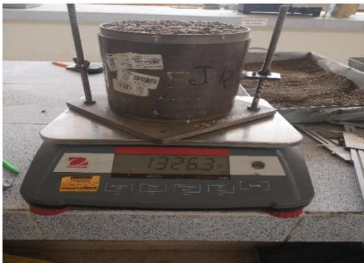
**Figura 80.** Peso unitario compacto del agregado grueso
