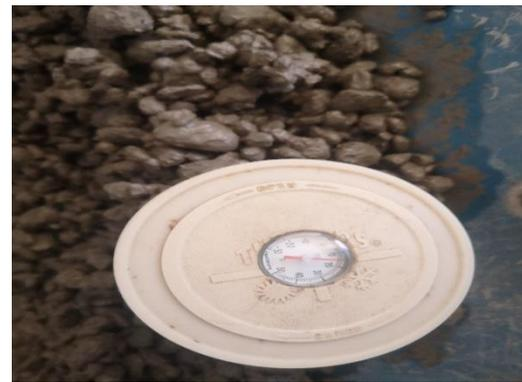
**Figura 87.** Temperatura del concreto
