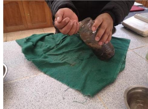
**Figura 83.** Colocación del agregado fino al picnómetro
