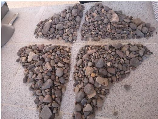
**Figura 69.** Cuarteo del agregado grueso
