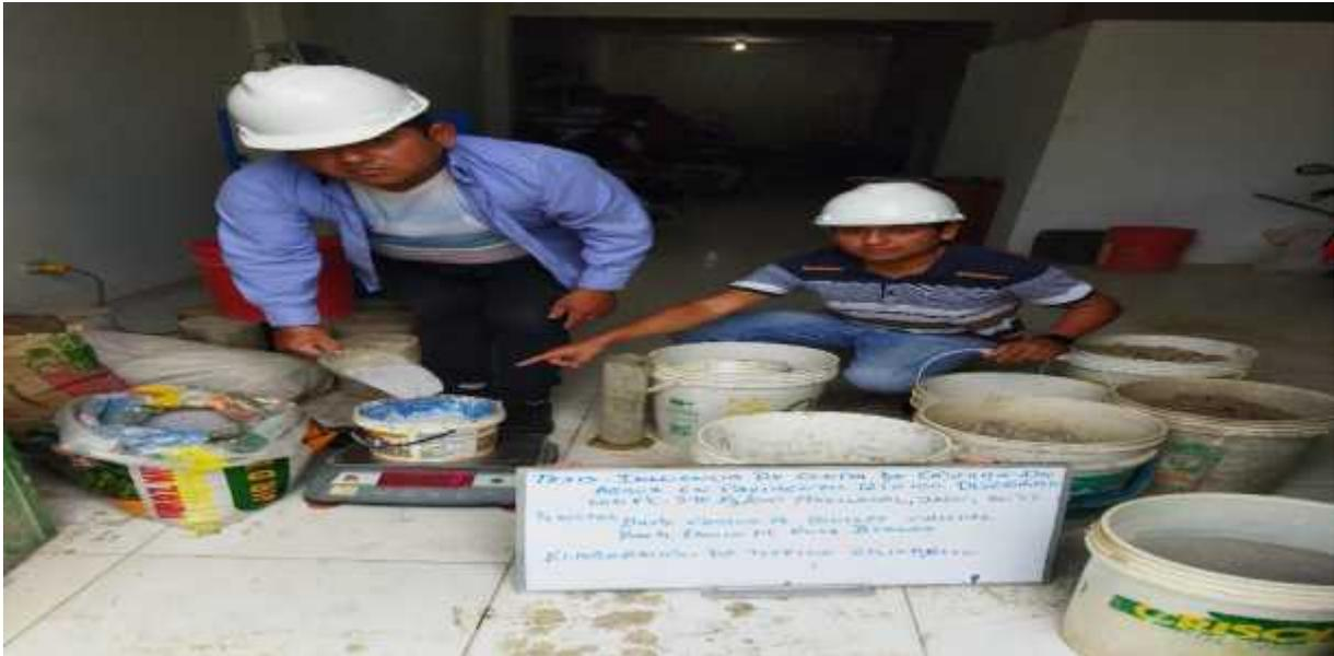
FOTO N° 14: BACHILLERES CARLOS A. QUISPE OBLITAS Y EDWIN M. RUIZ BURGOS, REALIZANDO EL PESAJE DE LOS MATERIALES PARA LA ELABORACIÓN DE LOS TESTIGOS CILINDRICOS.
