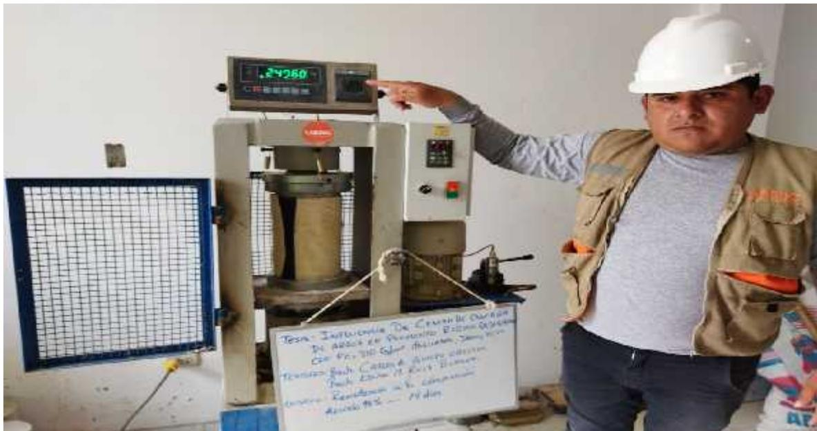
**FOTO N° 42: BACHILLER EDWIN M. RUIZ BURGOS, MOSTRANDO LOS RESULTADOS DE LA ROTURA DE PROBETAS CON ADICIÓN DE CCA AL 15% A LOS 14 DÍAS.**
