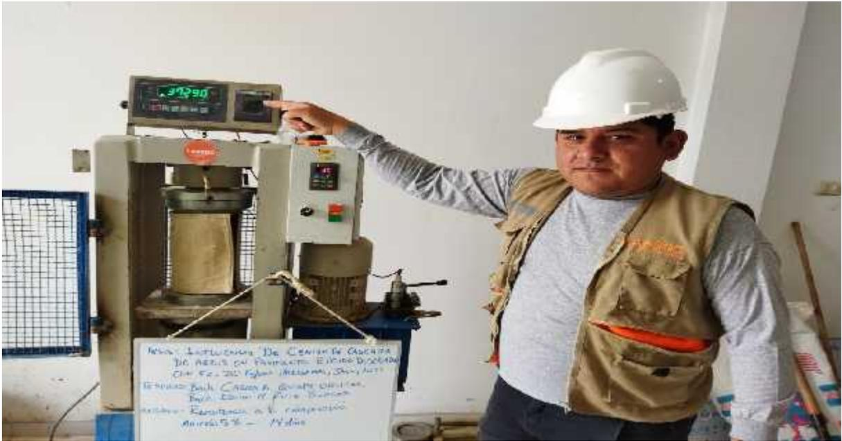
**FOTO N° 29: BACHILLER EDWIN M. RUIZ BURGOS, MOSTRANDO LOS RESULTADOS DE LA ROTURA DE PROBETAS CON ADICIÓN DE CCA AL 05% A LOS 14 DÍAS.**
