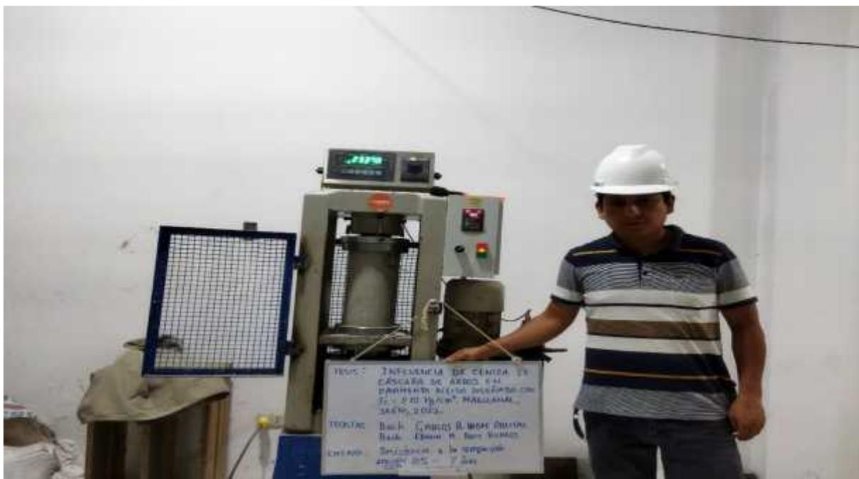
FOTO N° 34: BACHILLER CARLOS A. QUISPE OBLITAS, MOSTRANDO LOS RESULTADOS DE LA ROTURA DE PROBETAS CON ADICIÓN DE CCA AL 10% A LOS 07 DIAS.
