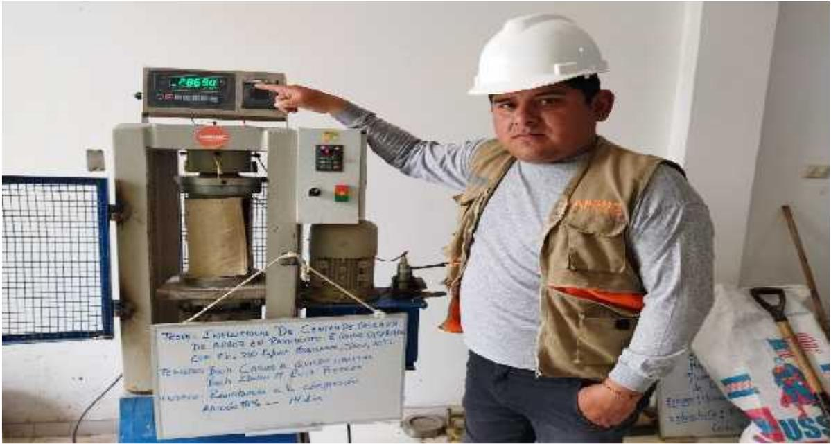
**FOTO N° 35: BACHILLER EDWIN M. RUIZ BURGOS, MOSTRANDO LOS RESULTADOS DE LA ROTURA DE PROBETAS CON ADICIÓN DE CCA AL 10% A LOS 14 DÍAS.**
