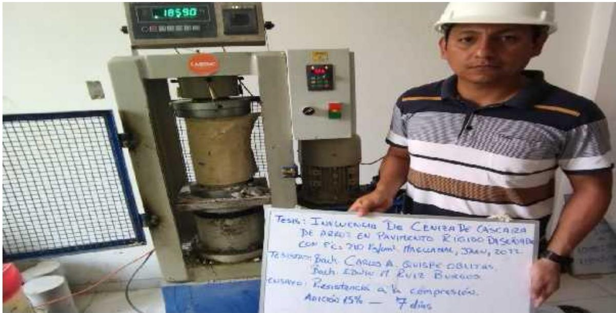
**FOTO N° 39: BACHILLER CARLOS A. QUISPE OBLITAS, MOSTRANDO LOS RESULTADOS DE LA ROTURA DE PROBETAS CON ADICIÓN DE CCA AL 15% A LOS 07 DIAS.**
