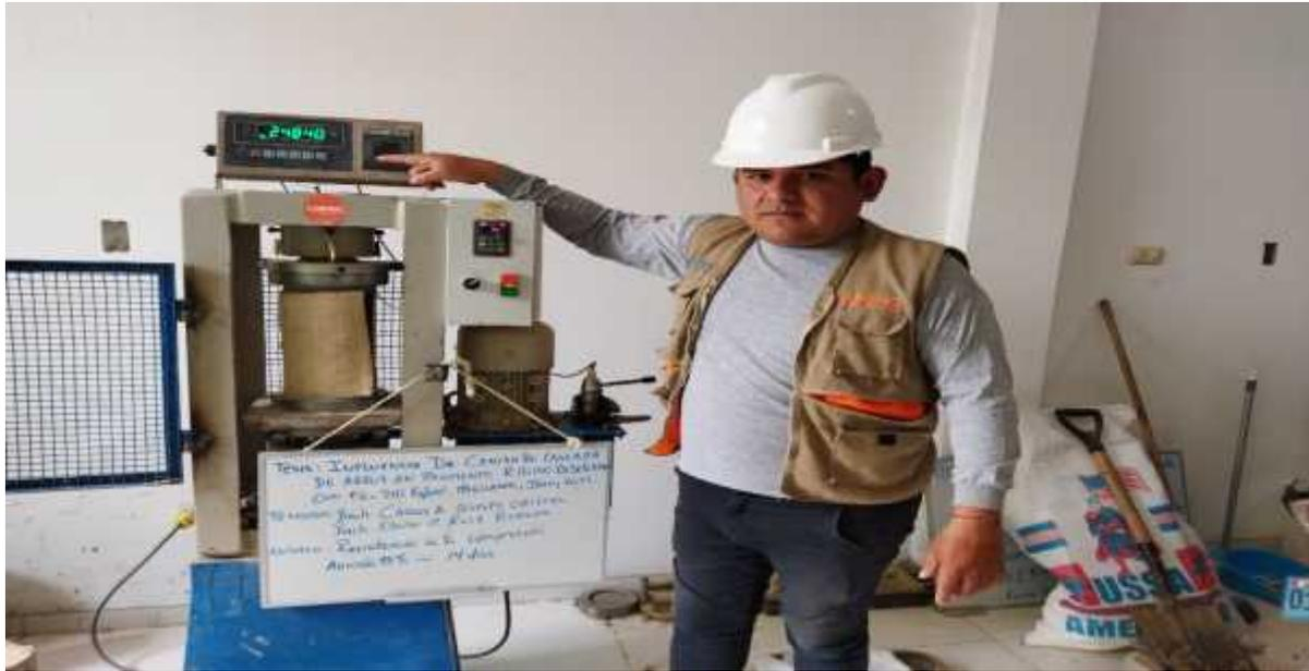
**FOTO N° 41: BACHILLER EDWIN M. RUIZ BURGOS, MOSTRANDO LOS RESULTADOS DE LA ROTURA DE PROBETAS CON ADICIÓN DE CCA AL 15% A LOS 14 DÍAS.**
