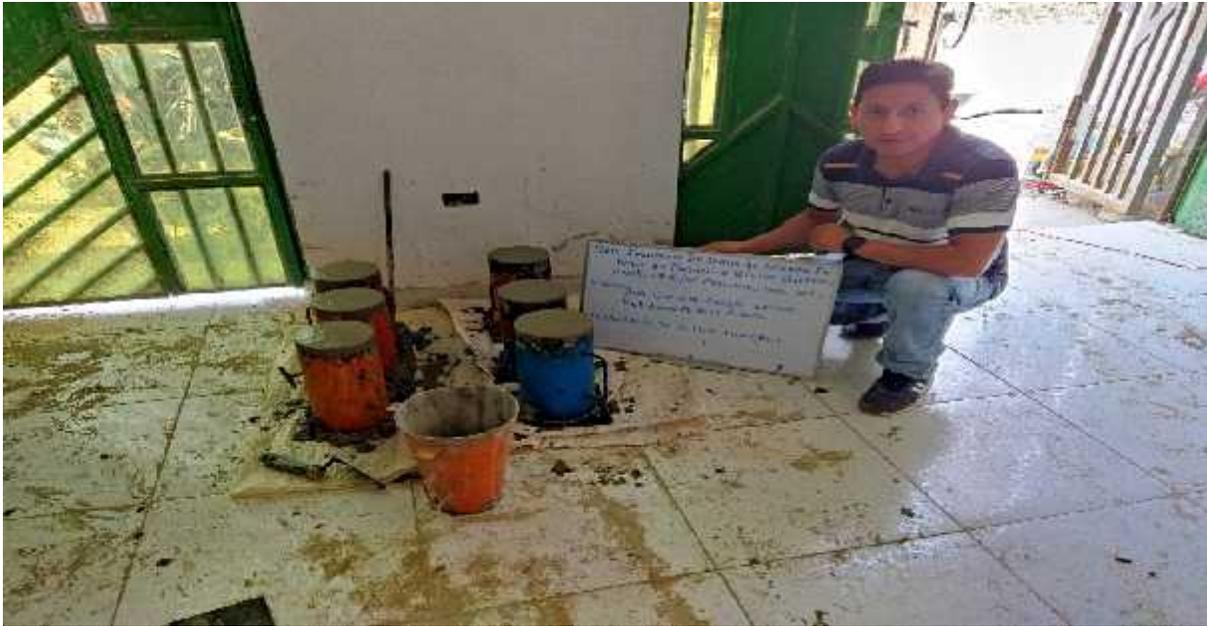
FOTO N° 19: BACHILLER CARLOS A. QUISPE OBLITAS, MOSTRANDO LOS TESTIGOS CILINDRICOS CON Y SIN ADICIÓN DE CCA.
