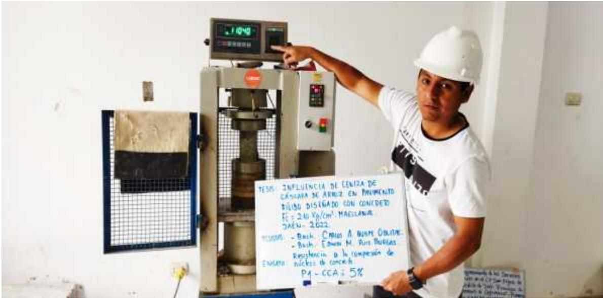
FOTO N° 59: BACHILLER CARLOS A. QUISPE OBLITAS, REALIZANDO LA ROTURA DE NUCLEOS DE CONCRETO (P1) CON ADICIÓN DE CCA AL 05%, EXTRAIDOS A LOS 60 DÍAS EN EL SECTOR MAGLLANAL.
