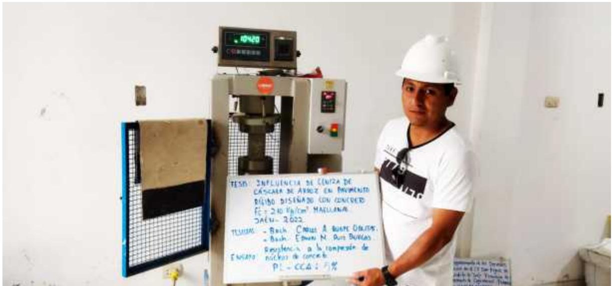
FOTO N° 61: BACHILLER CARLOS A. QUISPE OBLITAS, REALIZANDO LA ROTURA DE NUCLEOS DE CONCRETO (P2) CON ADICIÓN DE CCA AL 05%, EXTRAIDOS A LOS 60 DÍAS EN EL SECTOR MAGLLANAL.
