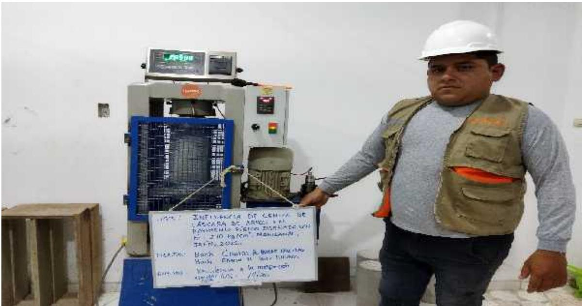
**FOTO N° 36: BACHILLER EDWIN M. RUIZ BURGOS, MOSTRANDO LOS RESULTADOS DE LA ROTURA DE PROBETAS CON ADICIÓN DE CCA AL 10% A LOS 14 DÍAS.**
