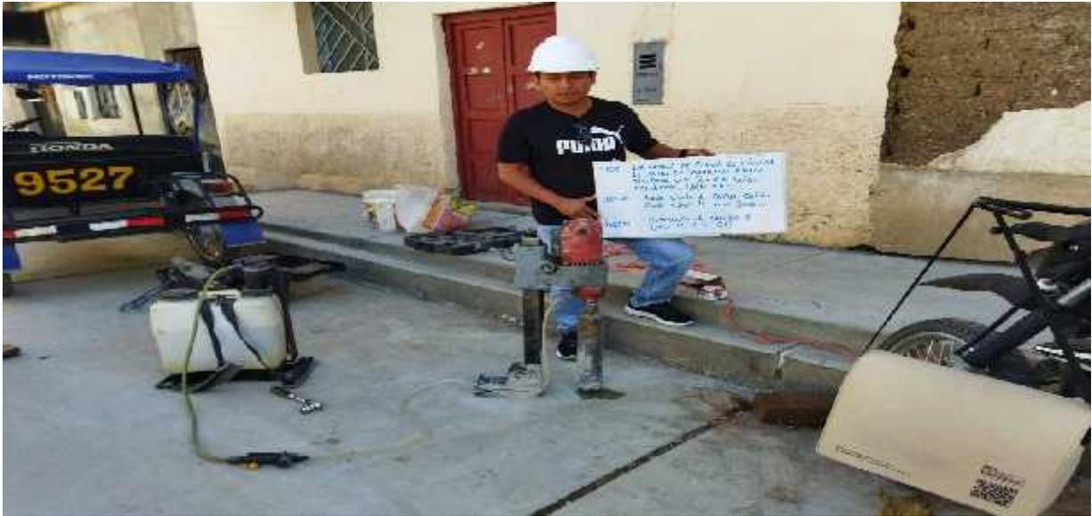
**FOTO N° 53: BACHILLER CARLOS A. QUISPE OBLITAS, REALIZANDO LA EXTRACCIÓN DE NUCLEOS DE CONCRETO CON ADICIÓN DE CCA AL 05%, EXTRAIDOS A LOS 60 DÍAS EN EL SECTOR MAGLLANAL.**
