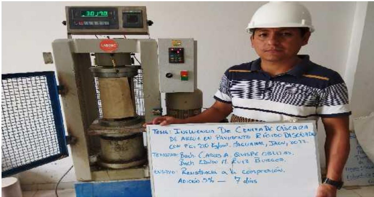
**FOTO N° 27: BACHILLER CARLOS A. QUISPE OBLITAS, MOSTRANDO LOS RESULTADOS DE LA ROTURA DE PROBETAS CON ADICIÓN DE CCA AL 05% A LOS 07 DIAS.**
