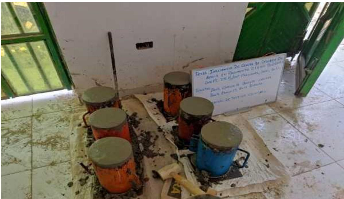
FOTO N° 20: TESTIGOS CILINDRICOS CON Y SIN ADICIÓN DE CCA.
