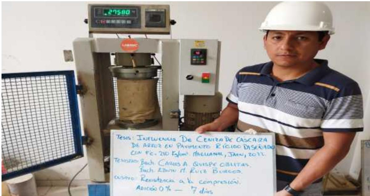
**FOTO N° 21: BACHILLER CARLOS A. QUISPE OBLITAS, MOSTRANDO LOS RESULTADOS DE LA ROTURA DE PROBETAS SIN ADICIÓN DE CCA A LOS 07 DIAS.**
