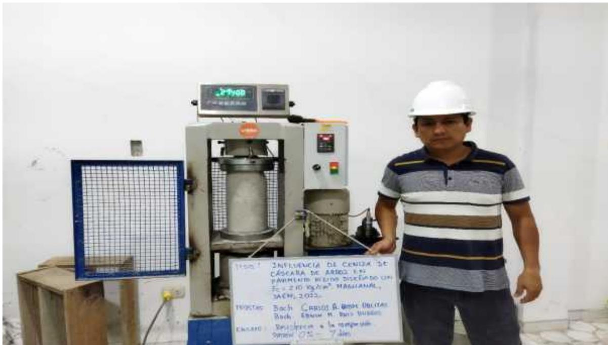
**FOTO N° 22: BACHILLER CARLOS A. QUISPE OBLITAS, MOSTRANDO LOS RESULTADOS DE LA ROTURA DE PROBETAS SIN ADICIÓN DE CCA A LOS 07 DIAS.**
