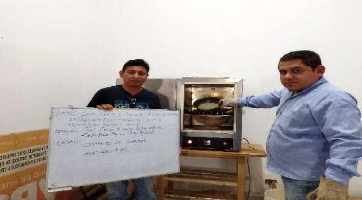
Foto N° 06: ENSAYO CONTENIDO DE HUMEDAD AGREGADO CON FINO.
