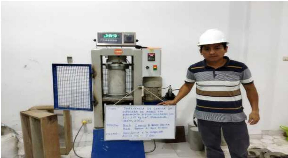
**FOTO N° 28: BACHILLER CARLOS A. QUISPE OBLITAS, MOSTRANDO LOS RESULTADOS DE LA ROTURA DE PROBETAS CON ADICIÓN DE CCA AL 05% A LOS 07 DIAS.**
