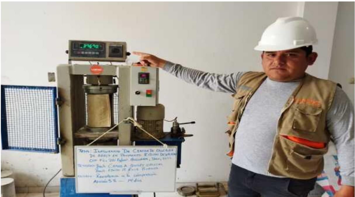
**FOTO N° 30: BACHILLER EDWIN M. RUIZ BURGOS, MOSTRANDO LOS RESULTADOS DE LA ROTURA DE PROBETAS CON ADICIÓN DE CCA AL 05% A LOS 14 DÍAS.**
