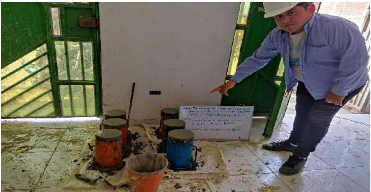
**FOTO N° 18: BACHILLER EDWIN M. RUIZ BURGOS, MOSTRANDO LOS TESTIGOS CILINDRICOS CON Y SIN ADICIÓN DE CCA.**
