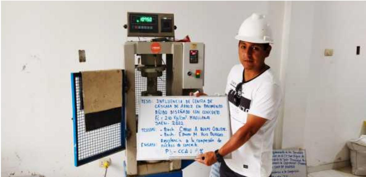
FOTO N° 63: BACHILLER CARLOS A. QUISPE OBLITAS, REALIZANDO LA ROTURA DE NUCLEOS DE CONCRETO (P3) CON ADICIÓN DE CCA AL 05%, EXTRAIDOS A LOS 60 DÍAS EN EL SECTOR MAGLLANAL.
