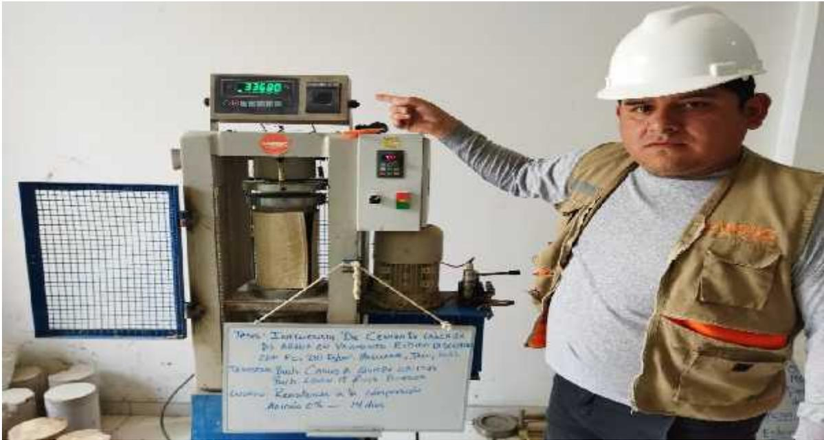
FOTO N° 23: BACHILLER EDWIN M. RUIZ BURGOS, MOSTRANDO LOS RESULTADOS DE LA ROTURA DE PROBETAS SIN ADICIÓN DE CCA A LOS 14 DIAS.
