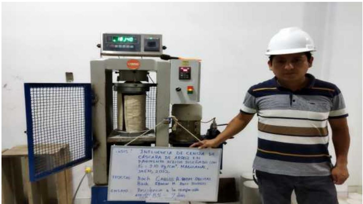
**FOTO N° 40: BACHILLER CARLOS A. QUISPE OBLITAS, MOSTRANDO LOS RESULTADOS DE LA ROTURA DE PROBETAS CON ADICIÓN DE CCA AL 15% A LOS 07 DIAS.**
