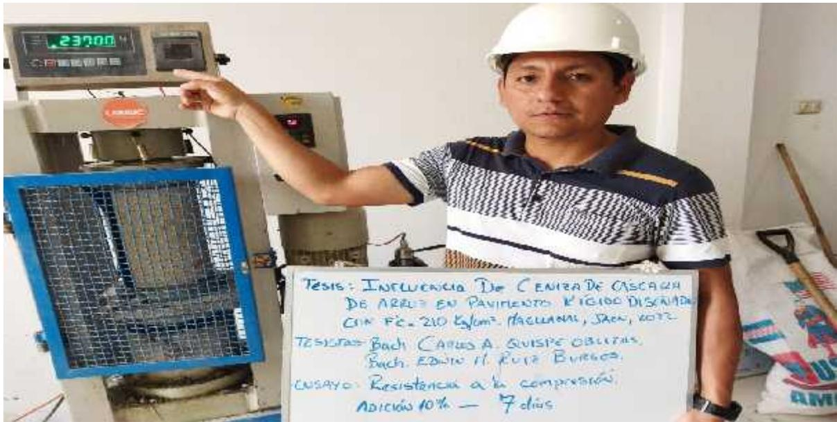
FOTO N° 33: BACHILLER CARLOS A. QUISPE OBLITAS, MOSTRANDO LOS RESULTADOS DE LA ROTURA DE PROBETAS CON ADICIÓN DE CCA AL 10% A LOS 07 DIAS.
