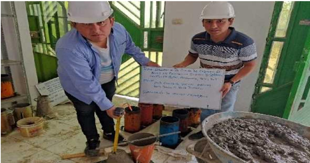
**FOTO N° 16: BACHILLERES CARLOS A. QUISPE OBLITAS Y EDWIN M. RUIZ BURGOS, REALIZANDO EL ENSAYO DE SLUMP CON LA MEZCLA HECHA PARA LA ELABORACIÓN DE LOS TESTIGOS CILINDRICOS.**
