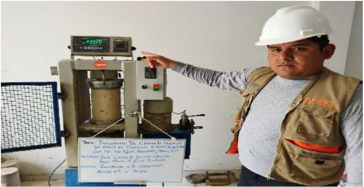
FOTO N° 24: BACHILLER EDWIN M. RUIZ BURGOS, MOSTRANDO LOS RESULTADOS DE LA ROTURA DE PROBETAS SIN ADICIÓN DE CCA A LOS 14 DIAS.
