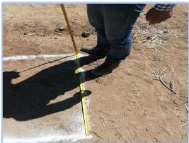
Ilustración 2 ANCHO DE CALICATA
