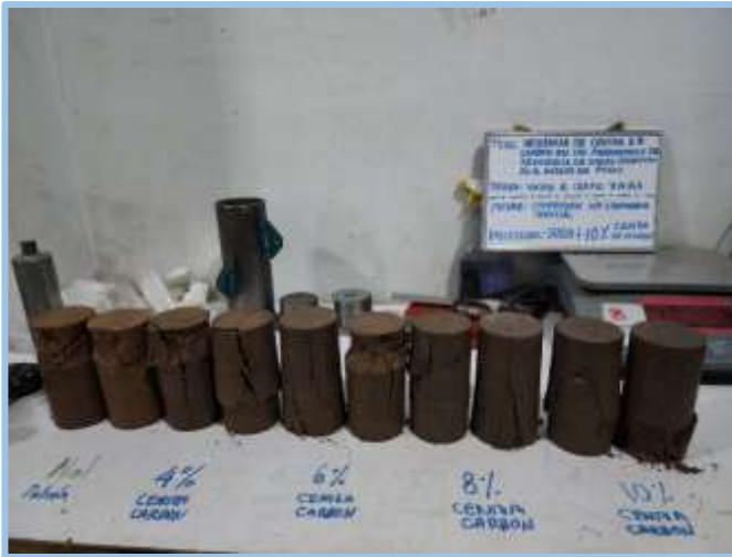
Ilustración 32 FALLA DE MUESTRAS
