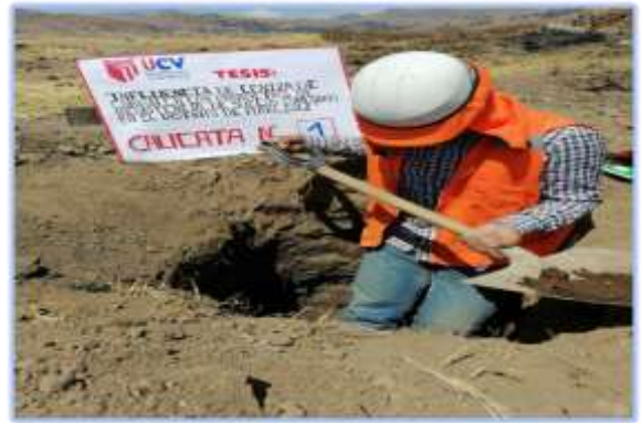
Ilustración 7 EXCAVACION DE CALICATA
