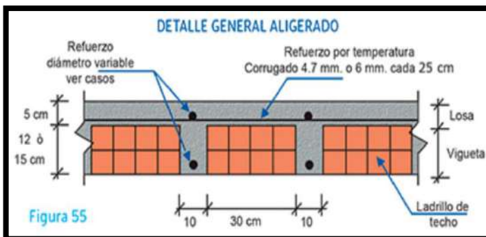
Figura N°29; detalle general de losa aligerado
