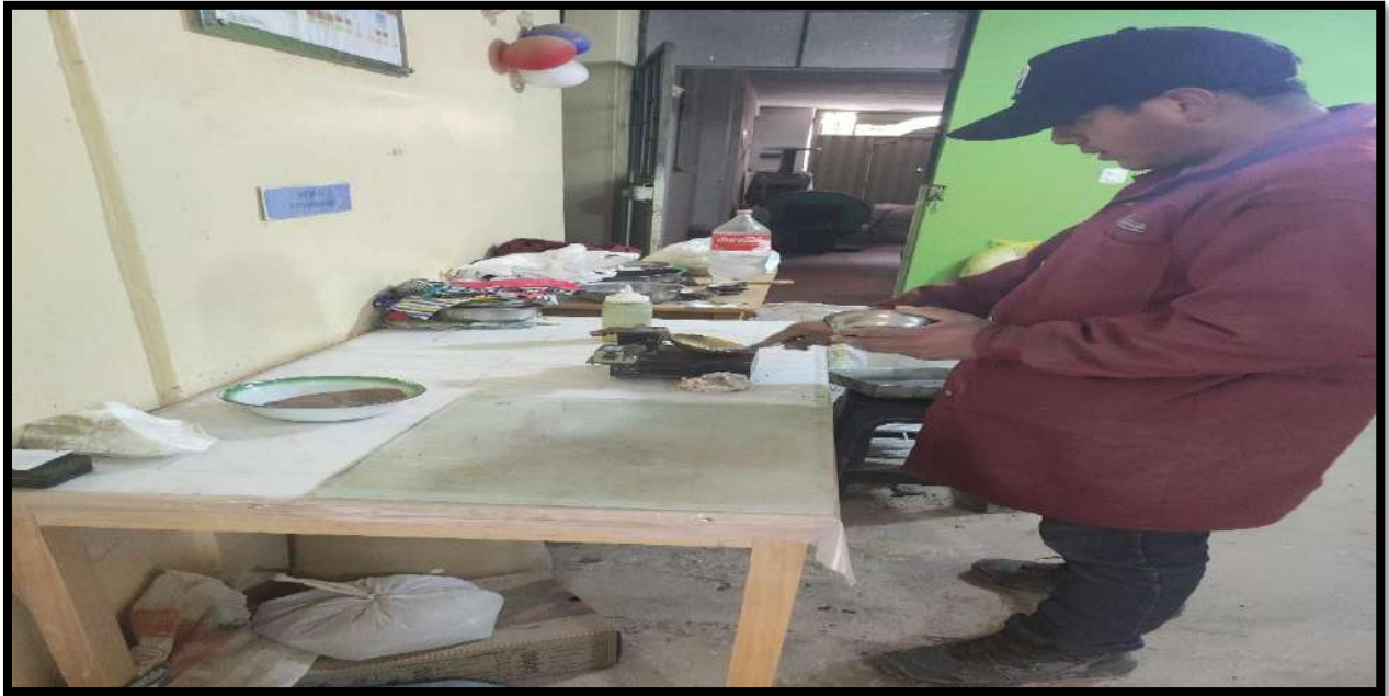
Figura N°16; realizacion el ensayo de limites de atterberg.
