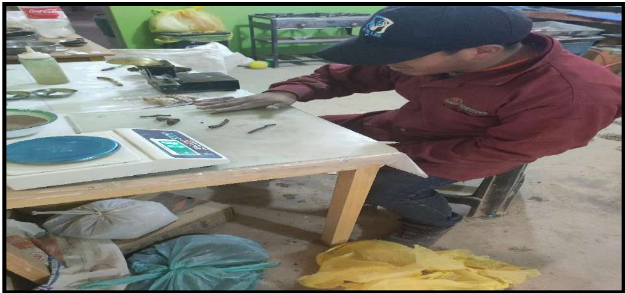
Figura N°17; realizacion el ensayo de limites de consistencia
