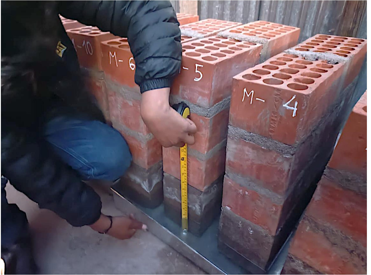
Foto 33: Medición de las alturas capilares a las 100 horas
