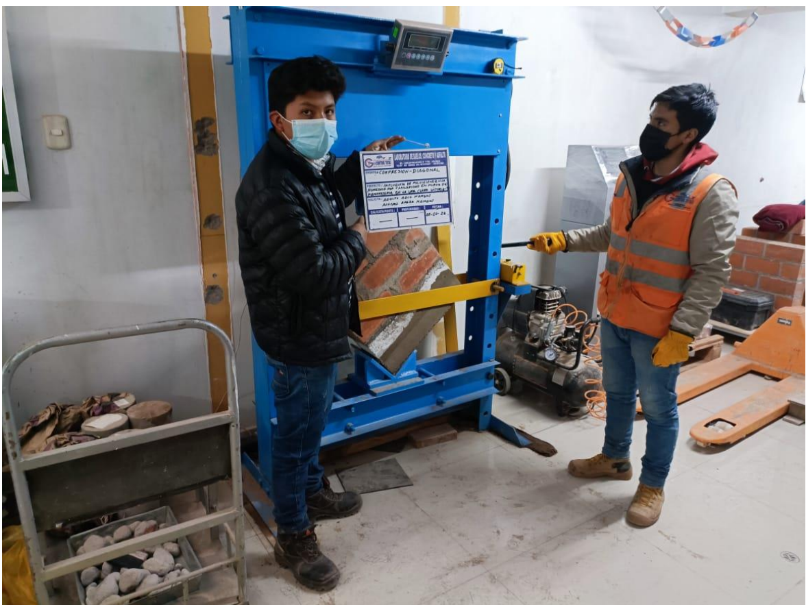
Foto 50: medición del ensayo de la compresión de los muros a escala
