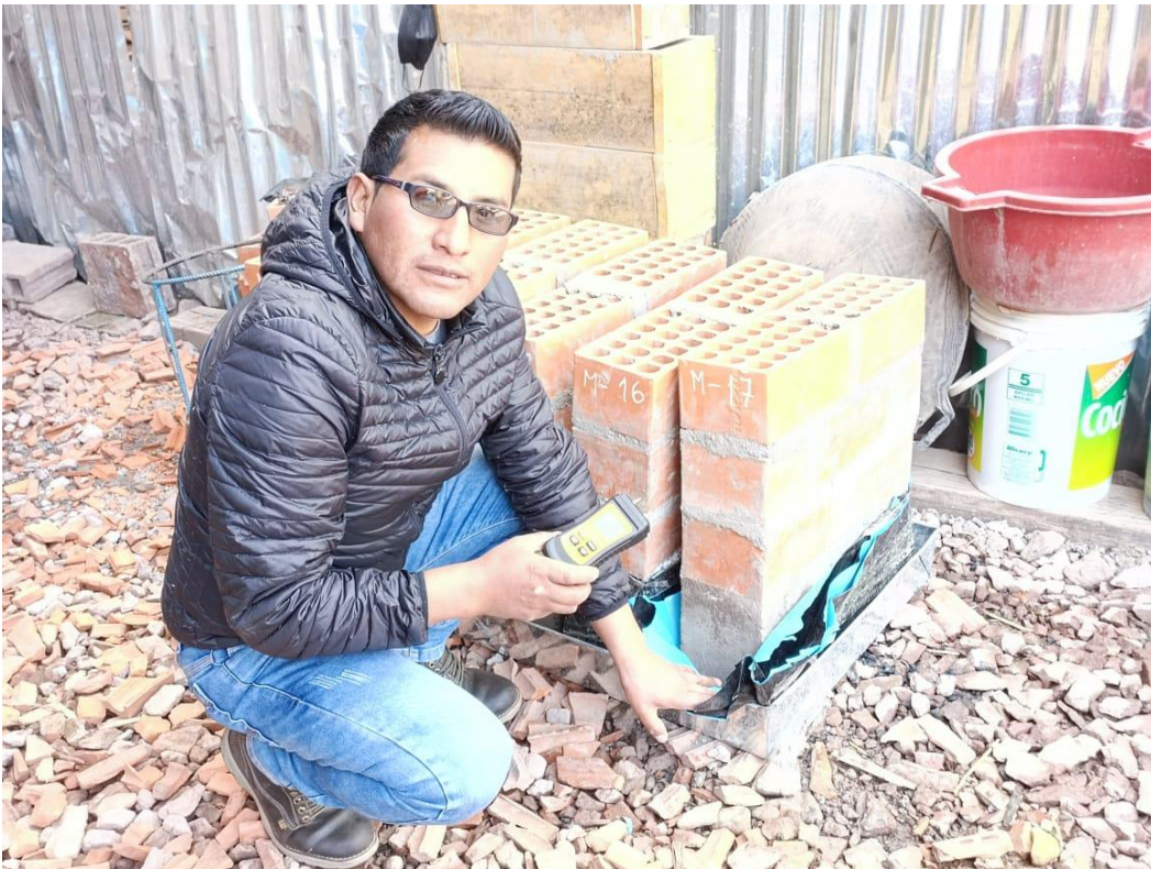
Foto 48: Medición de porcentaje de humedad alas 1000 horas
