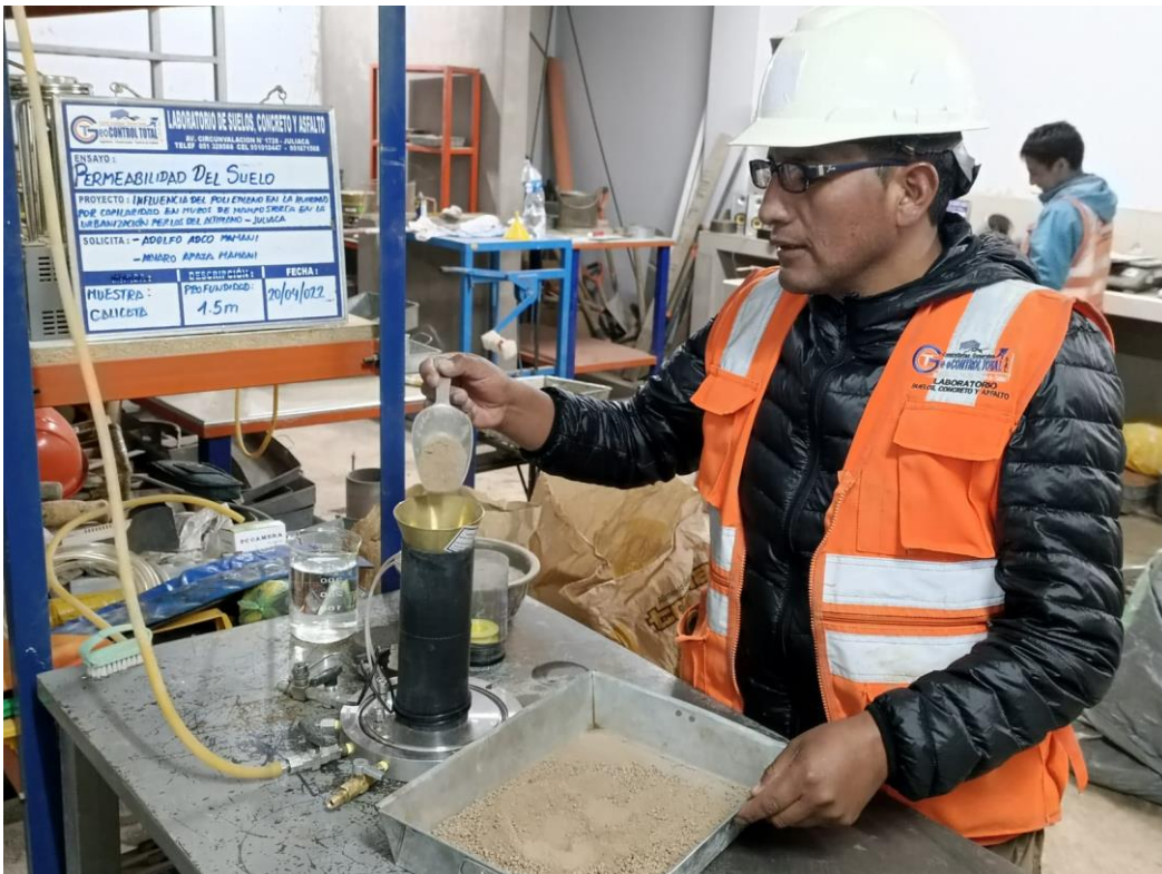
Foto 18: Ensayo de permeabilidad del suelo
