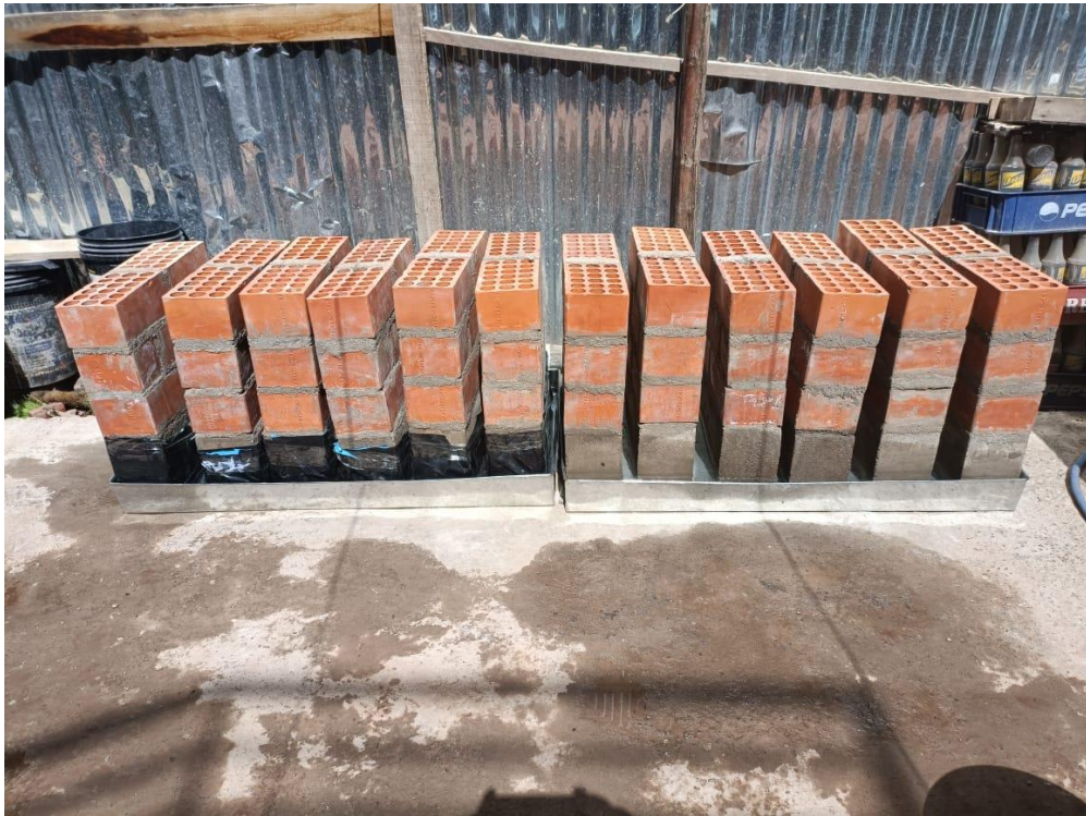
Foto 31: Colocación de muros a escala en bandejas de agua a 5cm
