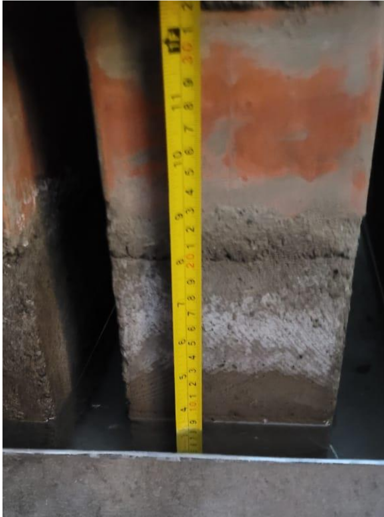
Foto 37:Medicion de las alturas capilares a las 300 horas
