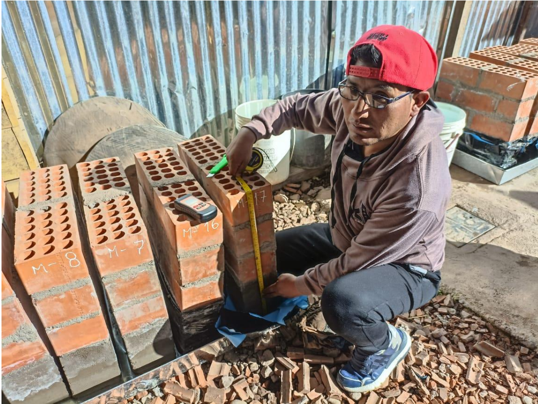
Foto 41:Medicion de las alturas capilares a las 500 horas
