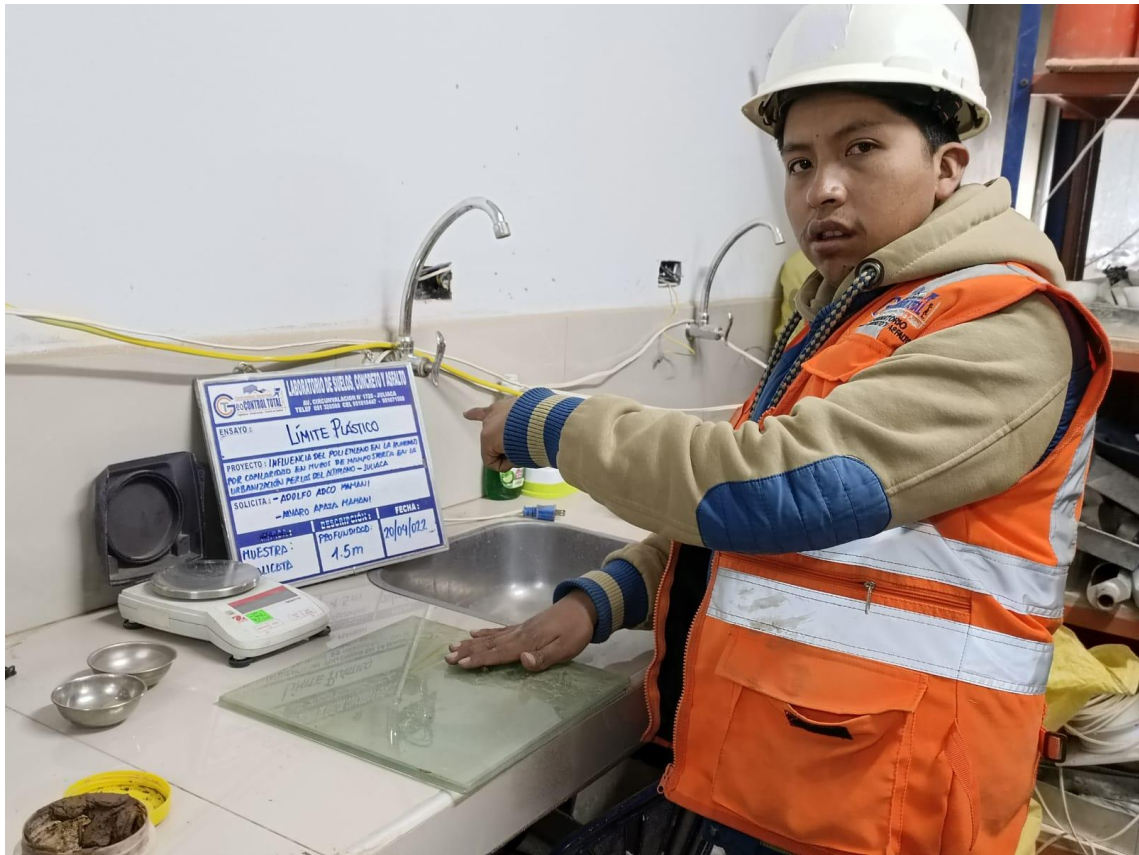
Foto 13: Ensayo de limite plástico
