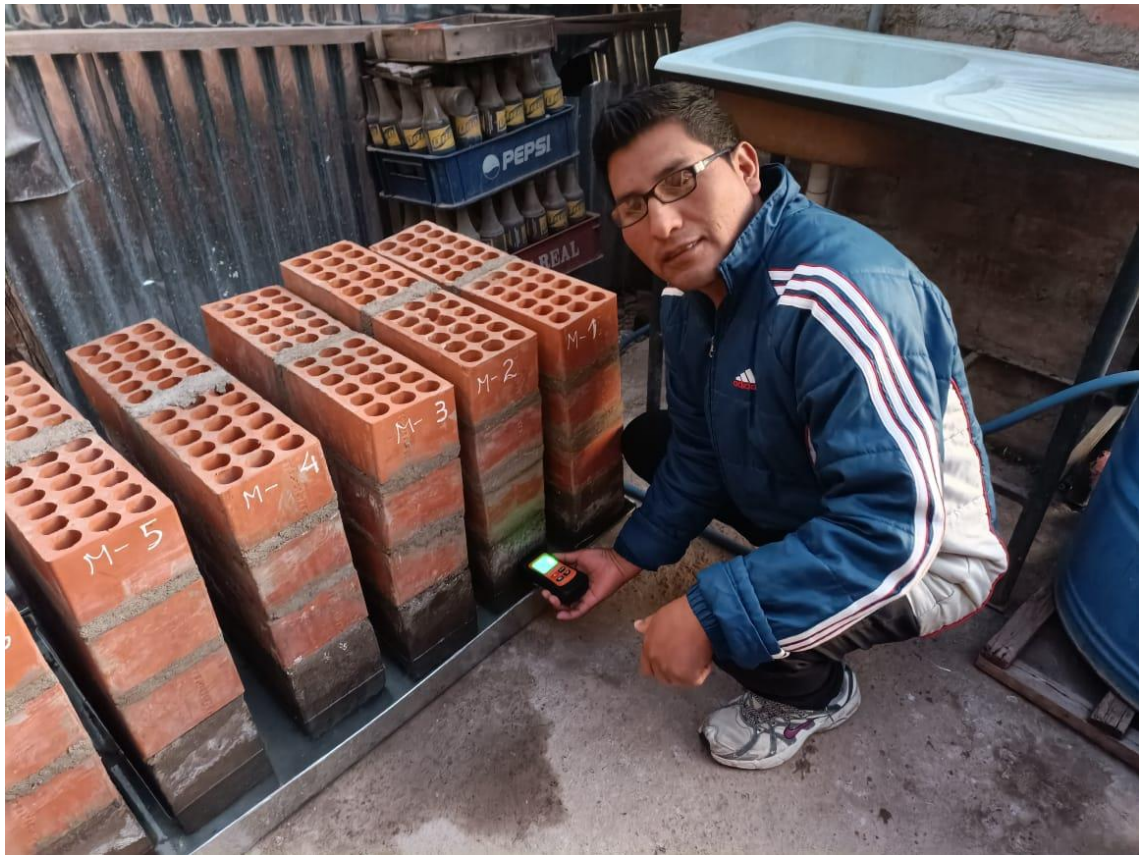
Foto 39: Medición de los porcentajes de humedad a las 300 horas
