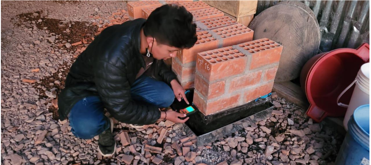
Foto 35: Medición de los porcentajes de humedad a las 100 horas
