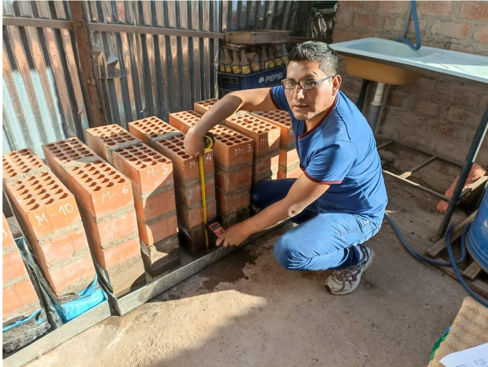
Foto 45: Medición de porcentaje de humedad a las 750 horas
