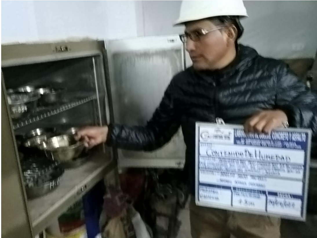
Foto 11: Contenido de Humedad
