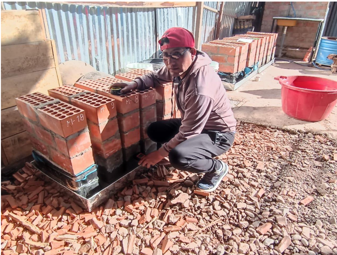
Foto 42:Medicion de los porcentajes de humedad a las 500 horas
