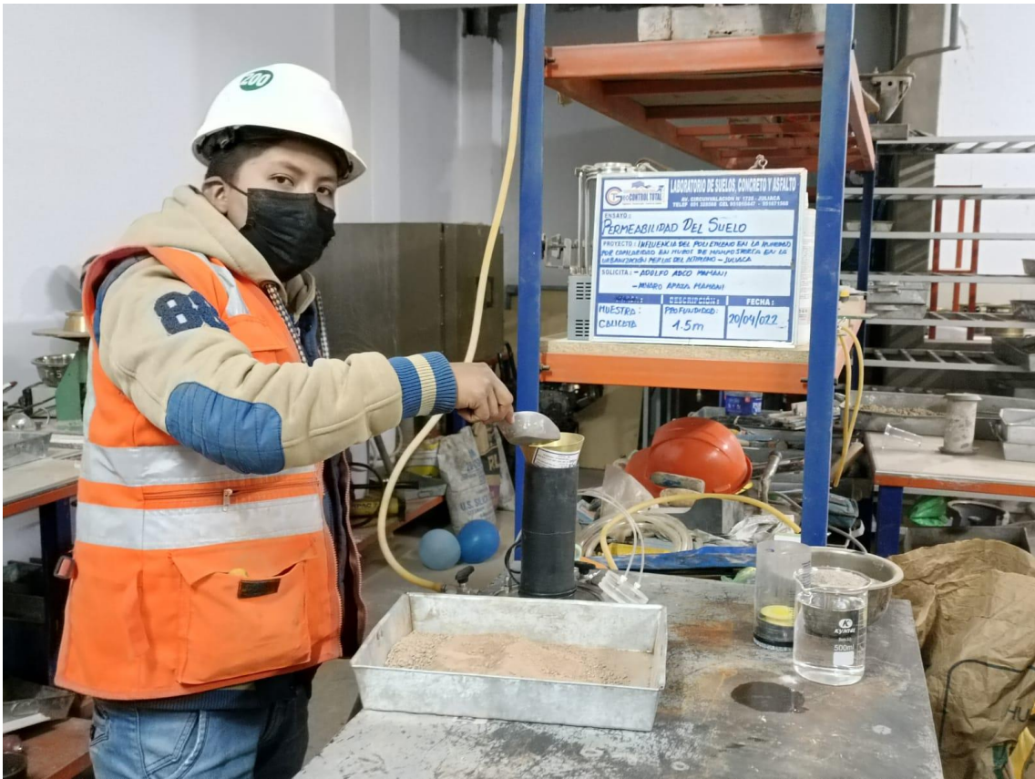
Foto 19: Ensayo de permeabilidad del suelo
