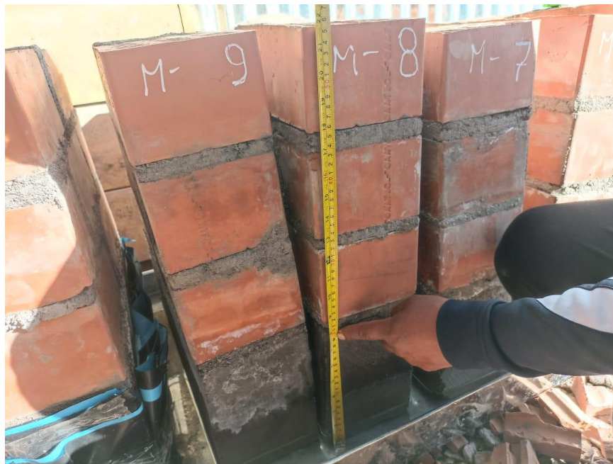
Foto 44: Medicion de las alturas capilares alas 750 horas
