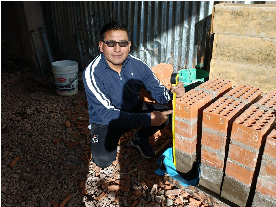
Foto 36: Medición de las alturas capilares a las 300 horas
