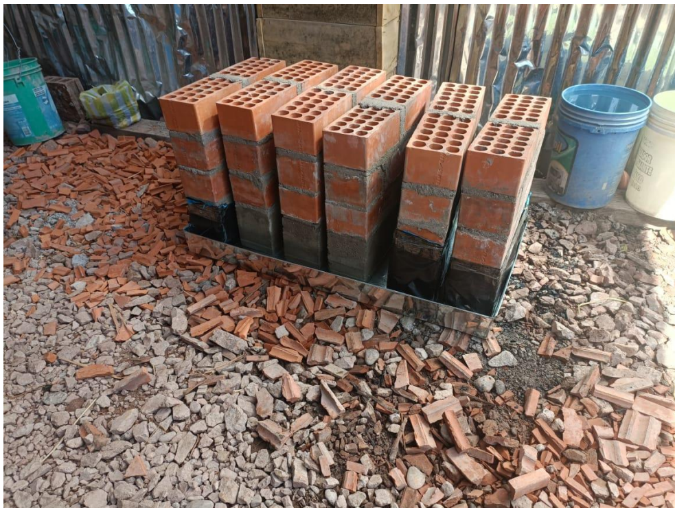
Foto 32: Colocación de muros a escala en bandejas de agua a 5cm
