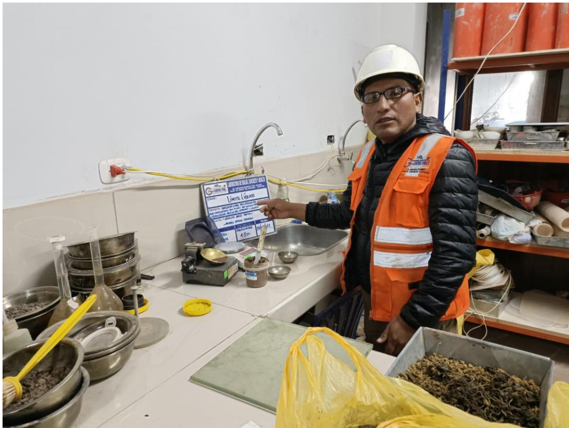
Foto 12: Ensayo de Límite líquido
