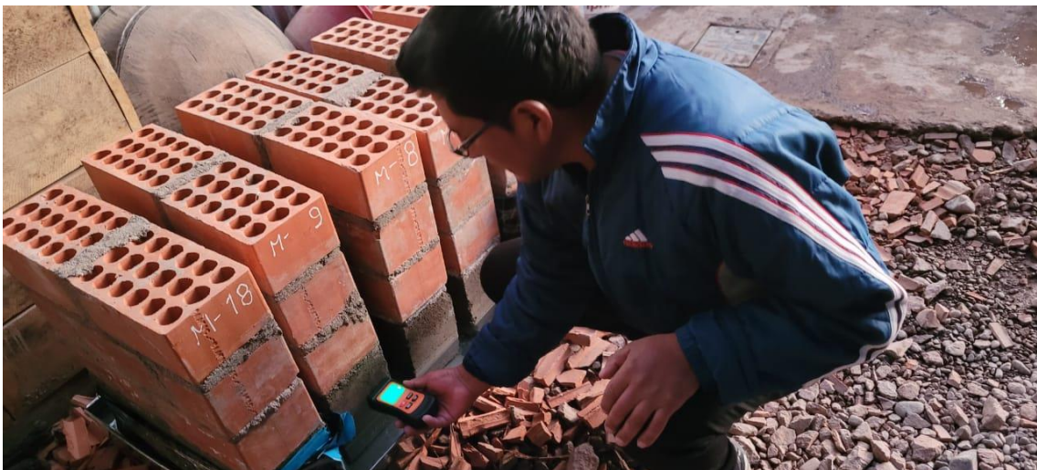
Foto 38:Medicion de los porcentajes de humedad a las 300 horas
