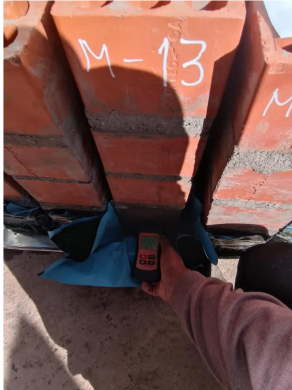
Foto 43: Medicion de los porcentajes de humedad a las 500 horas
