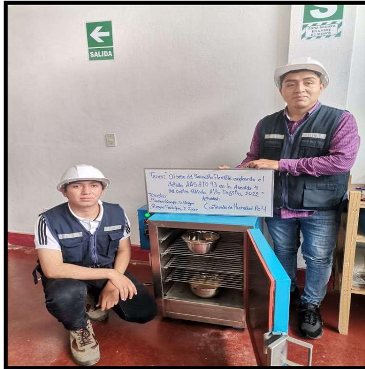
Imagen 9. Realizando el ensayo de contenido de humedad del estrato de la PC 04.
