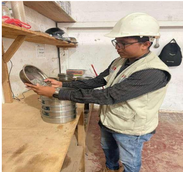
Anexo 32: Realizando el análisis granulométrico mediante el tamizado.
