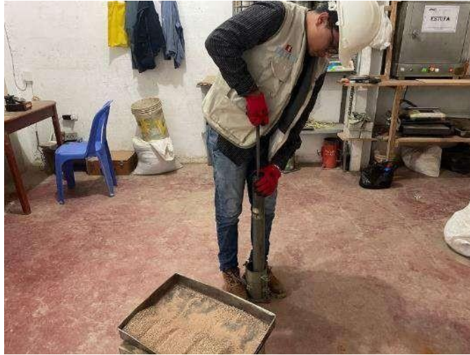
Anexo 35: Realizando el Proctor modificado 6" Ø.
