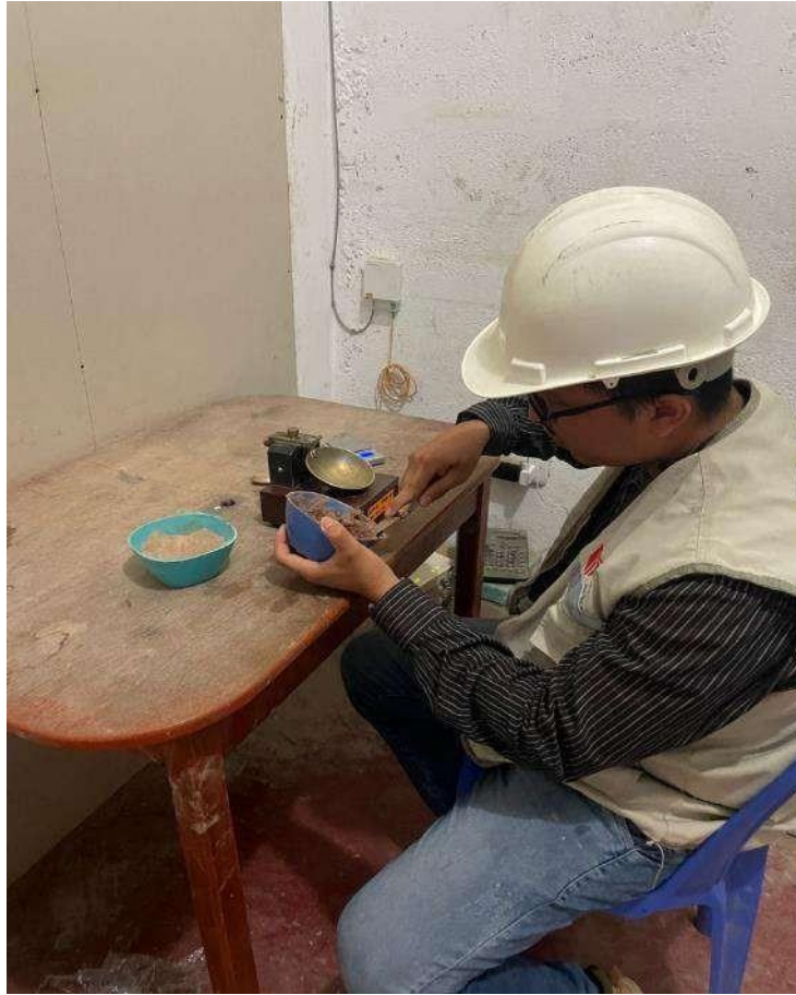
Anexo 33: Realizando el límite líquido a través de la copa Casagrande.
