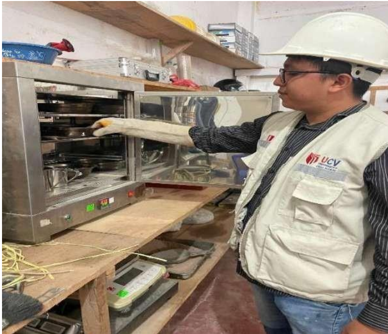
Anexo 31: Realizando el método gravimétrico para calcular la humedad natural del suelo.
