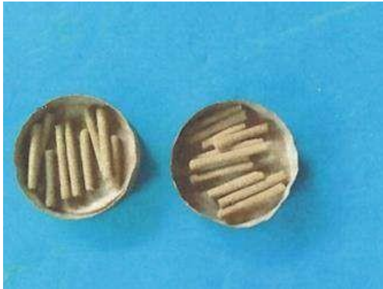
Anexo 34: Límite de consistencia, método del cilindro.
