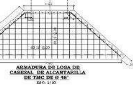
ARMADURA DE LOSA DE CABELAZ DE ALCANTARILLA DE TMC DE Ø 48" ESC: 1/20
