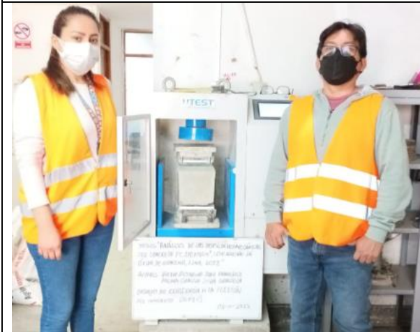
Ensayo para determinar la resistencia a la flexión del concreto
