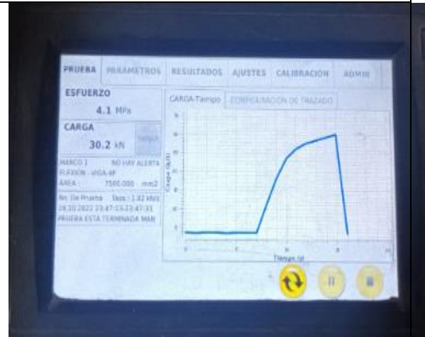
Ensayo para determinar la resistencia a la flexión del concreto
