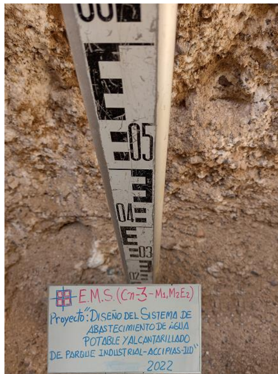
ESTRATO DE LA RPOFUNDIDAD DE EXCAVACION DE CALICATA
