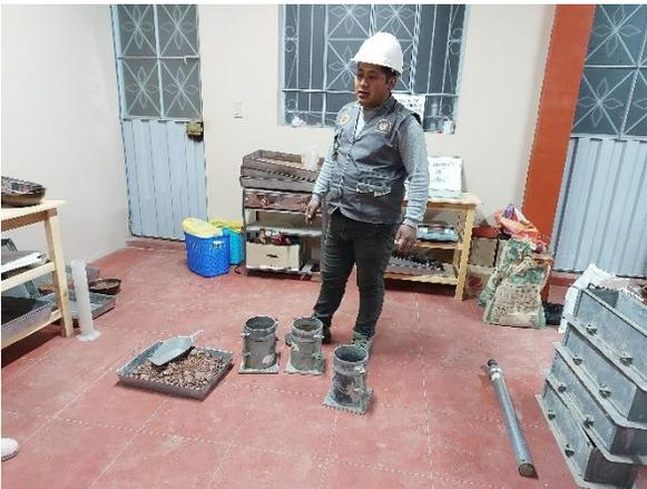
EN 03 MOLDES ENSAYO CBR
