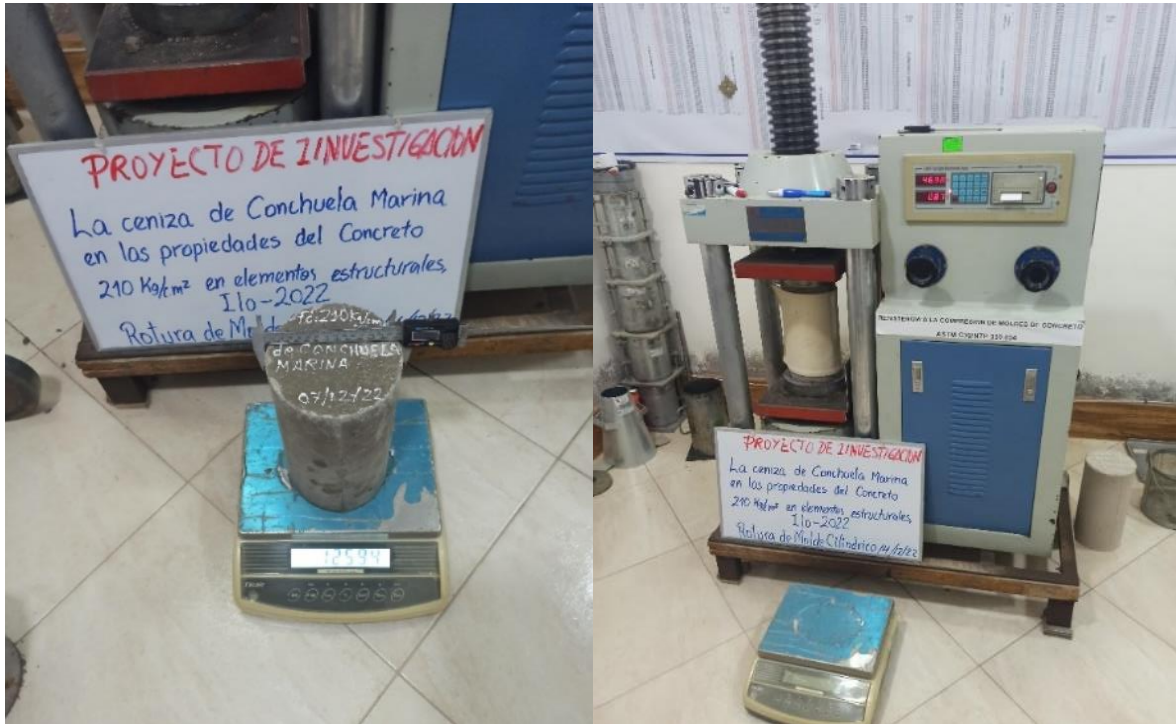
Figura 15. Resistencia a la compresión con ceniza de conchuela marina
