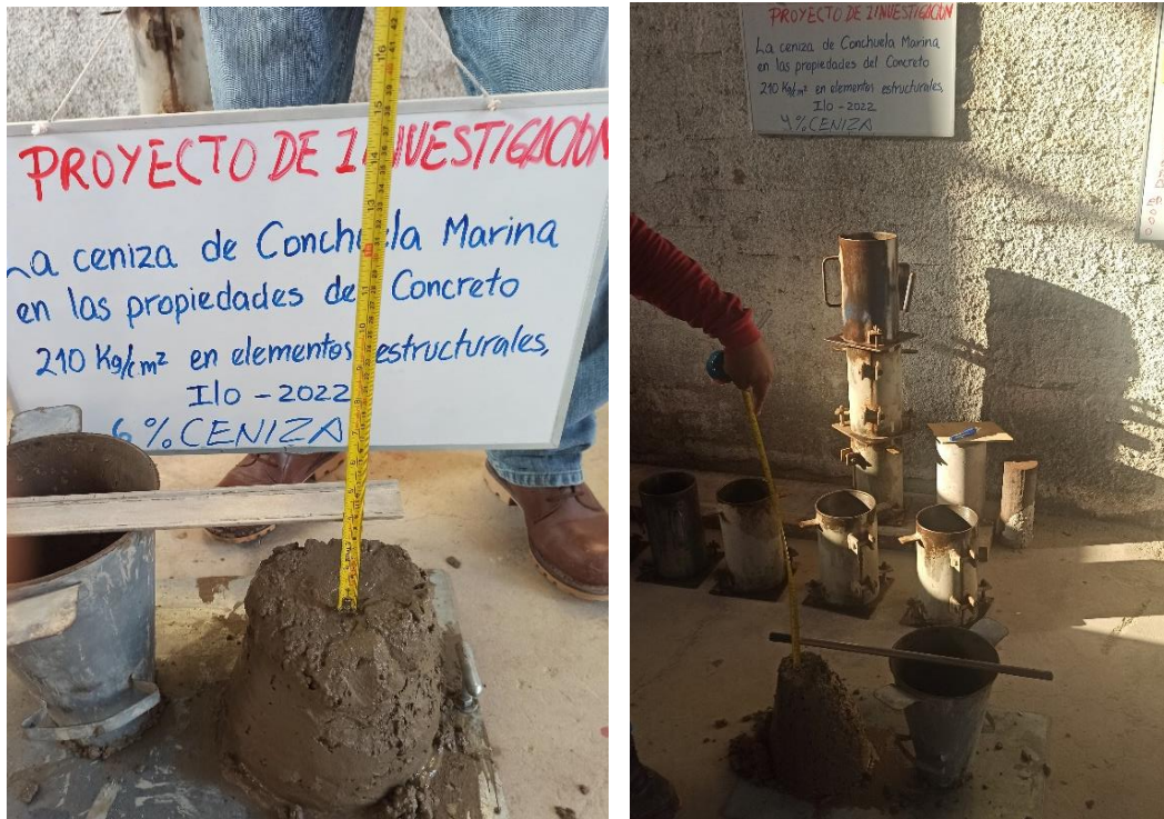
Figura 19. Asentamiento del concreto con ceniza de conchuela marina
