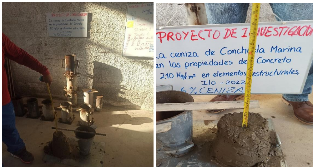
IMAGEN N° 8: Asentamiento del concreto
