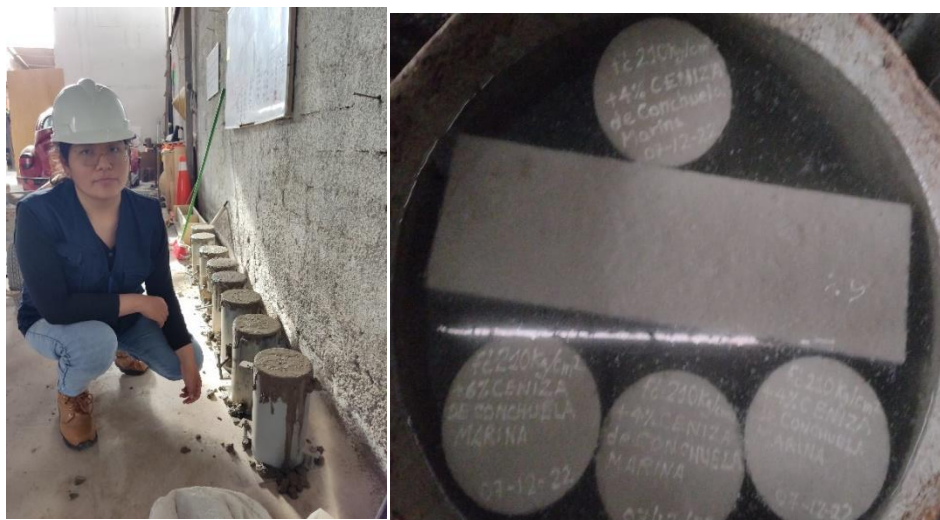
IMAGEN N° 9: Elaboración y curado de briquetas de concreto
