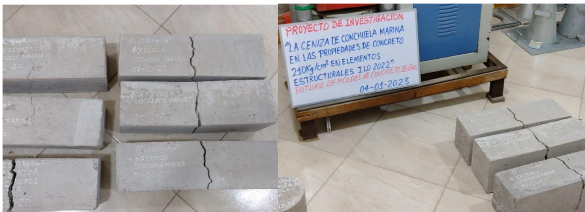
Figura 17. Resistencia a la flexión con ceniza de conchuela marina
