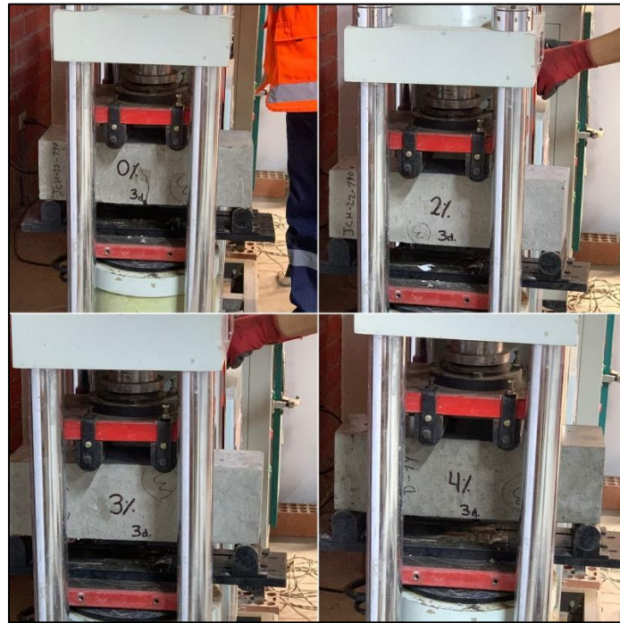
Figura 21. Ensayo de resistencia a la flexión a los 3 días.
