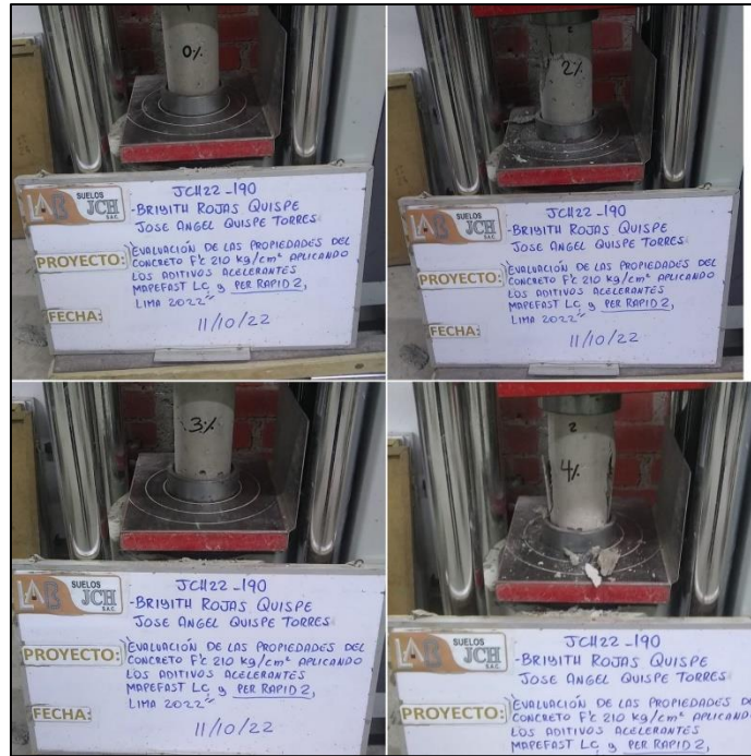
Figura 13. Ensayo de resistencia a la compresión a los 28 días.
