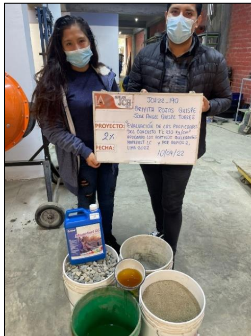
Figura 5. Elaboración de mezcla adicionando 2% de aditivo acelerante
