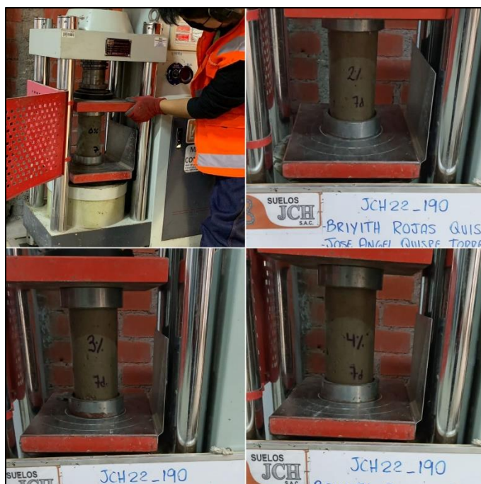
Figura 11. Ensayo de resistencia a la compresión a los 7 días.
