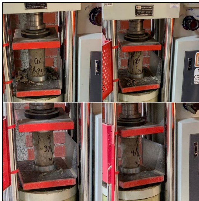
Figura 9. Ensayo de resistencia a la compresión a los 3 días.
