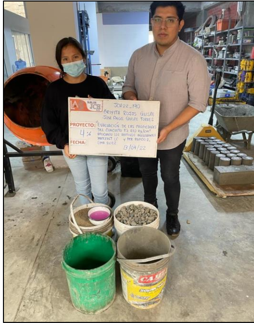
Figura 7. Elaboración de mezcla adicionando 4% de aditivo acelerante.
