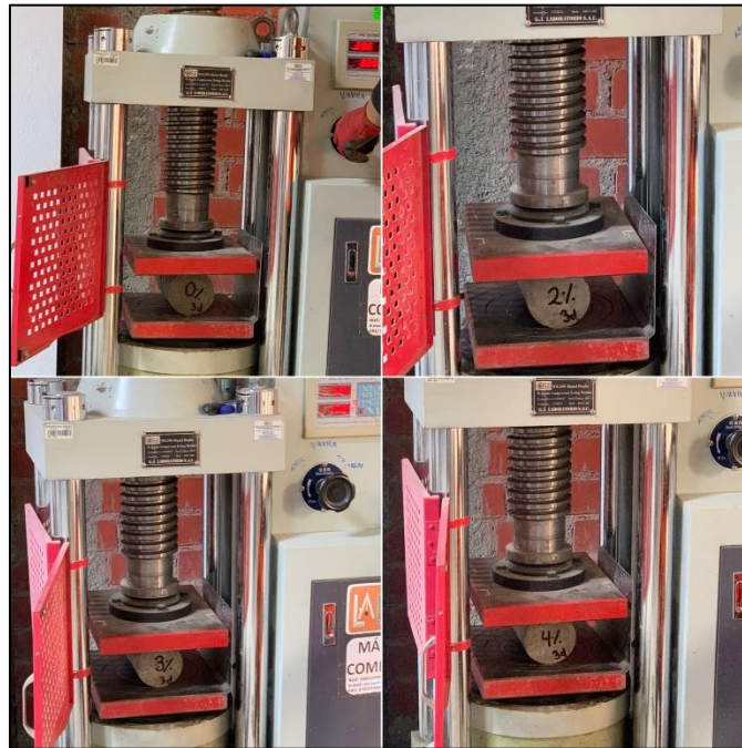
Figura 15. Ensayo de resistencia a la tracción a los 3 días.
