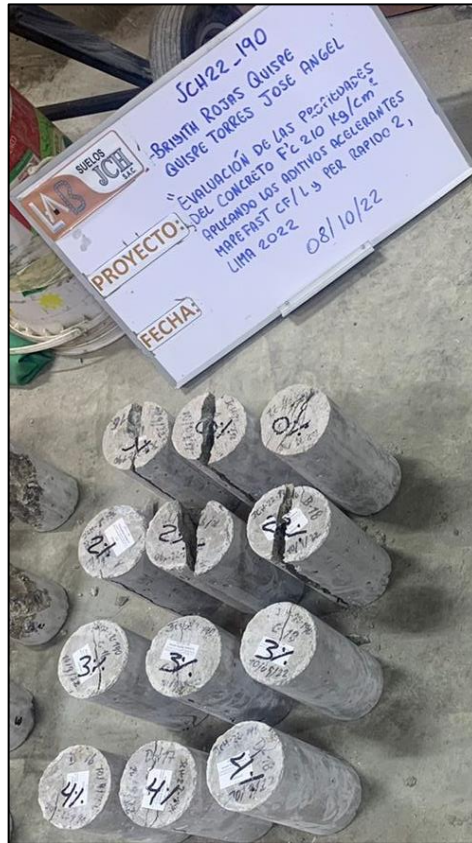
Figura 19. Ensayo de resistencia a la tracción a los 28 días.
