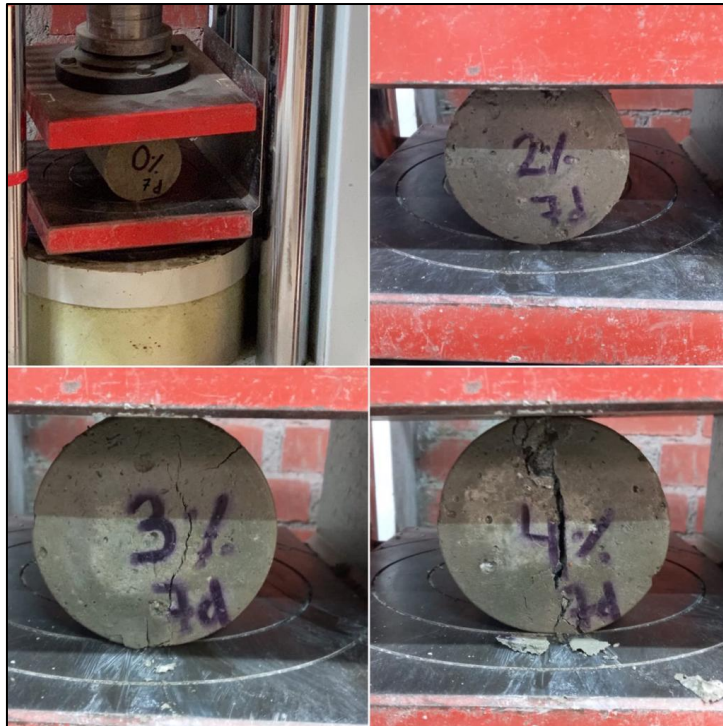
Figura 17. Ensayo de resistencia a la tracción a los 7 días.
