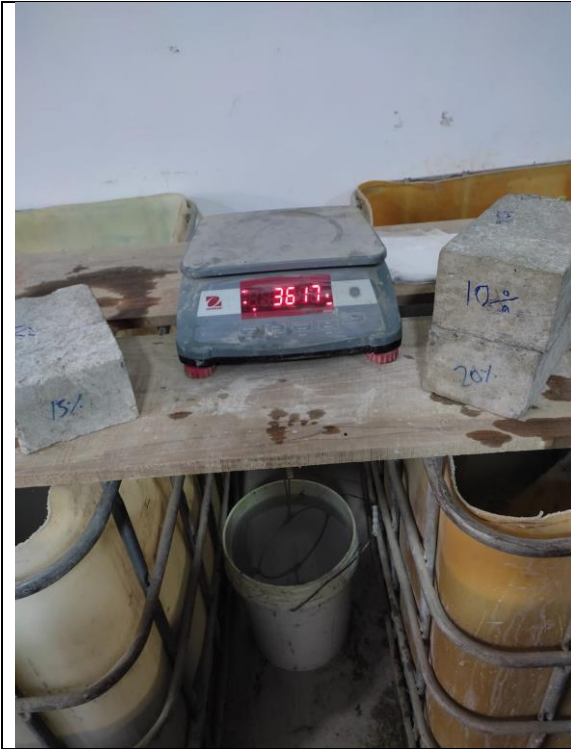
Foto N°21: Ensayo de densidad de la muestra patrón.
