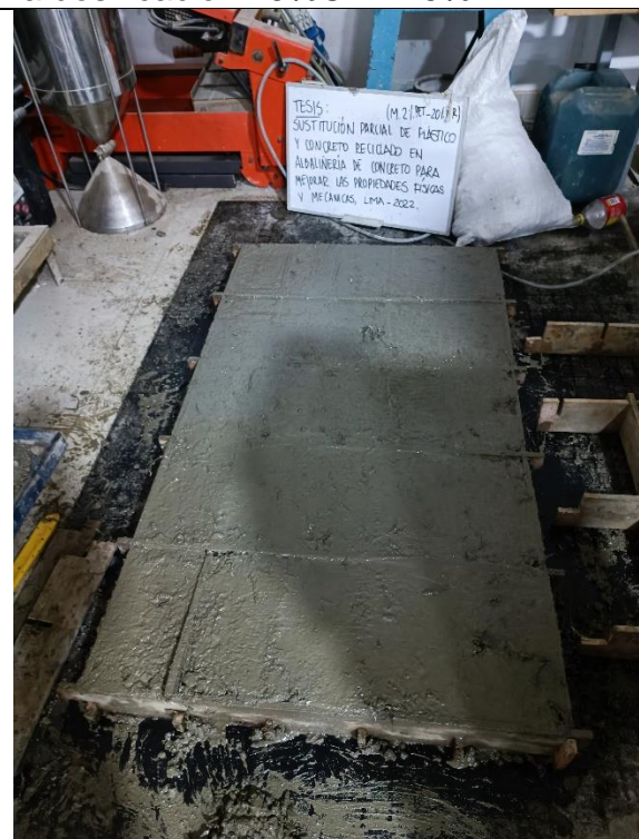
Foto N°16: Vaciado de concreto para la dosificación 20%CR+2.0%PET
