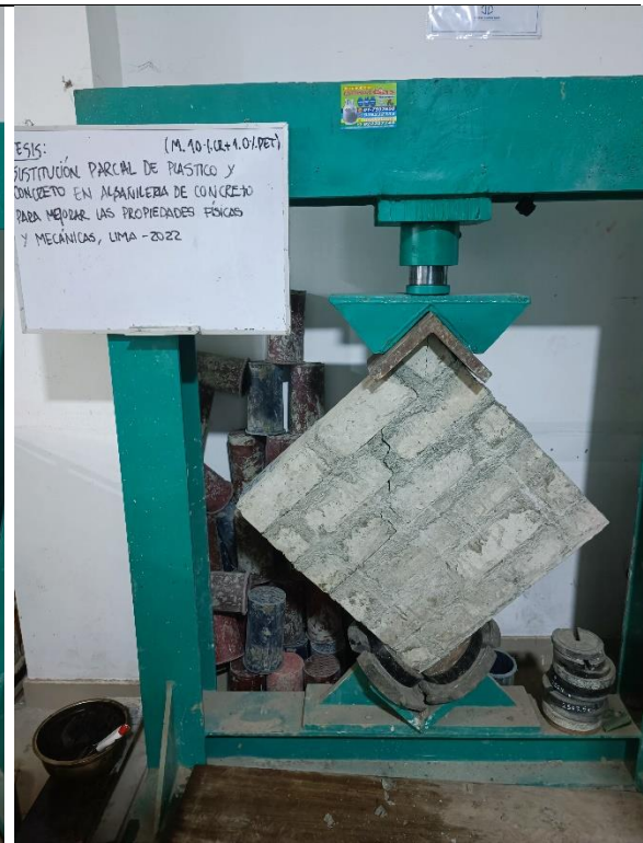
Foto N°34: Ensayo de compresión diagonal de muretes para la dosificación 10%CR+1.0%PET.
