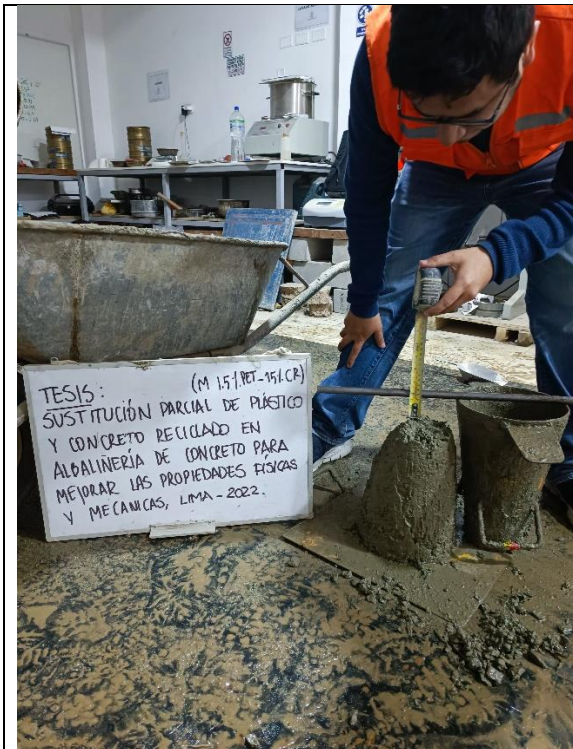
Foto N°13: Ensayo de asentamiento para la dosificación 15%CR+1.5%PET
