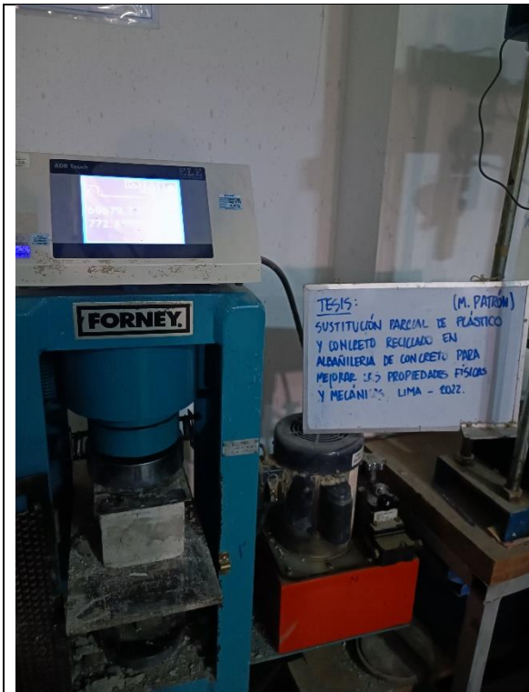
Foto N°25: Ensayo de compresión de la muestra patrón.
