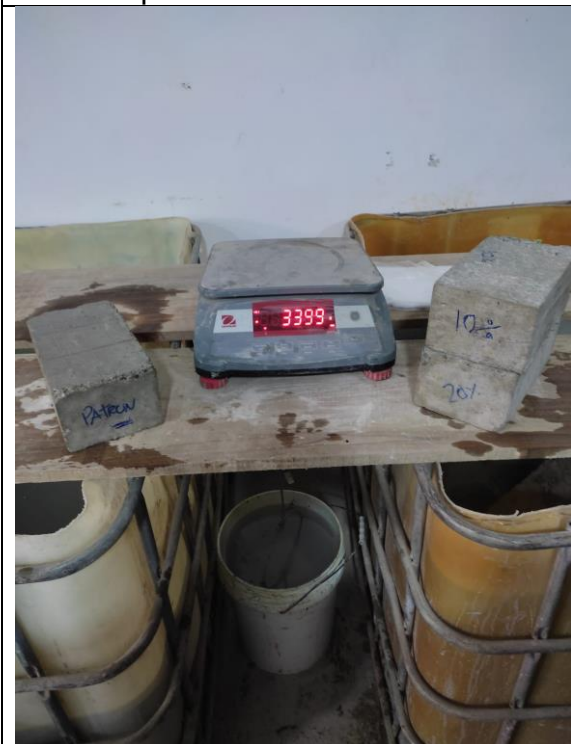
Foto N°23: Ensayo de densidad para la dosificación 15%CR+1.5%PET.
