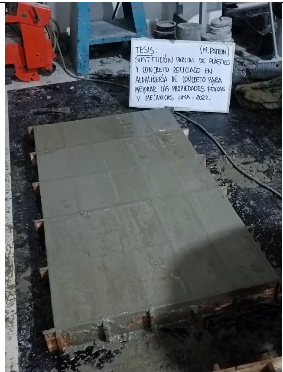
Foto N°10: Vaciado de concreto de la muestra patrón.
