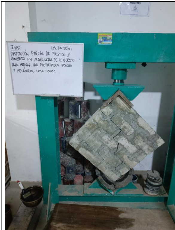
Foto N°33: Ensayo de compresión diagonal de muretes de la muestra patrón.
