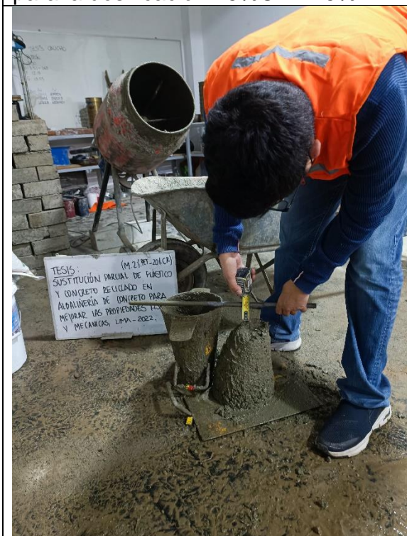
Foto N°15: Ensayo de asentamiento para la dosificación 20%CR+2.0%PET
