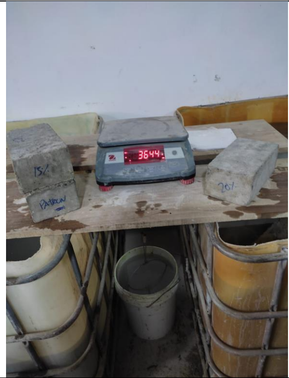
Foto N°22: Ensayo de densidad para la dosificación 10%CR+1.0%PET.
