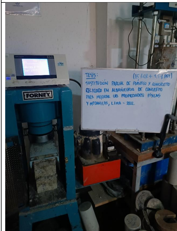
Foto N°31: Ensayo de compresión axial de pilas para la dosificación 15%CR+1.5%PET.
