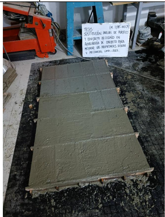
Foto N°12: Vaciado de concreto para la dosificación 10%CR+1.0%PET
