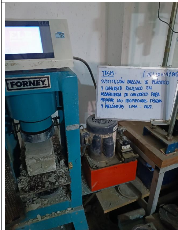
Foto N°27: Ensayo de compresión para la dosificación 15%CR+1.5%PET
