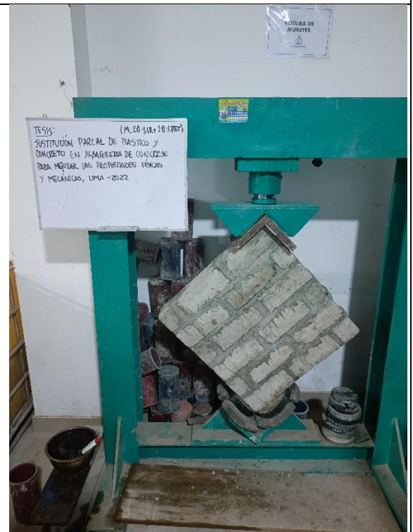
Foto N°36: Ensayo de compresión diagonal de muretes para la dosificación 20%CR+2.0%PET.
