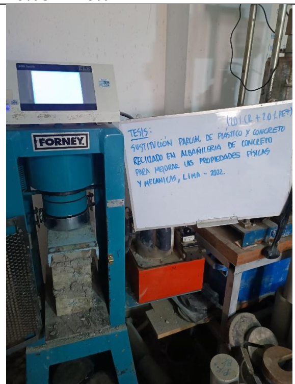
Foto N°32: Ensayo de compresión axial de pilas para la dosificación 20%CR+2.0%PET.
