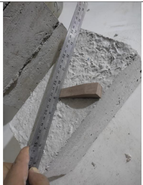
Foto N°20: Ensayo de alabeo para la dosificación 20%CR+2.0%PET.
