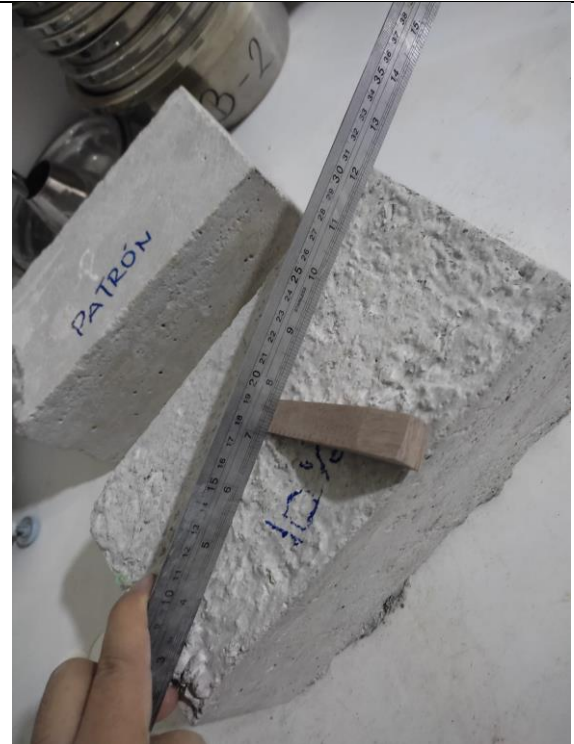
Foto N°18: Ensayo de alabeo para la dosificación 10%CR+1.0%PET.
