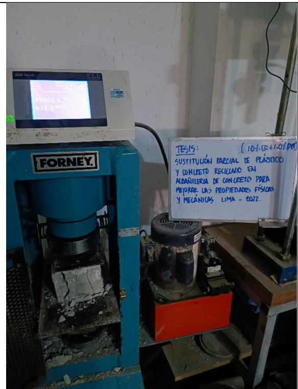
Foto N°26: Ensayo de compresión para la dosificación 10%CR+1.0%PET.
