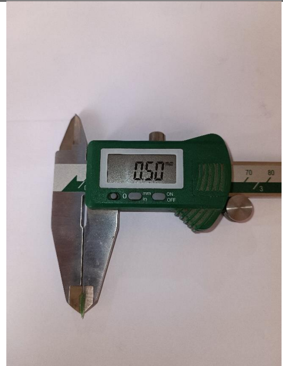
Foto N°06: Medida de la dimensión espesor de la muestra de plástico PET reciclado
