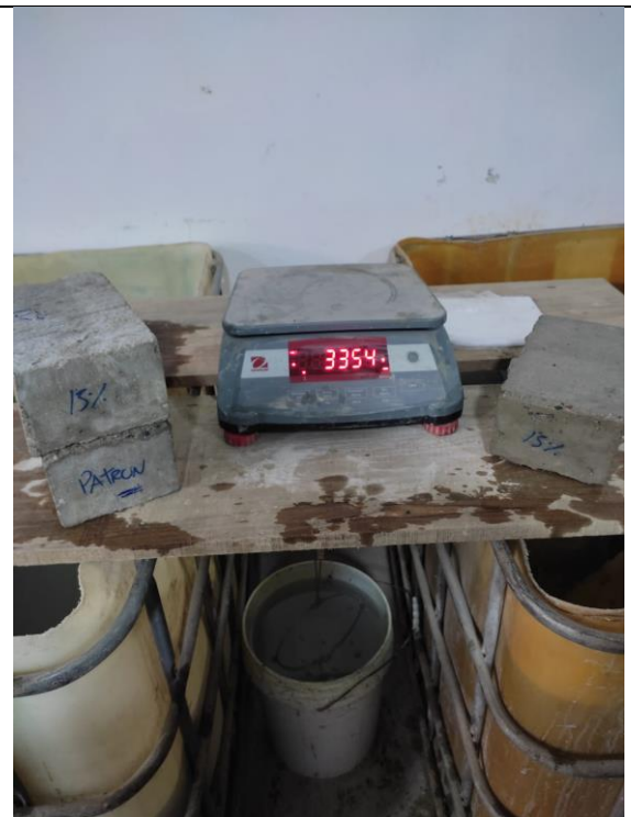
Foto N°24: Ensayo de densidad para la dosificación 20%CR+2.0%PET.
