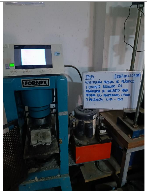
Foto N°28: Ensayo de compresión para la dosificación 20%CR+2.0%PET.
