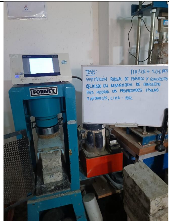
Foto N°30: Ensayo de compresión axial de pilas para la dosificación 10%CR+1.0%PET.
