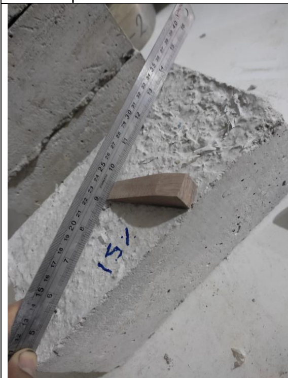
Foto N°19: Ensayo de alabeo para la dosificación 15%CR+1.5%PET.
