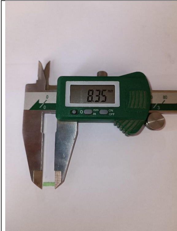
Foto N°05: Medida de la dimensión largo de la muestra de plástico PET reciclado
