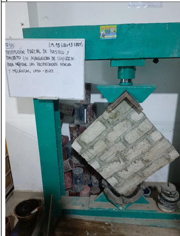
Foto N°35: Ensayo de compresión diagonal de muretes para la dosificación 15%CR+1.5%PET.
