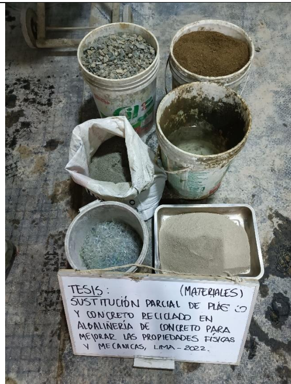
Foto N°07: Materiales utilizados en la dosificación con reemplazo de plástico y concreto reciclado.
