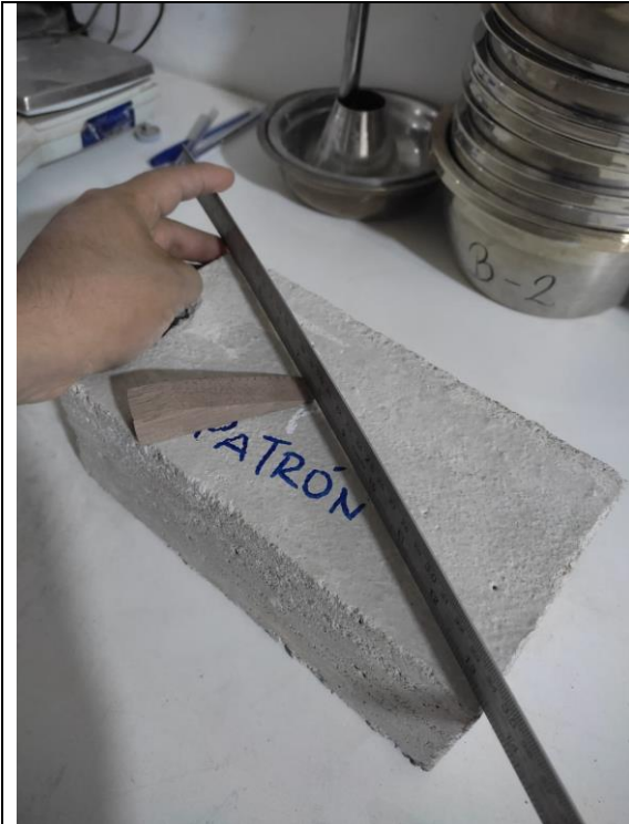
Foto N°17: Ensayo de alabeo de la muestra patrón.
