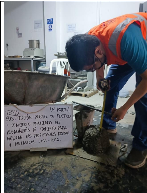
Foto N°09: Ensayo de asentamiento para la de la muestra patrón.
