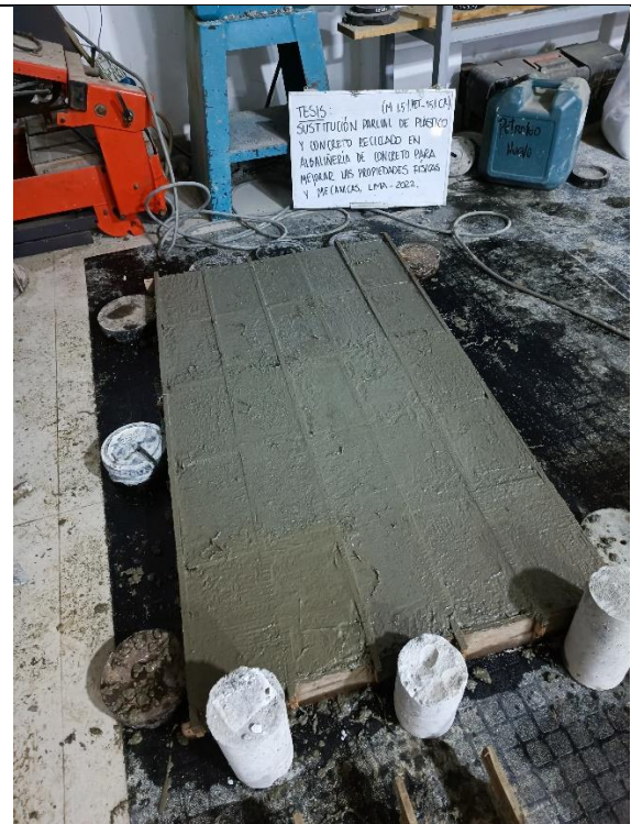
Foto N°14: Vaciado de concreto para la dosificación 15%CR+1.5%PET
