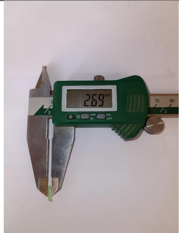
Foto N°04: Medida de la dimensión ancho de la muestra de plástico PET reciclado
