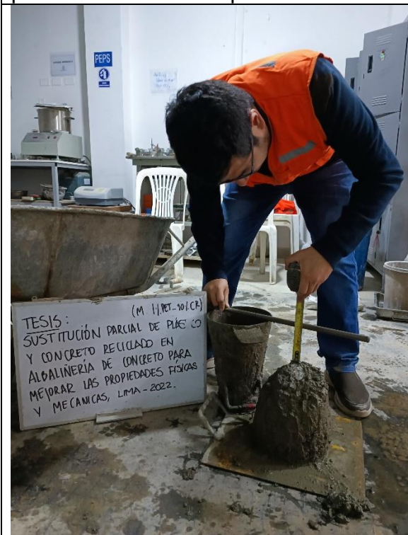
Foto N°11: Ensayo de asentamiento para la dosificación 10%CR+1.0%PET
