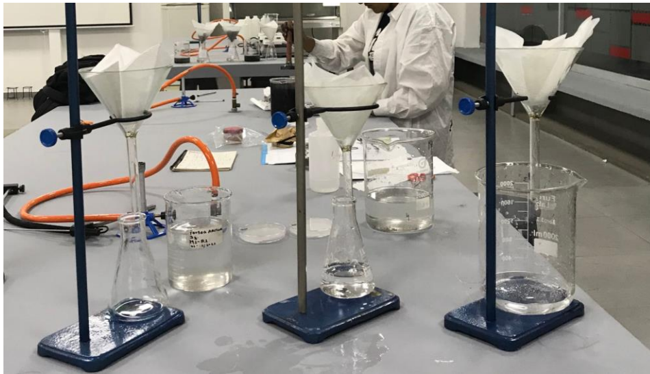
Figura 11: Ejecución de filtración por gravimetría
