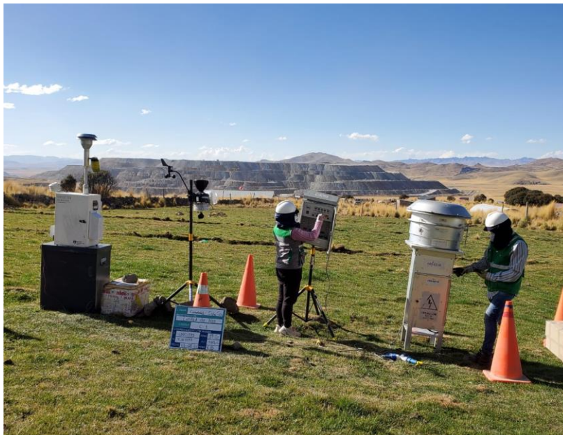
Figura 11.- Instalación de equipo de monitoreo
