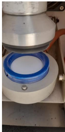
Figura 7.- Colocación de portafiltro de Low-Vol
