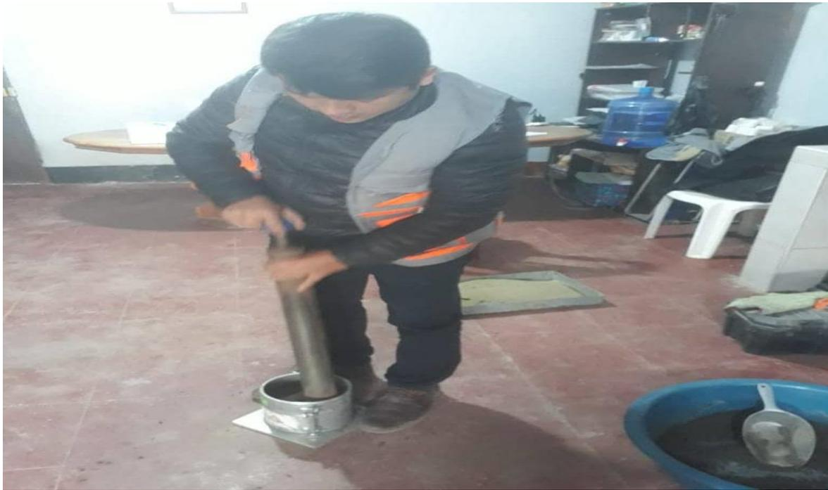
Figura 25. Se realiza el ensayo por el metodo A, en 5 capas y con 25 golpes para determinara la humedad optima
