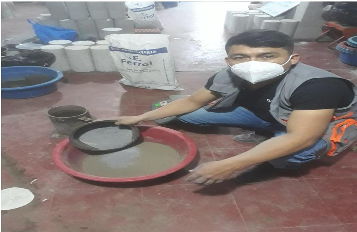
Figura 26. Se adiciona la ceniza de cascara de arroz y se procede con el ensayo del CBR
