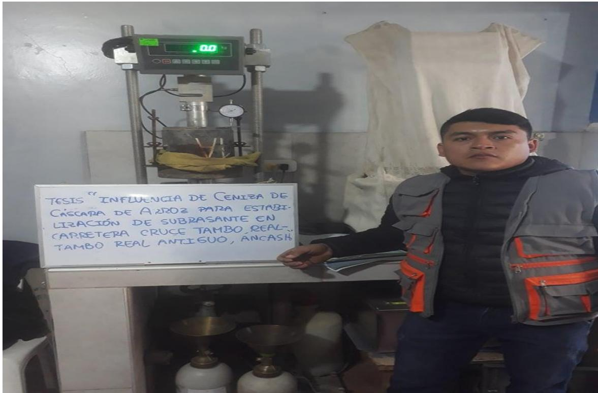
Figura 31. Se realiza el ensayo de penetración para calcular la resistencia del suelo.
