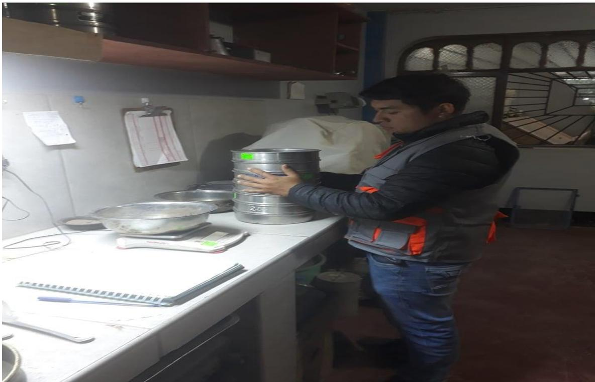
Figura 18. Se procede al tamizado empezando desde el tamiz N° 2" hasta el tamiz N°4, para obtener el peso de la grava.
