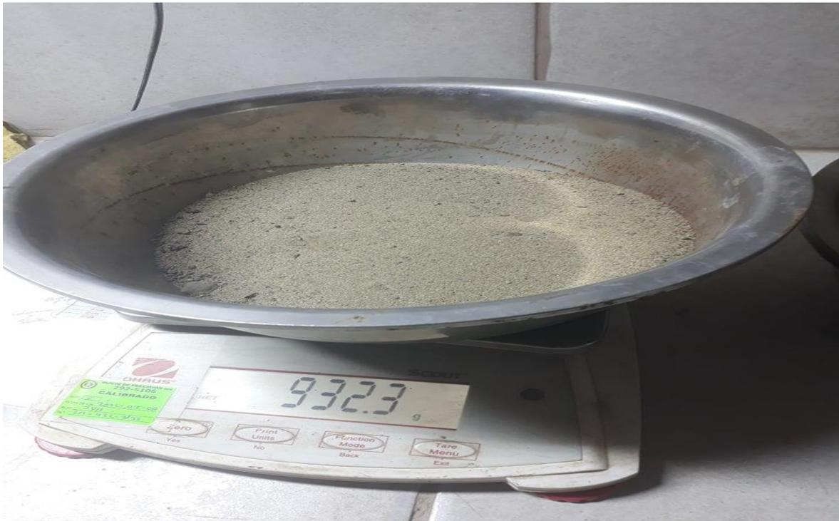
Figura 17. Se pesa la muestra aproximadamente 1 kilogramo para el tamizado
