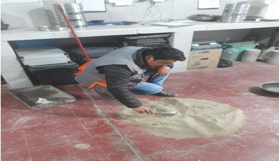
*Figura 15.* Se realizo el cuarteo para obtener una muestra homogenea.
