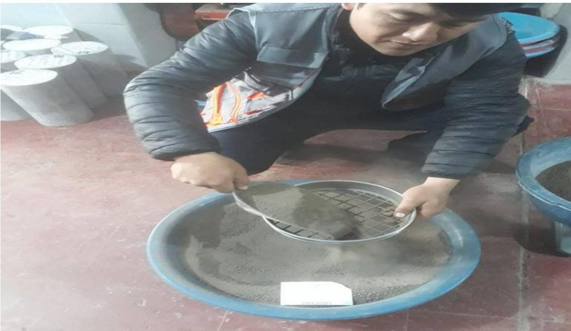
*Figura 22.* Se tamiza por la malla n°4 para realizar el ensayo del Proctor Modificado.
