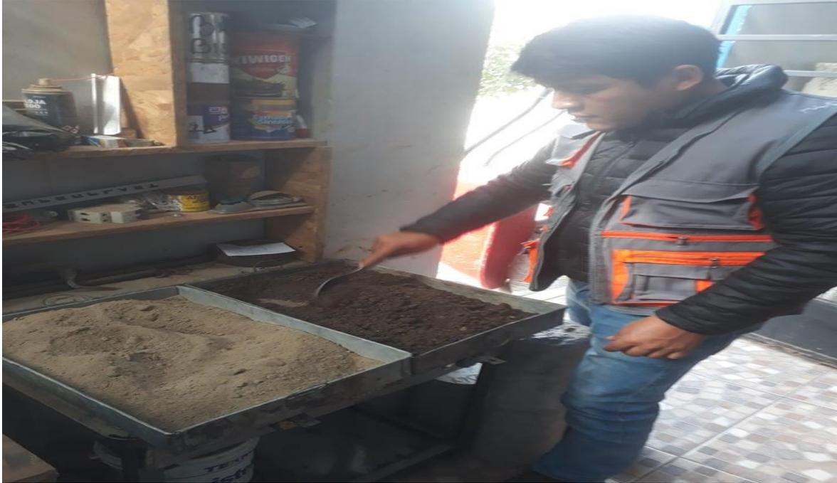
*Figura 13.* Se realiza el secado del material para ser tamizado posteriormente.
