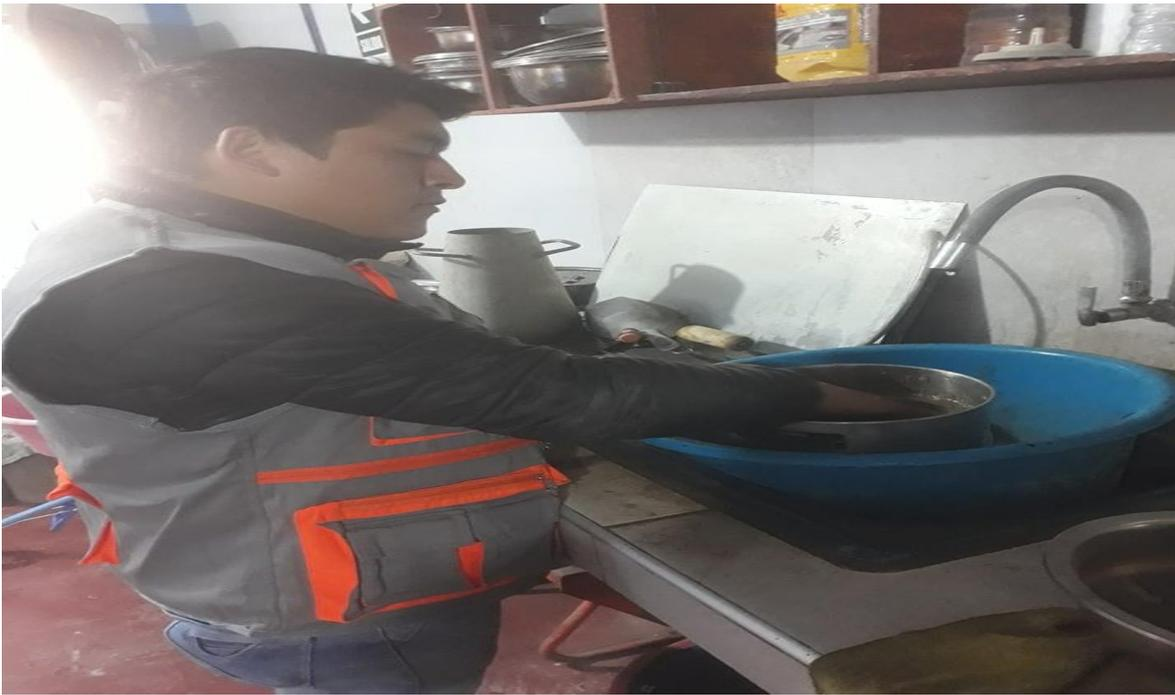
*Figura 19.* Se procede al lavado de la muestra, lo pasante del tamiz n°4, para eliminara los limos y arcillas.
