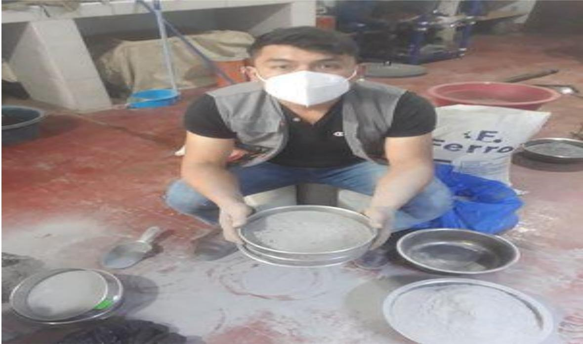
*Figura 11.* Se realizo el tamizado de la ceniza por la malla n°100 para eliminar parte de la cascarilla que no fue quemado en su totalidad.
