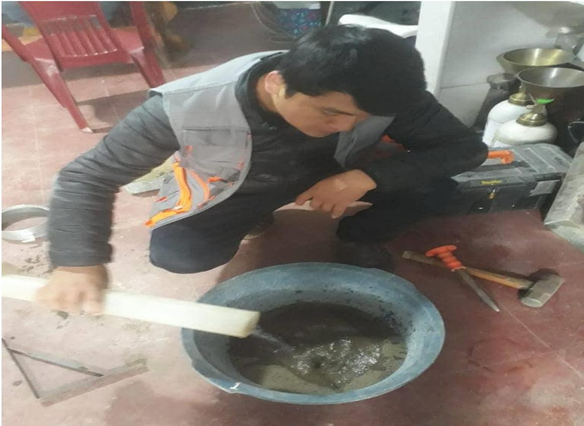
Figura 24. Se agrega un porcentaje de agua con respecto al peso del suelo
