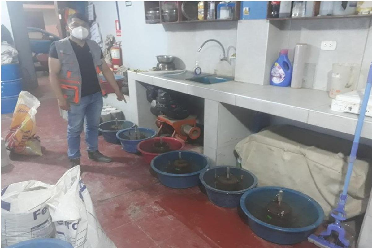
Figura 29. Se deja saturar los moldes por 4 días, para realizar el ensayo de penetración
