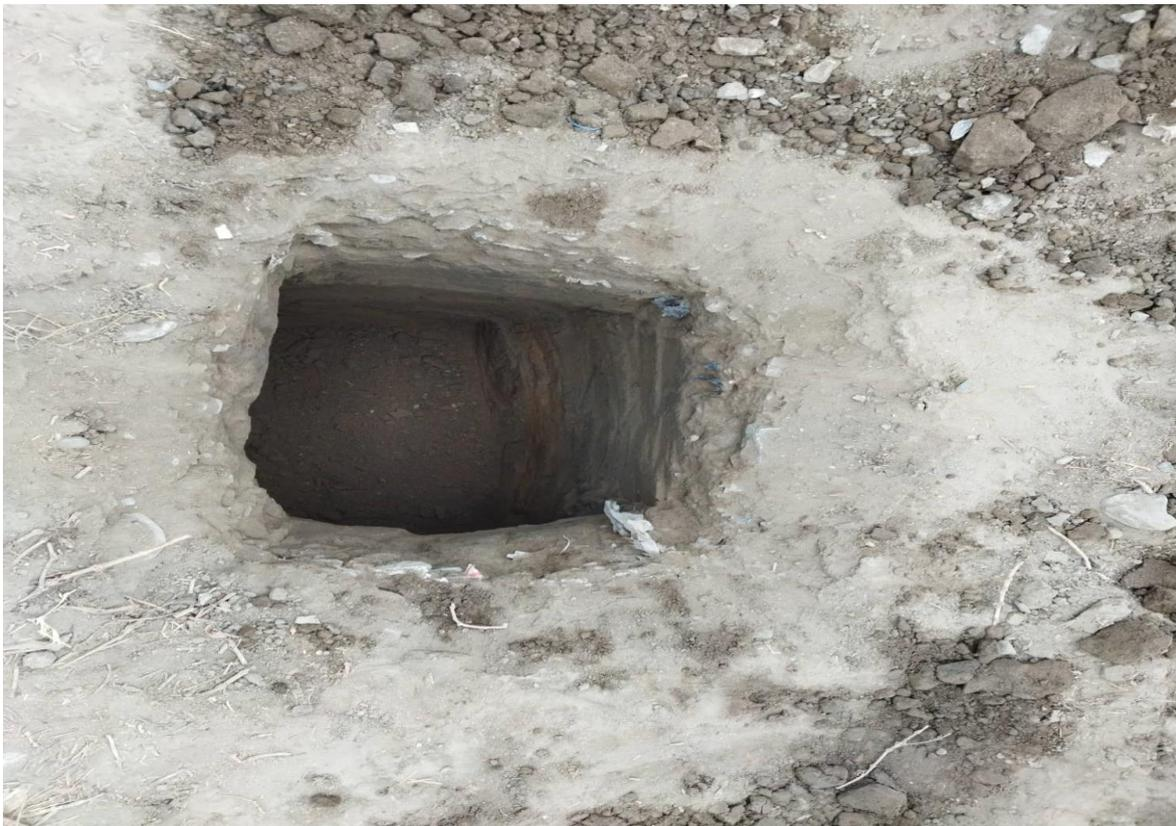
Figura 4. Estracion de la muestra a una profundidad 1.5 m
