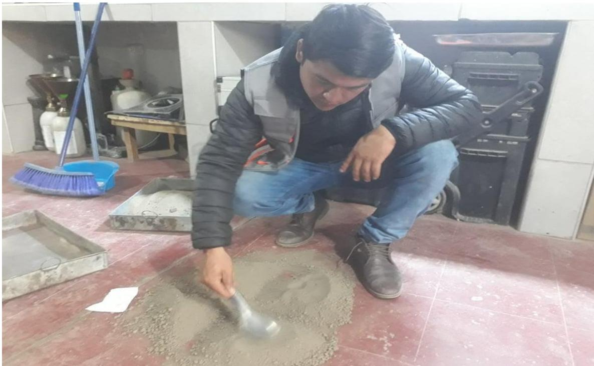
*Figura 16.* Se recoge un cuarto de la muestra para ser tamizado.
