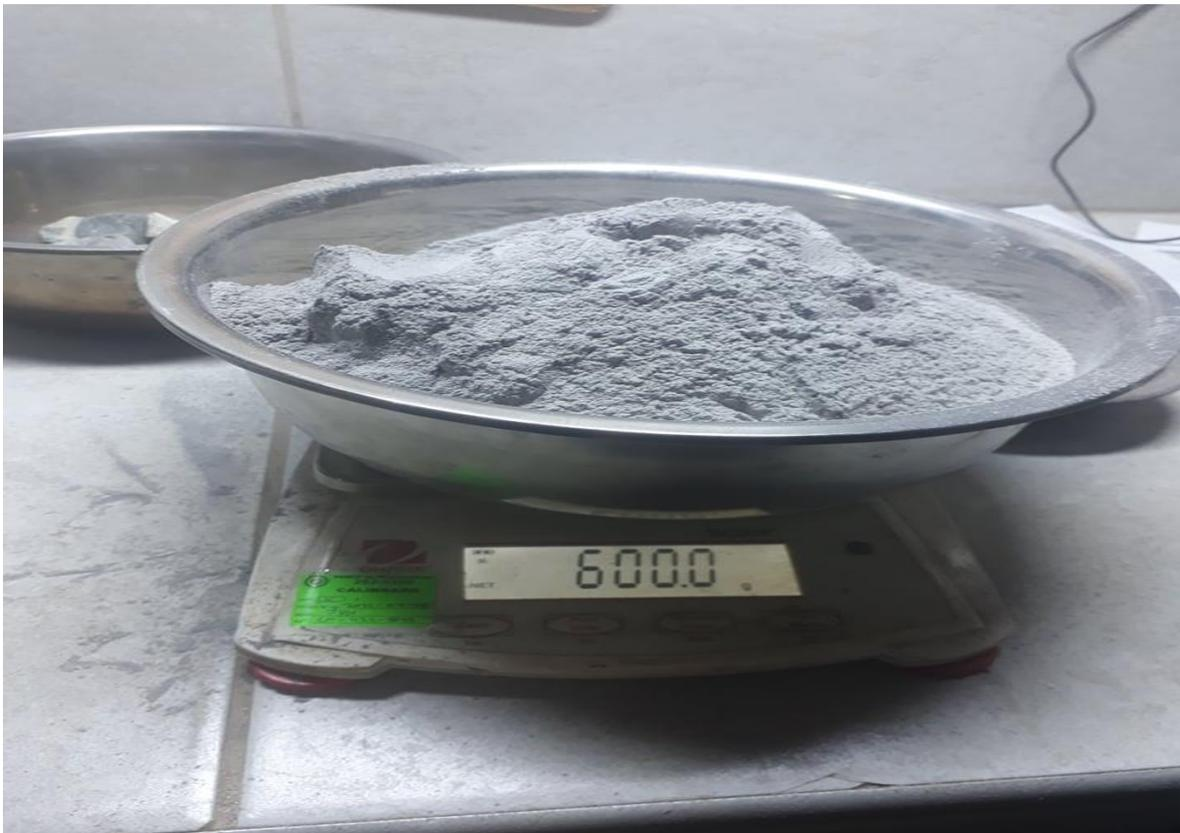
*Figura 12.* Se pesa la ceniza para ser adicionado al 3%, 7% y 10% con respecto al peso del seulo
