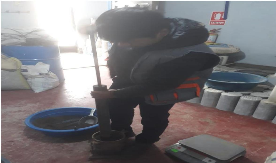
Figura 28. Se procede a la compactación con el pisón a una altura de 18 puig, en 10, 25 y 56 golpes por cada porcentaje de adición.
