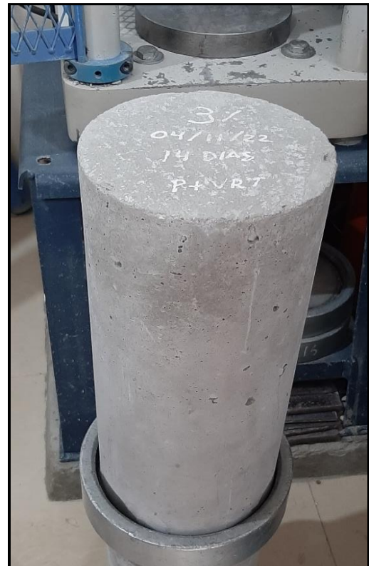
Foto 57: Falla Tipo N.F (No se llegó a fracturar).
