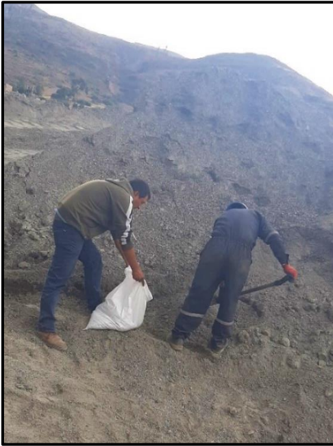
Foto 01: Extracción del agregado grueso de la cantera de Tacllan
