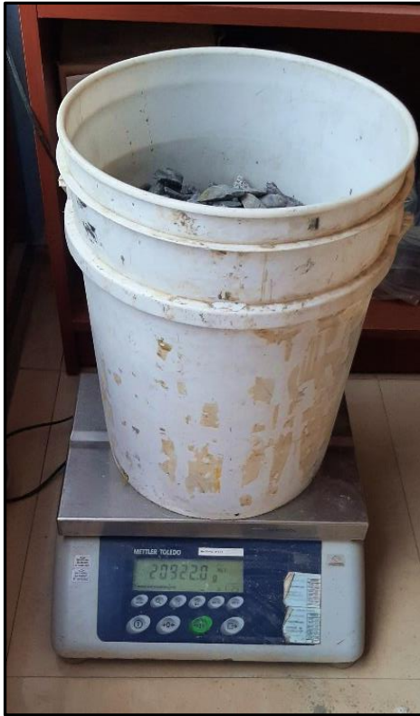
Foto 24: Dosificación del Agregado Grueso
