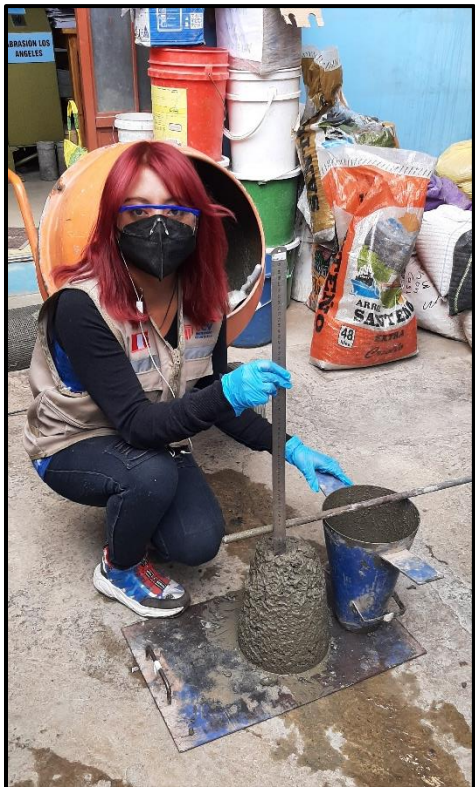
Foto 33: Ensayo de Asentamiento (Slump) del concreto con adición de vidrio.
