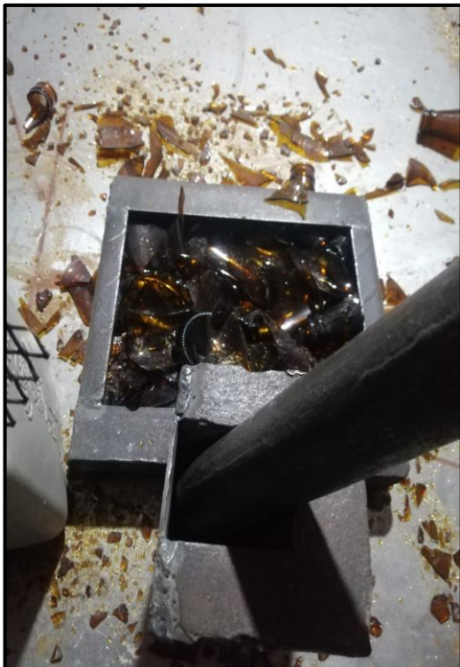
Foto 14: Trituración del vidrio en la moledora
