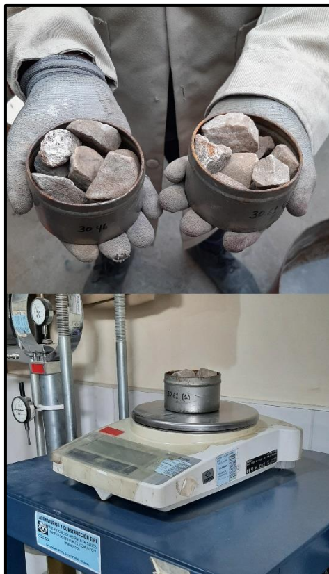
Foto 20: Contenido de humedad de los agregados.
