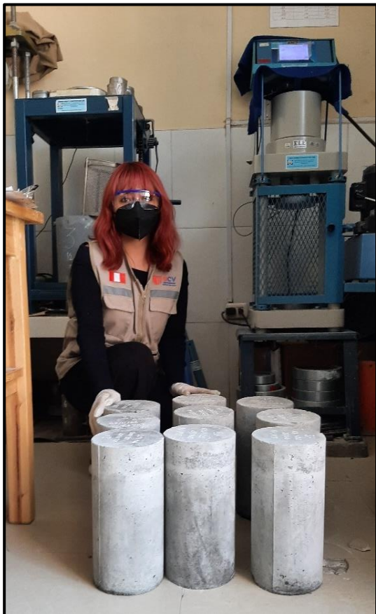
Foto 40: Probetas listas para el ensayo de rotura.
