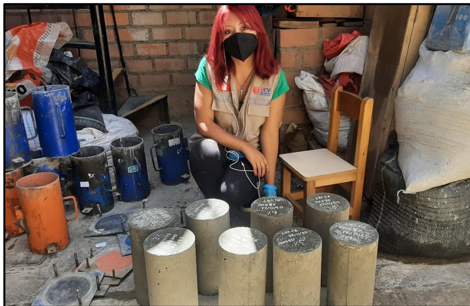
Foto 36: Desencofrado de probetas.
