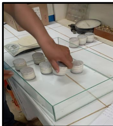
Figura 12: Colocación de probetas en el molde para calcular la absorción.
