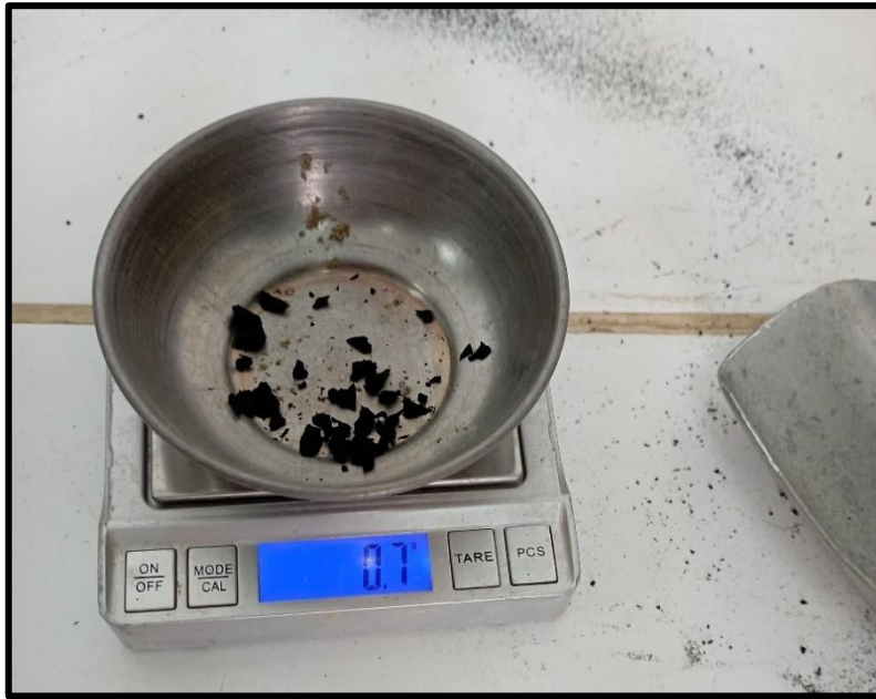
Figura 32: Peso de captura de material en los tamices.
