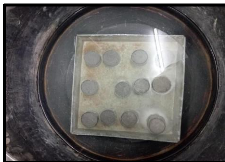
Figura 9: Probetas siendo curadas para prueba de absorción de agua.
