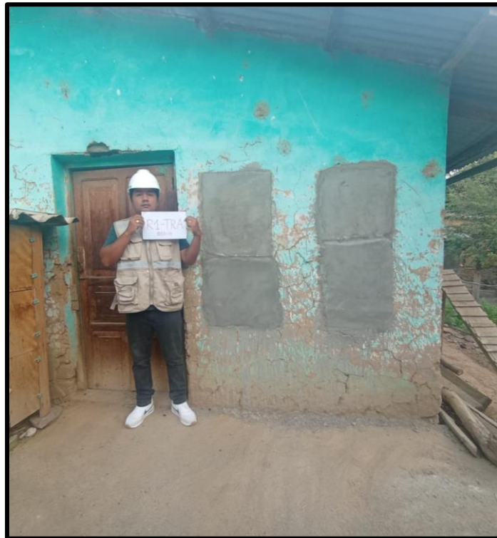
Figura 51: Resultados de prueba de retracción a los 7 días.
