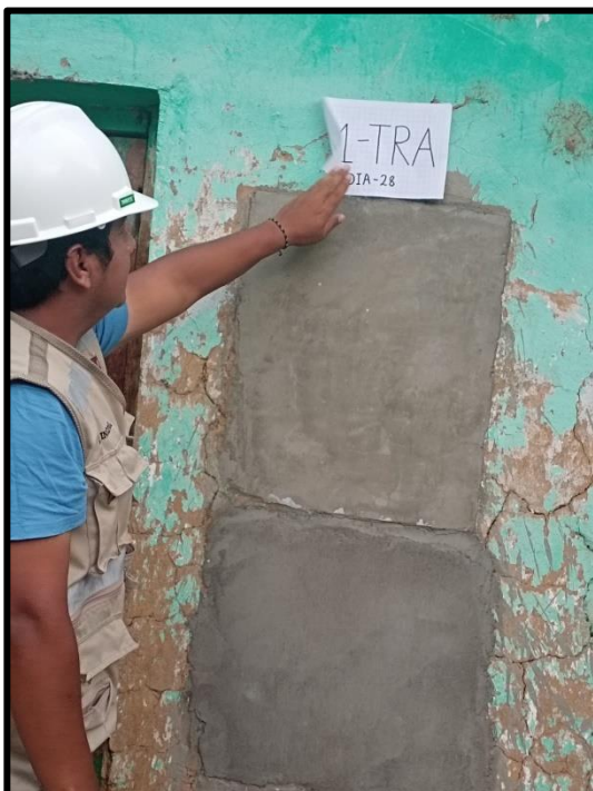
Figura 52: Resultados de prueba de retracción a los 28 días.
