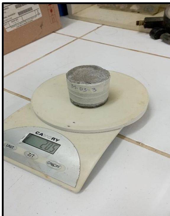
Figura 47: Pesado de probetas para prueba de absorción de agua.
