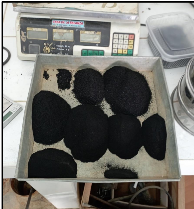
Figura 33: Resultado de material retenido en prueba granulométrica.
