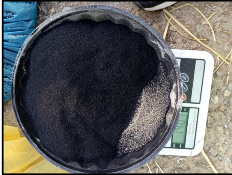
Figura 48: Pesado de material para prueba de retracción.
