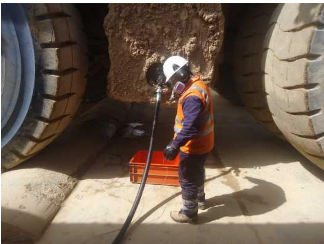
3. Se observa un acto sub estándar por parte del abastecedor de combustible, ya que el conductor está descendiendo del equipo y ya se está realizando el abastecimiento del combustible.
