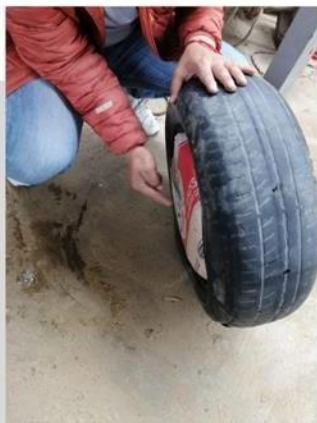
LA ARENA GENERA PRESION EN LAS ESQUINAS DEL CARTON EVITANDO QUE ESTE SE SALGA DEL NEUMÁTICO
