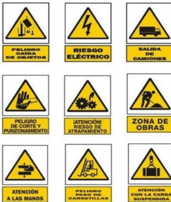
Figura 10. Señalización por Advertencia
