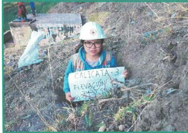
Imagen 09: se verifica la excavacion de la calicata C-03.
