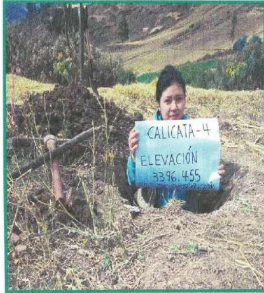
Imagen 11: se verifica la excavacion de la calicata C-04.
