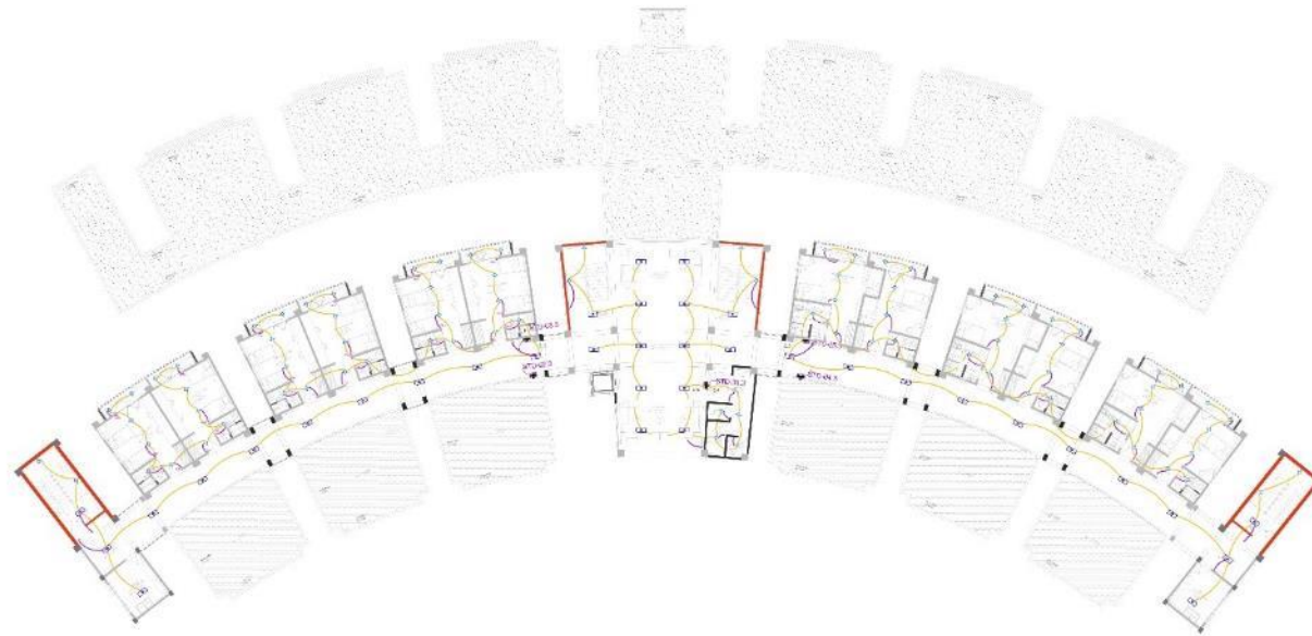
INSTALACIONES ELECTRICAS- SECTOR 1 - HOSPEDAJE 3ER PISO E.S.C.: 1:125
