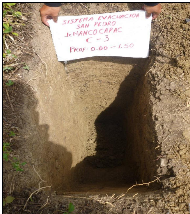
Vista 03.- Perfil estratigráfico de la Calicata C-3 Jr. Manco Capac- Cdra. 02
