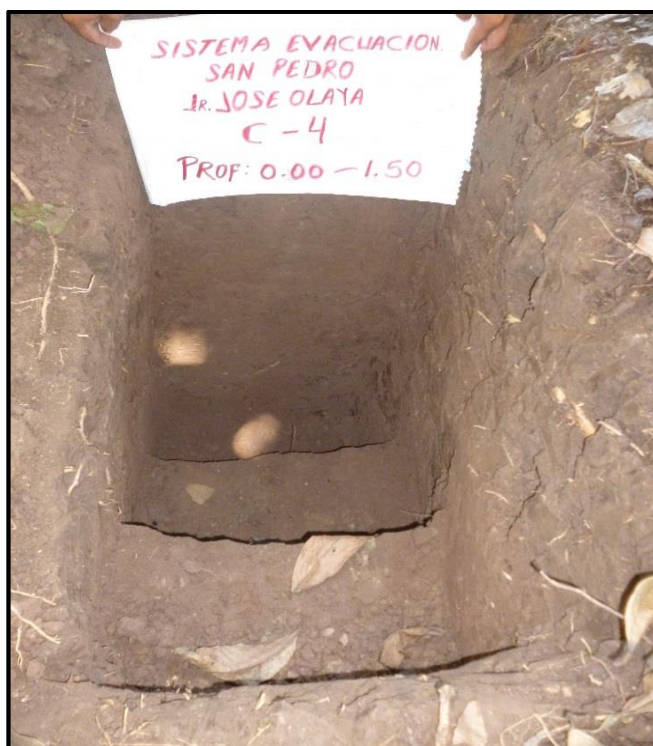
Vista 04.- Perfil estratigráfico de la Calicata C-4 Jr. José Olaya- Cdra. 01
