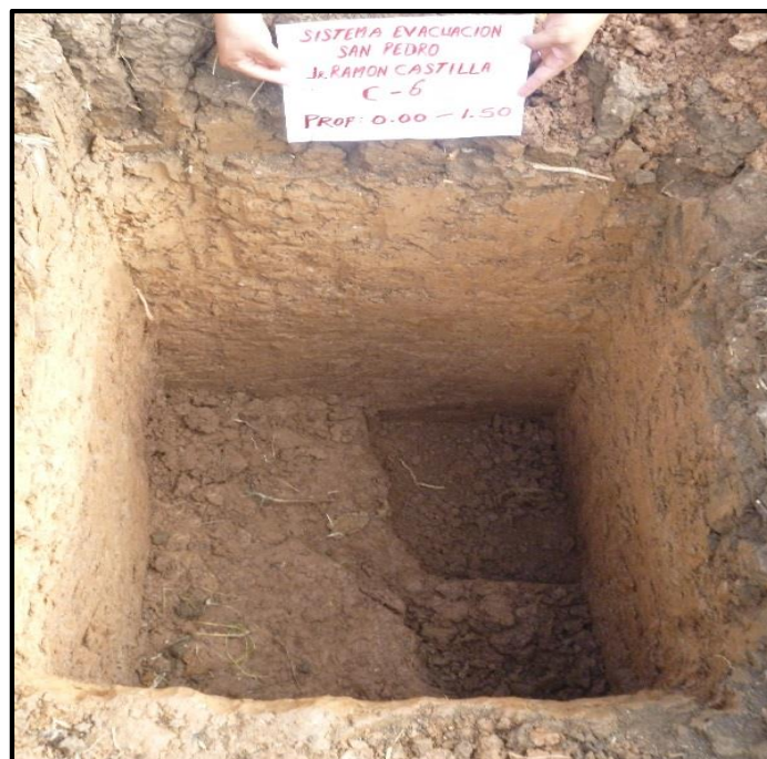
Vista 06.- Perfil estratigráfico de la Calicata C-6 Jr. Ramón Castilla- Cdra. 01
