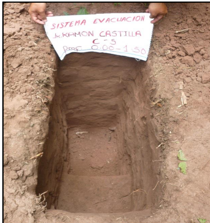
Vista 05.- Perfil estratigráfico de la Calicata C-5 Jr. Ramón Castilla- Cdra. 04
