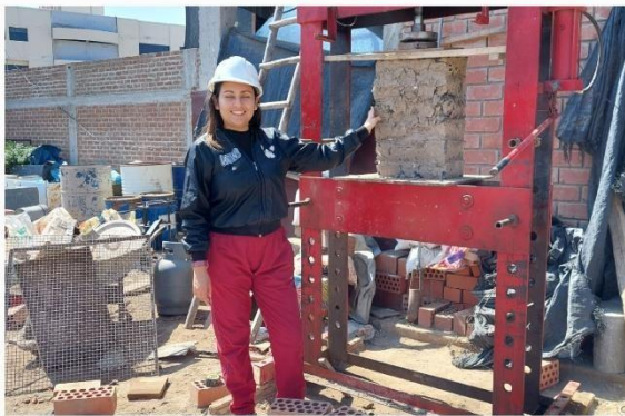
Ensayos de muerte a compresión y corte diagonal en laboratorio.
