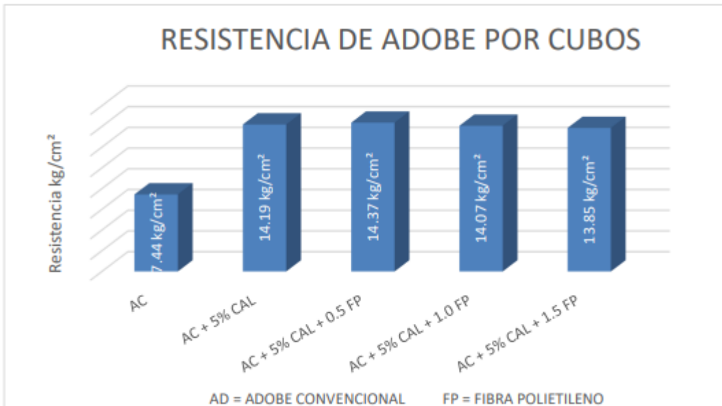
Figura 13: Gráfico de resistencia a la compresión de cubos en adobes convencionales y con % de adición de cal y % de fibra de polietileno.
