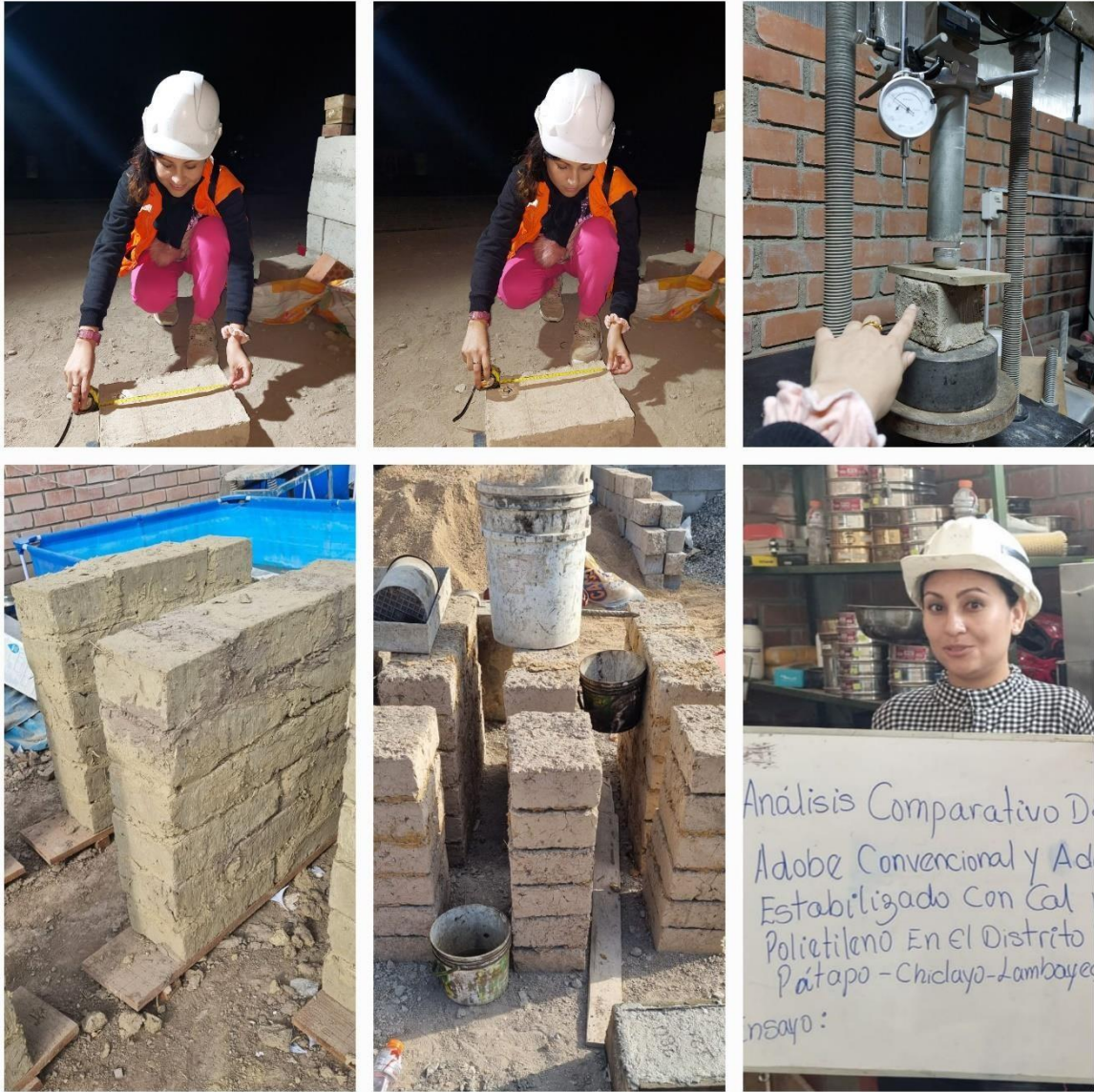
Medición de adobes con incorporación de cal de obra en porcentajes y ensayos de rotura de cubos.
