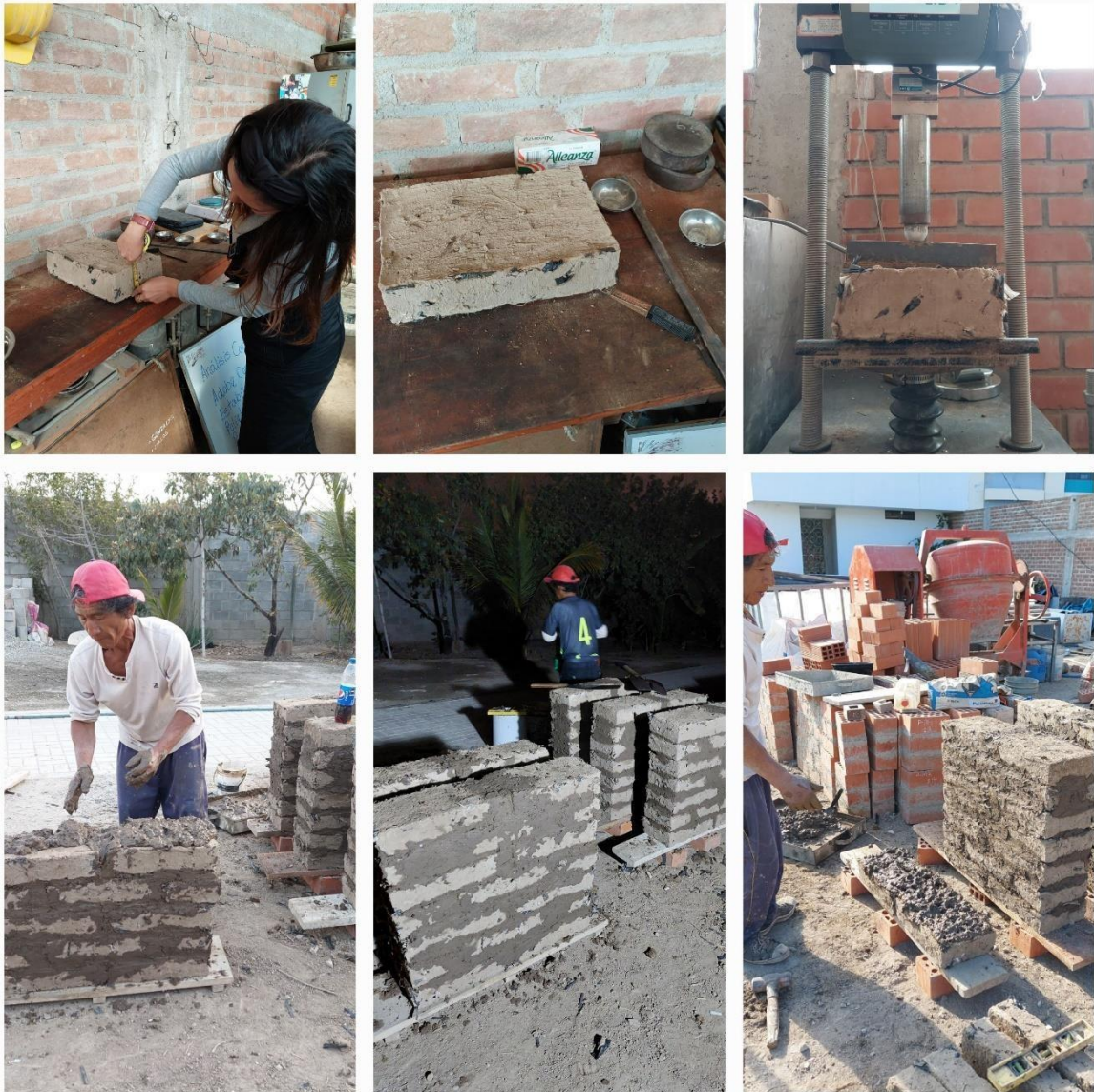
Elaboración de muretes y ensayos de flexión de adobes con cal.
