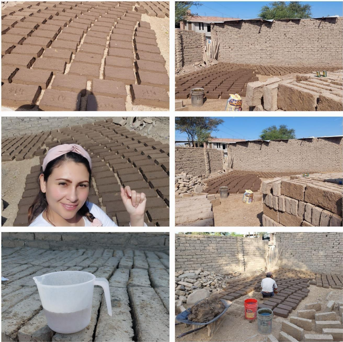
Proceso de secado y solidificación de adobes convencionales.
