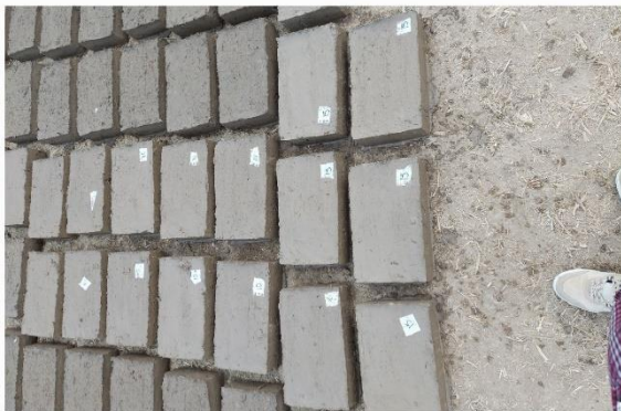
Elaboración de adobes con incorporación de cal de obra en porcentajes.
