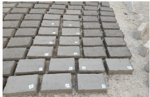
Elaboración de adobes con incorporación de cal de obra en porcentajes.
