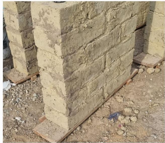
Muestra de murete con adición de cal y ensayo de rotura diagonal en laboratorio LEMS, W$C EIRL.
