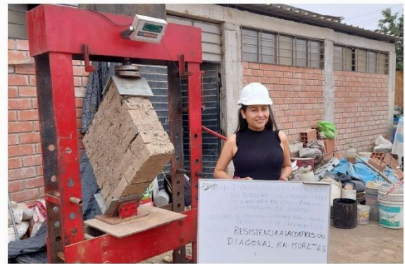
Ensayos de muerte a compresión y corte diagonal en laboratorio.
