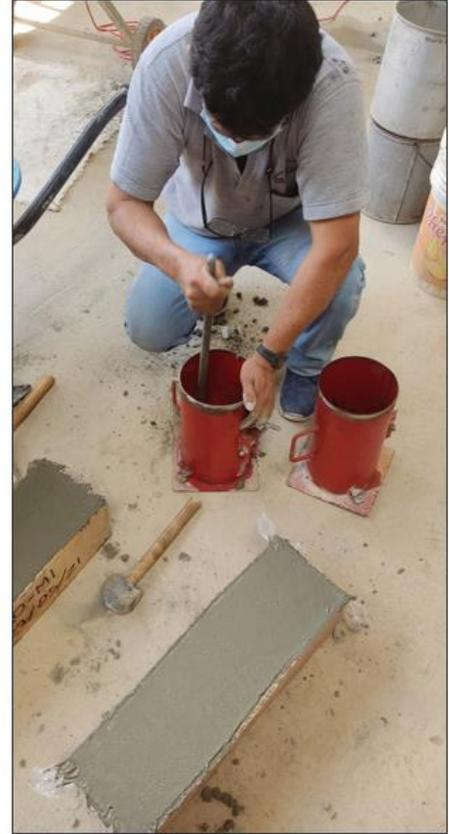
Nota. Obtención de las probetas de concreto. Elaboración propia.
