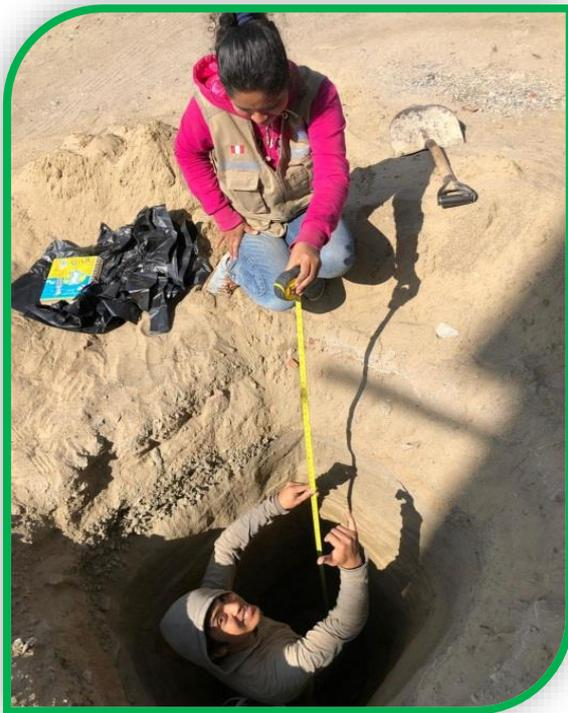
**Foto n°34:** Se visualiza a la alumna Vásquez Pérez Karen con su colaborador de apoyo midiendo la profundidad de la Cn° 02 donde en el proceso de excavación se encontró favorablemente una superficie maciza rocosa a los 2.20 m de profundidad.
