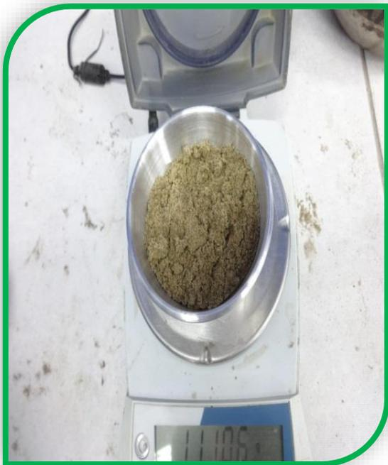
**Foto n°58:** Se visualiza el pesaje de la pequeña muestra húmeda extraída.
