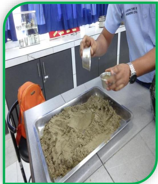
**Foto n°45:** Se visualiza el pesaje de la pequeña muestra húmeda extraída, el mismo proceso se realiza para las demás muestras obtenidas.
