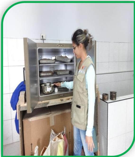
*Foto n°64: Se visualiza a la alumna Ortiz Nakamura Alixon ingresando sus muestras húmedas en el horno para su posterior secado.*
