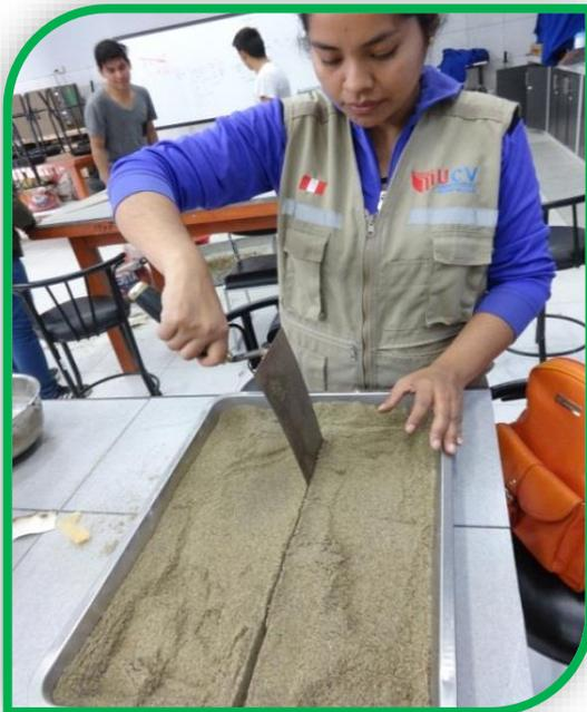
**Foto n°48:** Se visualiza a la alumna Vásquez Pérez Karen cuarteando la muestra húmeda para seleccionar la muestra a utilizar en el ensayo de granulometría.
