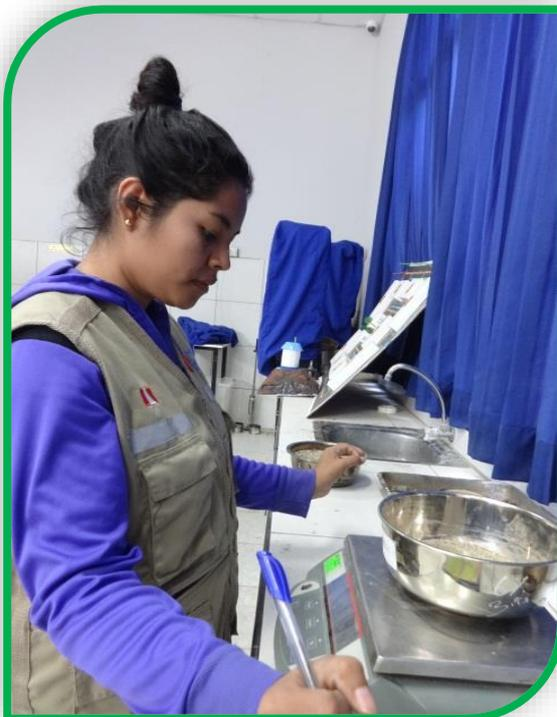
*Foto n°72: Se visualiza a la alumna Vásquez Pérez Karen pesando la tara a utilizar en el ensayo.*
