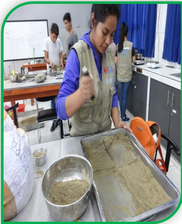
**Foto n°52:** Se visualiza a la alumna Vásquez Pérez Karen repitiendo el procedimiento de cuarteo de la muestra húmeda para los demás estratos obtenidos de modo que se pueda seleccionar la muestra a utilizar en el ensayo de granulometría.
