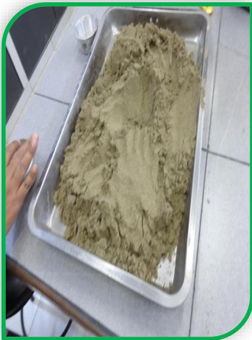
**Foto n°43:** Se visualiza la muestra **cn°02** húmeda para realizar el ensayo de contenido de humedad.
