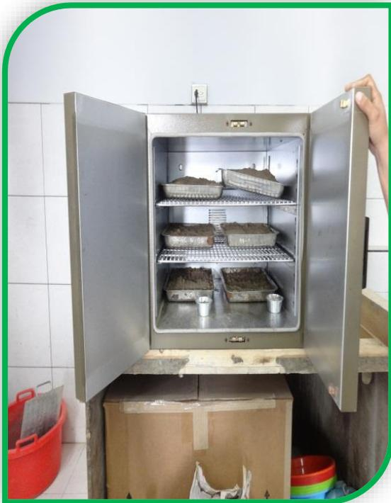
**Foto n°46:** Se visualiza muestras húmedas colocadas en el horno para su posterior secado.
