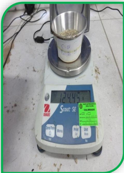
**Foto n°69:** Se visualiza el pesaje de la muestra seca de la Cn°01.
