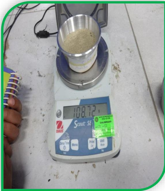
*Foto n°70: Se visualiza el pesaje de la muestra seca de la Cn°02.*
