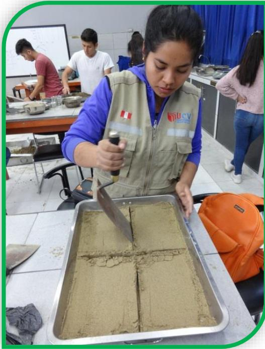
*Foto n°61: Se visualiza a la alumna Vásquez Pérez Karen cuarteando la muestra húmeda para seleccionar la muestra a utilizar en el ensayo de granulometría.*
