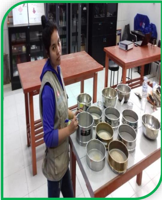
*Foto n°82: Se visualiza finalmente las muestras retenidas en todos lo tamices utilizados para su posterior pesaje.*
