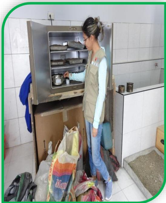
**Foto n°49:** Se visualiza a la alumna Ortiz Nakamura Alexon ingresando sus muestras húmedas en el horno para su posterior secado.
