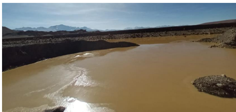
Figura 13. Pozo de sedimentación del relave minero (mat. fino).
