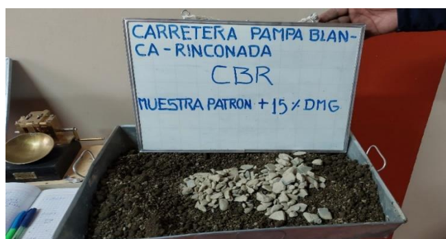
Figura 41. Incorporación del DMG a la muestra patrón para el ensayo de CBR.
