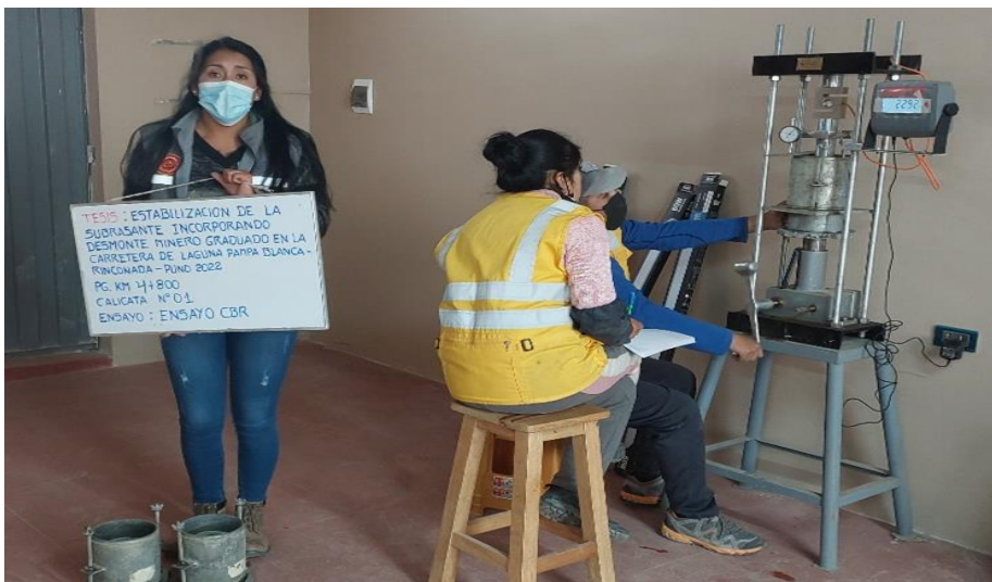
Ensayo de penetración mediante el equipo de Prensa Hidraulica
