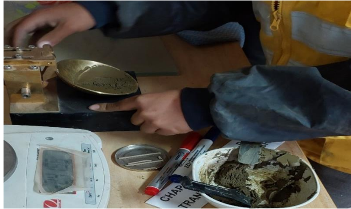
Figura 26. Proceso de girar la maniveladora del equipo de la Copa de Casagrande para determinar el N.º de golpes.
