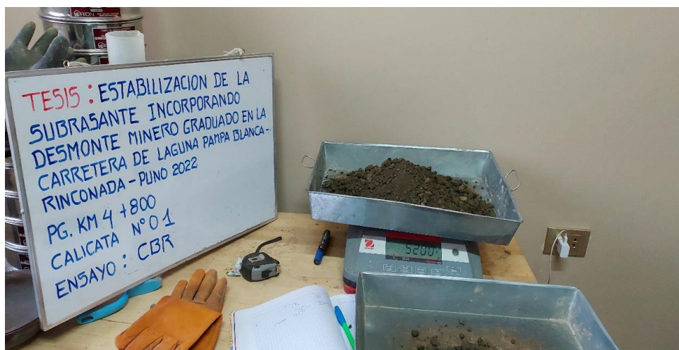
Realización del ensayo de CBR
