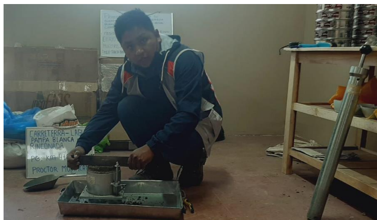
Figura 29. Enrasado de la muestra a nivel superior del cilindro.
