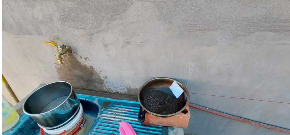
Proceso del lavado de la muestra en el ensayo de granulometría.
