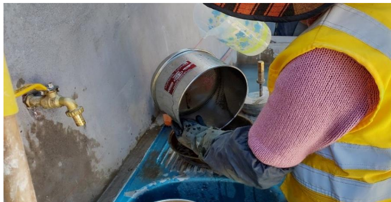
Figura 22. Lavado de la muestra en el tamiz N° 200.
