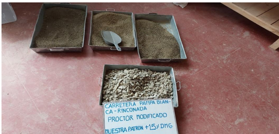
Preparación de la muestra patrón y el material de mejoramiento DMG.
