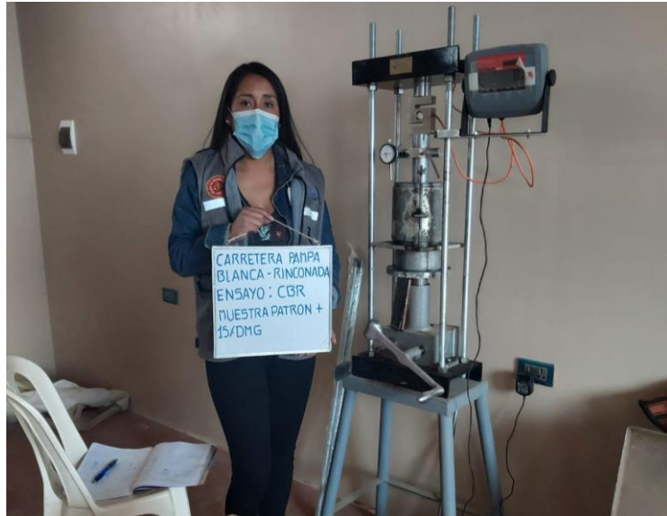
Figura 42. Ensayo CBR, penetración de la muestra patrón con la adición DMG.
