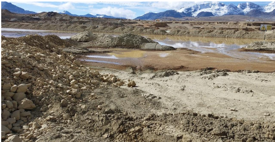
Pozos de sedimentación del material minero.
