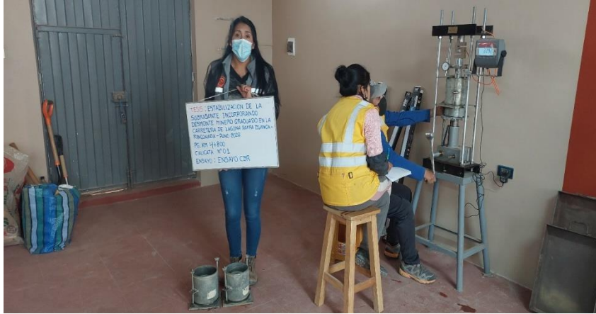
Figura 33. Penetración del suelo mediante el Equipo Prensa Hidráulica.
