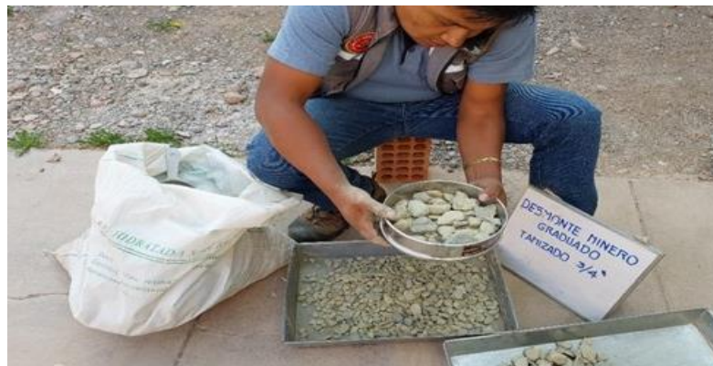
Figura 38. Tamizado del Desmorte Minero Graduado.
