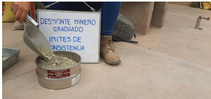
Figura 46. Tamizado del material de mejoramiento del DMG mediante la malla N.º 40 para el ensayo de límites de consistencia.
