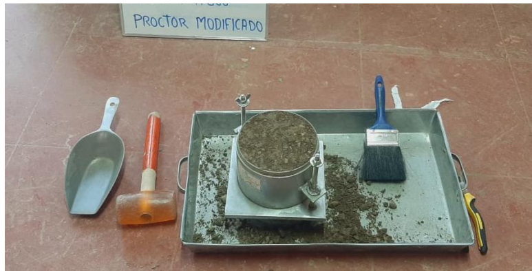
Figura 28. Muestra colocada en el molde y compactada en cada capa.
