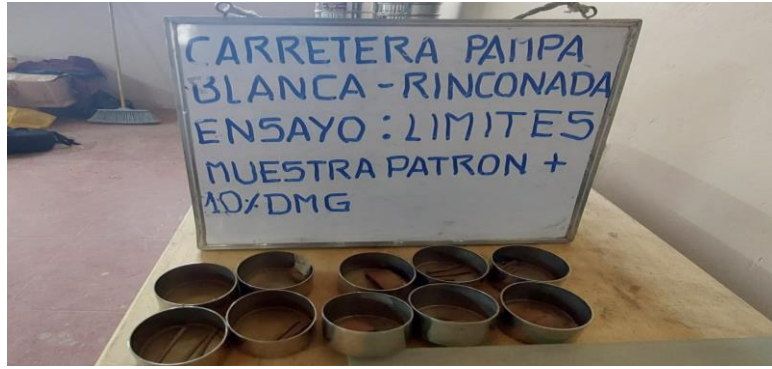
Figura 47. Ensayo de limite plástico, cilindros de muestra con DMG.
