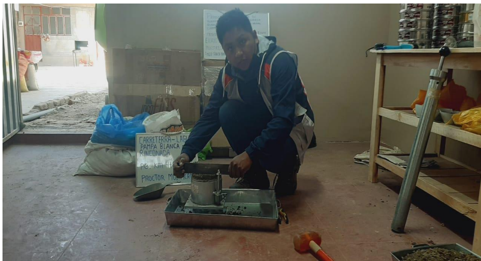
Realización del ensayo de Proctor modificado
