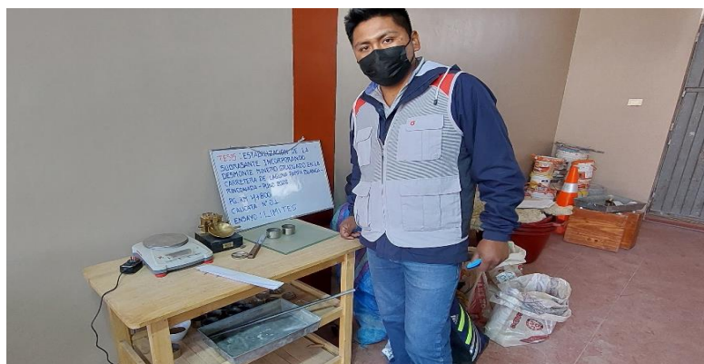
Figura 25. Equipos empleados en el ensayo de Límites de Atterberg
