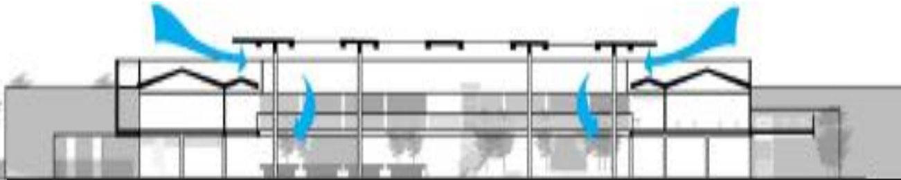
CORTE TRANSVERSAL A - A (VENTILACIÓN)
