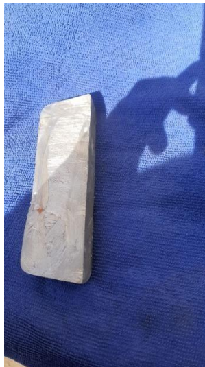
Figura 6: Ánodo de Zinc
