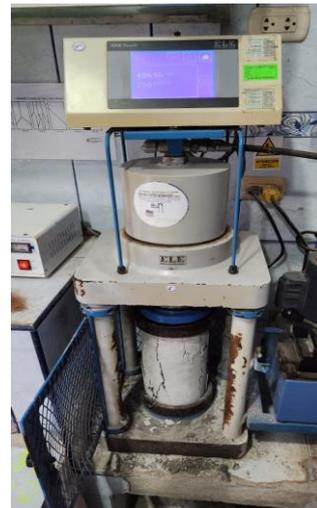
*Figura 4.9.* Rotura de probetas
