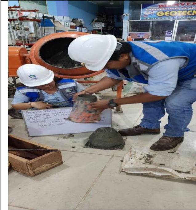
13: Determinación del asentamiento (slump)
