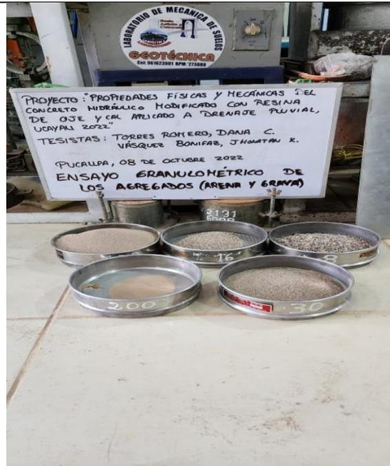
08: Separación por tamices del agregado fino
