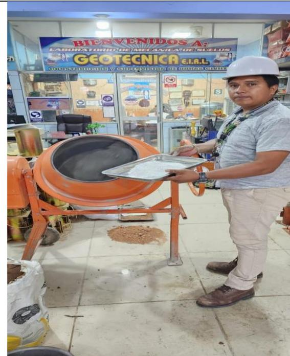
12: Incorporación de la cal al diseño de mezcla
