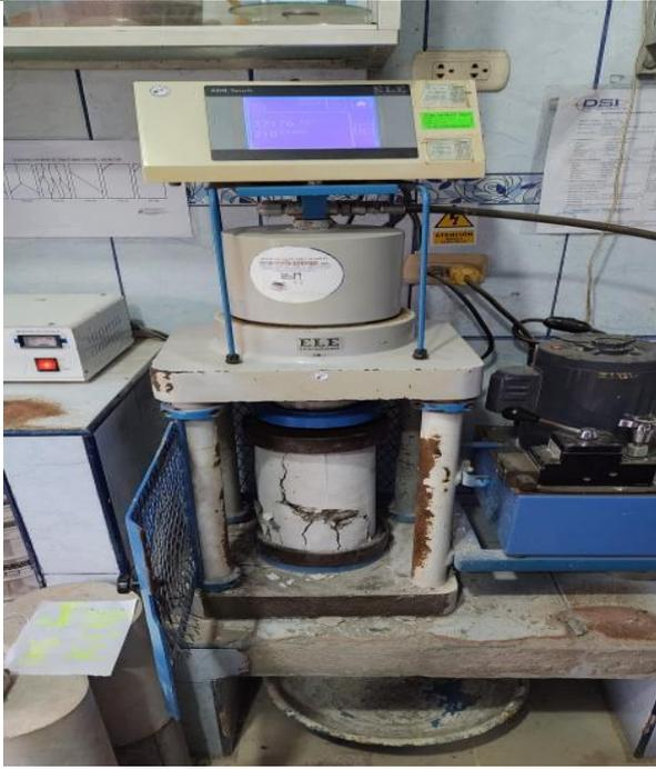
21: Rotura de briquetas- Ensayo de Compresión
