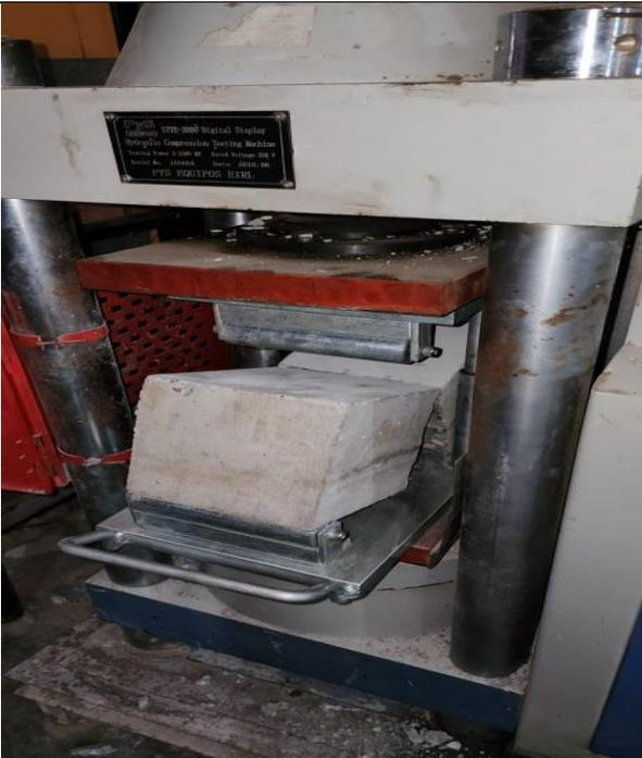
23: Rotura de viguetas- Ensayo de Flexión
