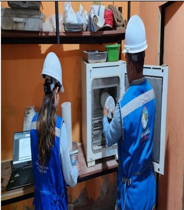
19: Obtención de diferencia de pesos para ensayo de absorción
