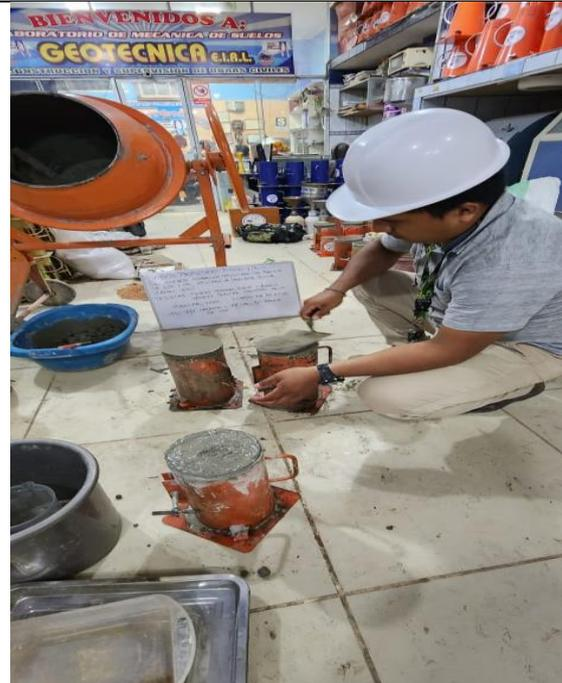
14: Vaciado de mezcla en las briquetas
