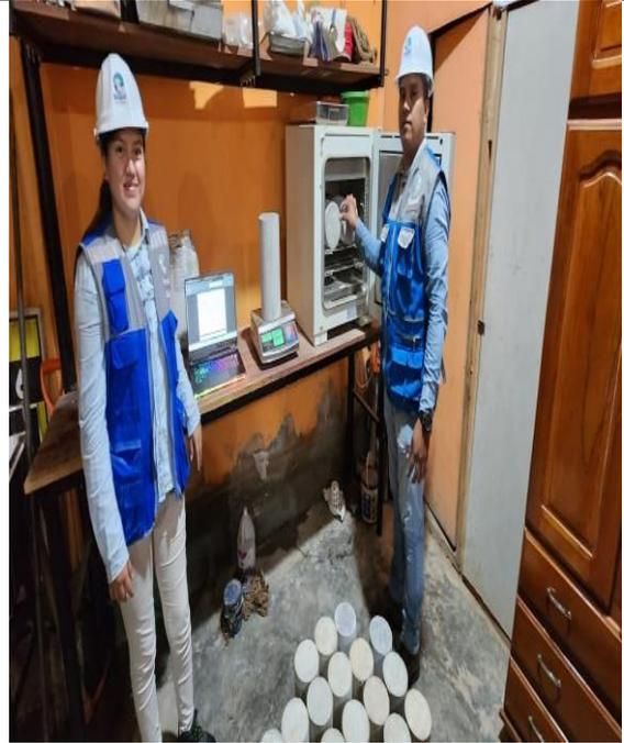
18: Determinación de los pesos de las briquetas antes de ingresar al horno
