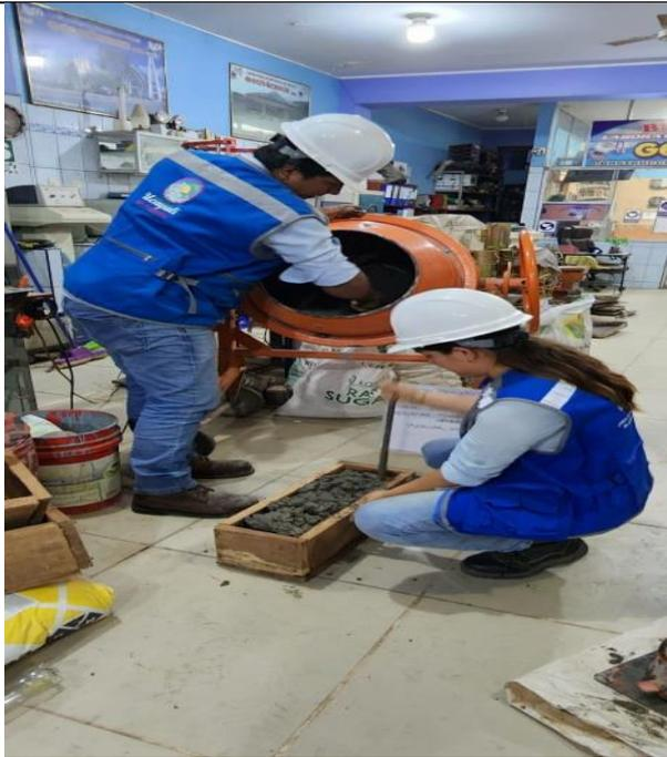
15: Vaciado de mezcla en las viguetas
