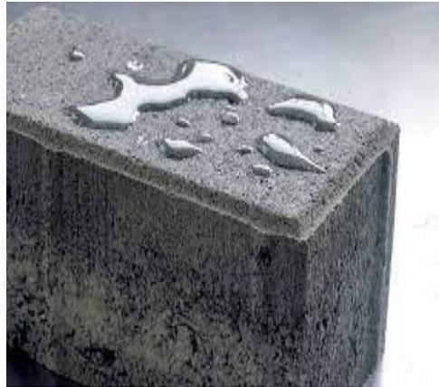
Figura 2.3. Impermeabilidad del Concreto
