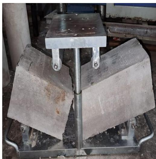
Figura 4.12. Rotura de viguetas
