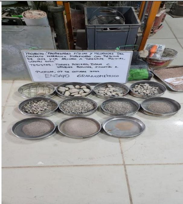
07: Separación por tamices del agregado grueso
