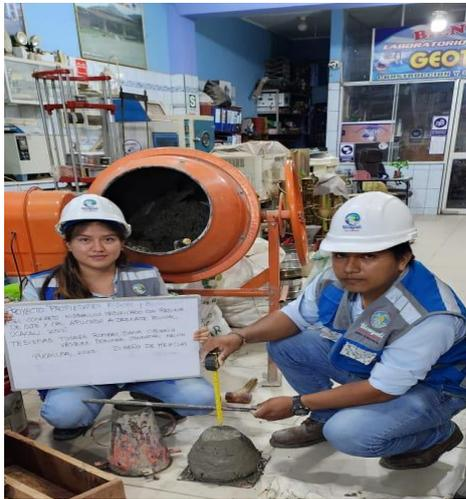
Figura 3.4. Determinación del slump
