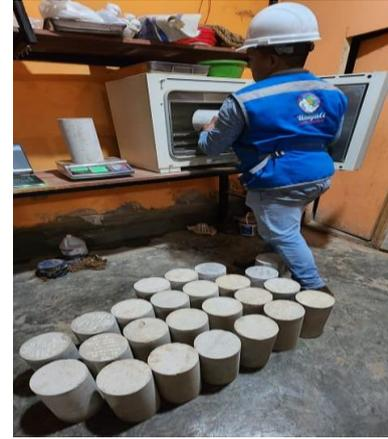
Figura 4.6. Utilización del horno para ensayo de absorción
