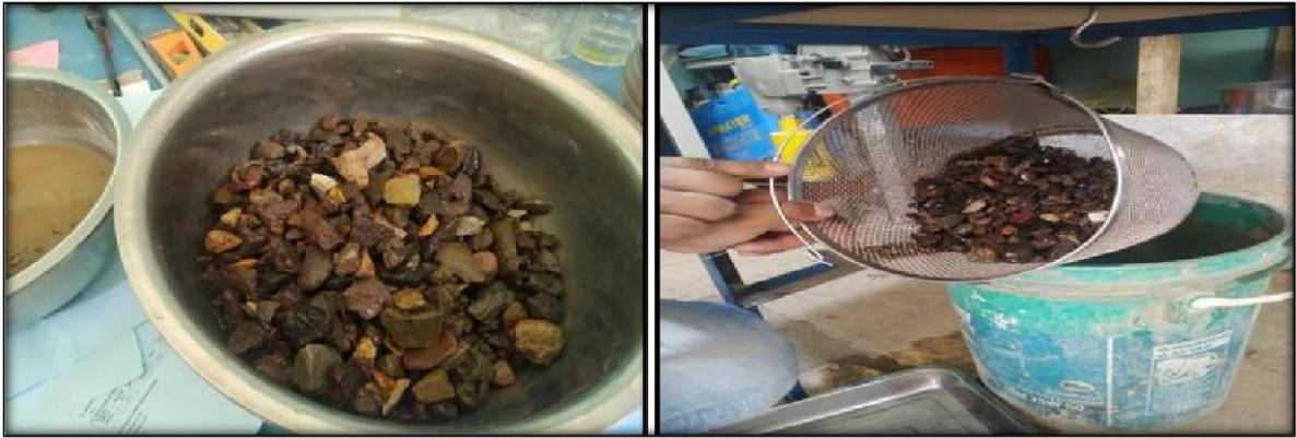
Figura 5 Peso específico material grueso
