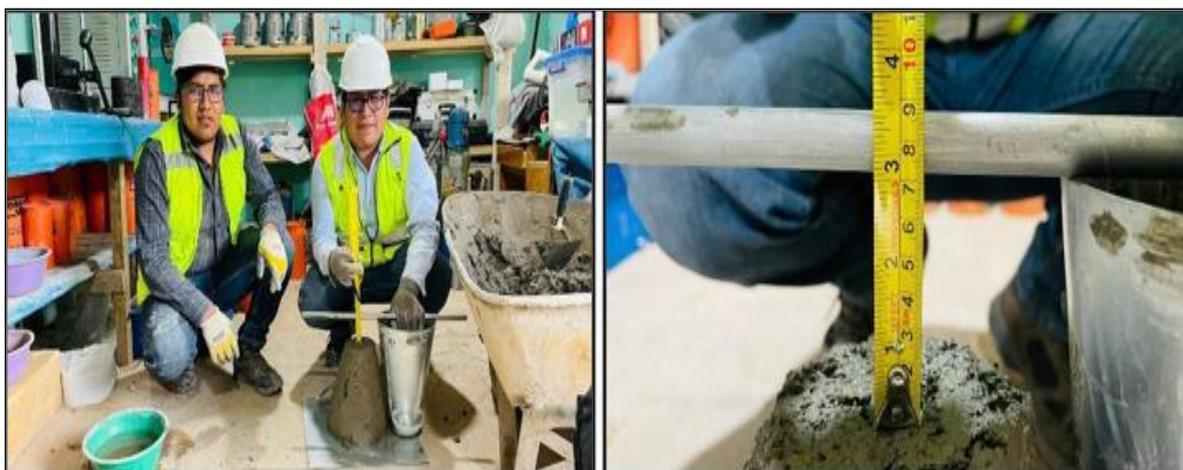
Figura 10. Revenimiento o asentamiento (Slump)
