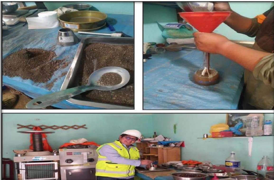
Figura 6. Peso específico material fino.
