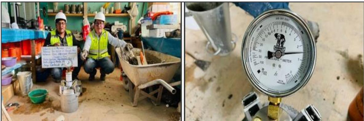
*Figura 12.* Porcentaje de aire del concreto fresco
