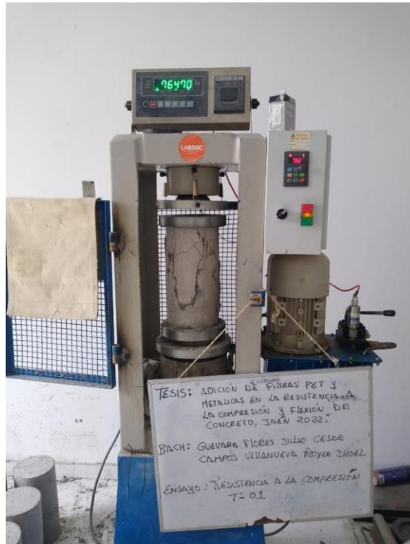
**Figura 17.** Medición del esfuerzo a la compresión del tratamiento T-1 a los 28 días
