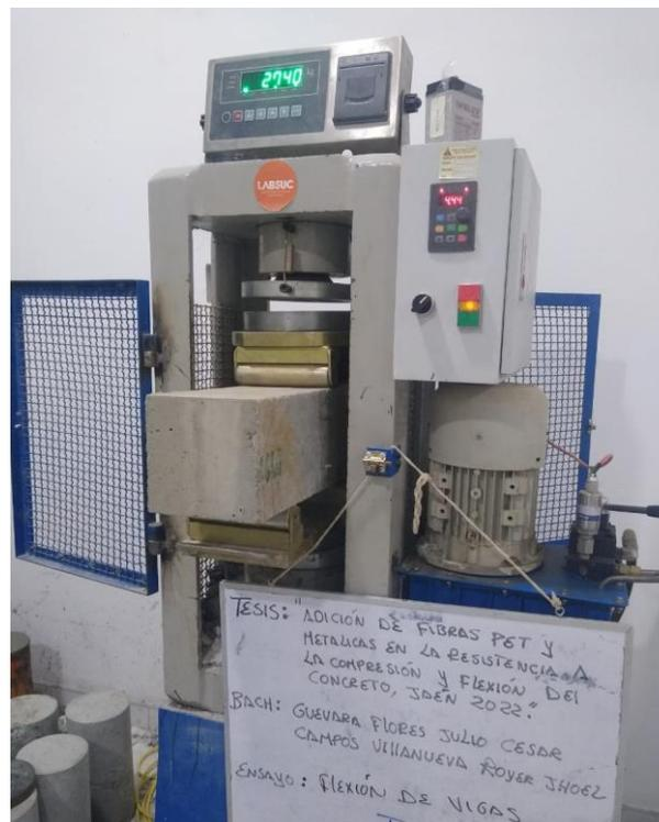
**Figura 18.** Medición de la resistencia a la flexión del tratamiento T-2 a los 28 días
