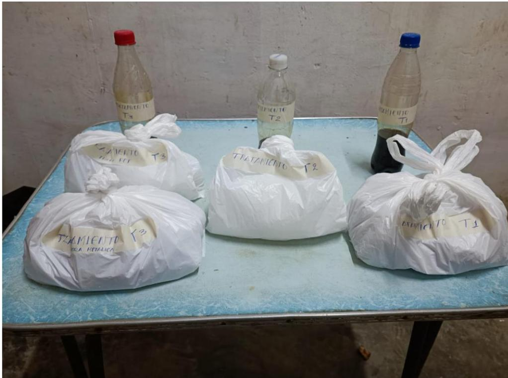
**Figura 14.** Aditivos de fibra PET, metálica y superplastificantes para los tratamientos en estudio
