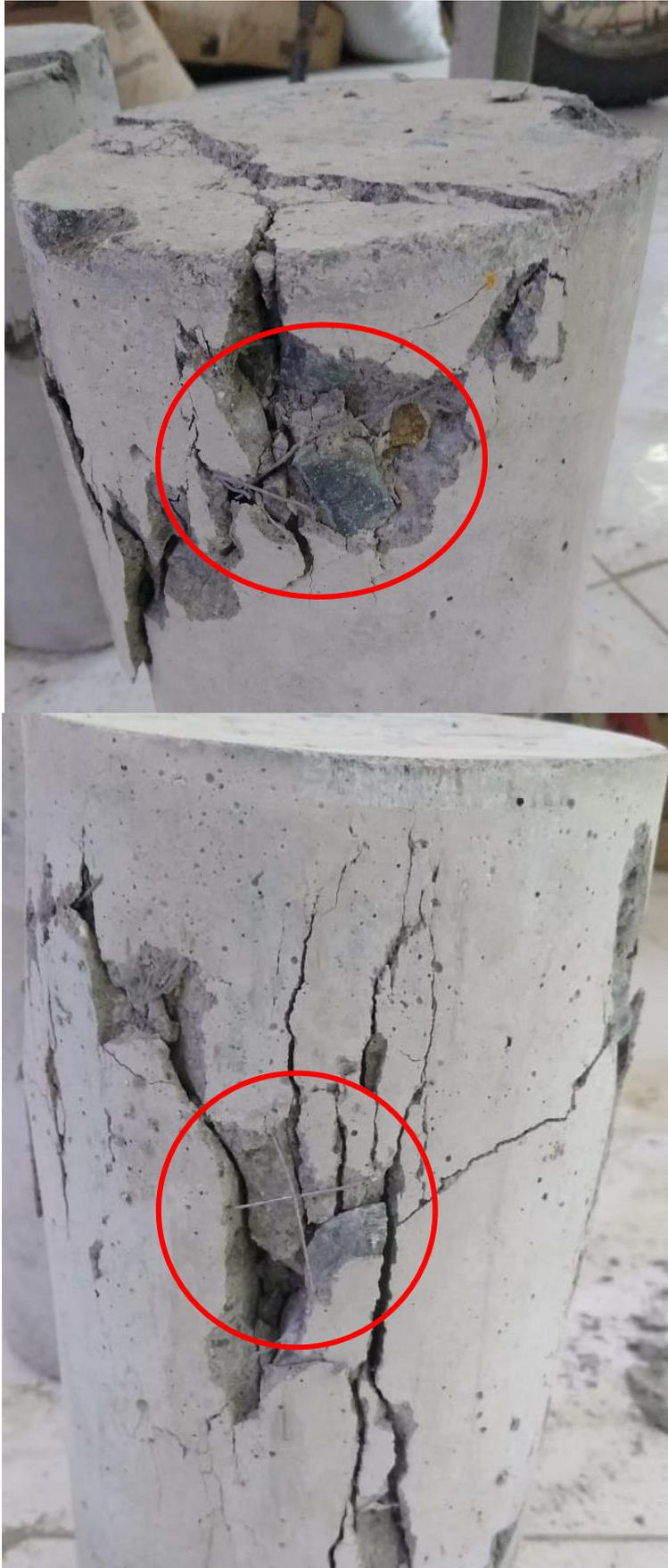
**Figura 19.** Vista de las fibras metálicas en probetas del tratamiento T-1 luego del ensayo de compresión
