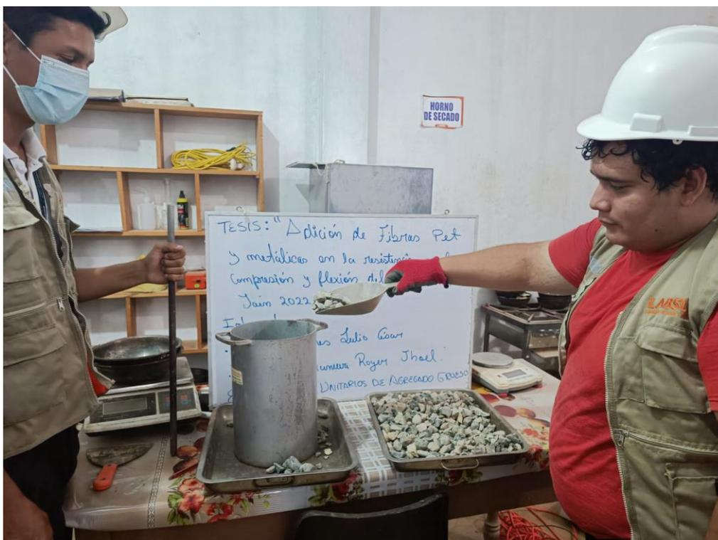
Figura 10. Ensayo de peso unitario de agregados en laboratorio
