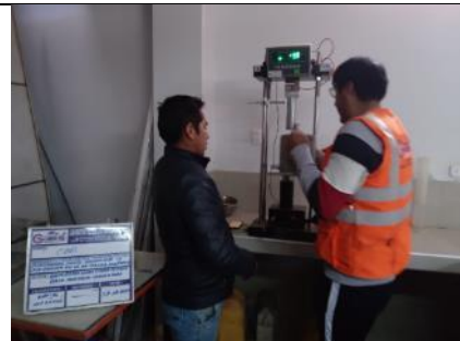
Colocacion del Molde+ Muestra con Aditivo
