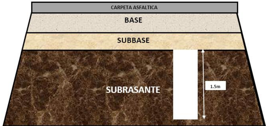
Figura 10. Diagrama la profundidad de las calicatas de estudio según la MTC
