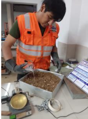
Adición del Sistema Consolid a la Muestra
