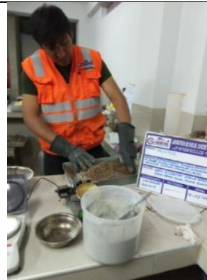
Adición del Sistema Solidry a la Muestra
