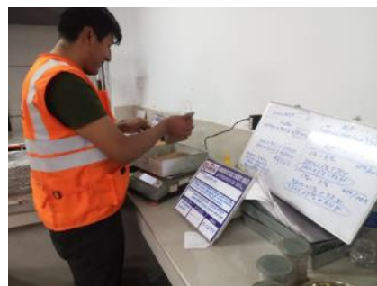
Pesado de la Muestra para la adicon Solidry
