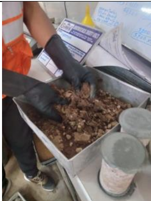
Adición del Sistema Consolid a la Muestra
