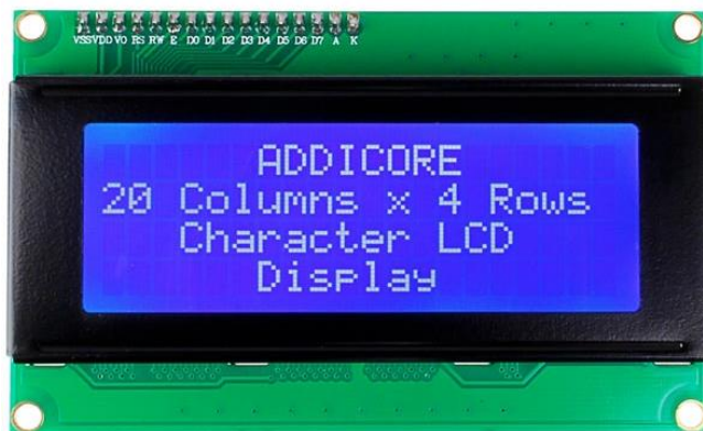
Figura 59. Display Alfanumérico LCD 2004
