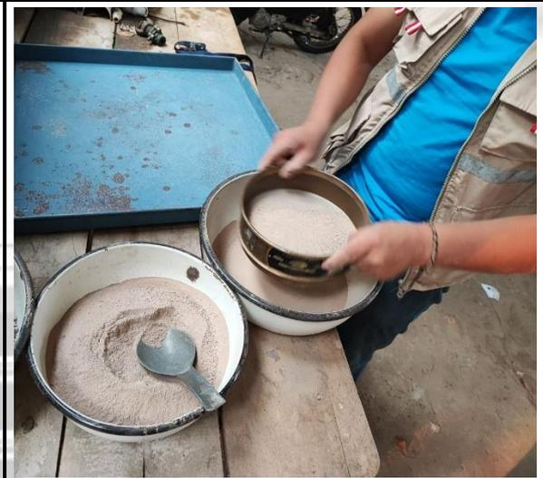
Fotos nº 09-10: En las imágenes podemos apreciar los materiales a utilizar para el diseño de concreto con adición de Ceniza de cascara de maní y polvo de ladrillo.
