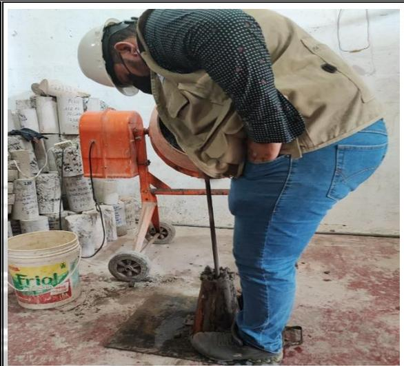
Fotos nº 13-14: En las imágenes podemos observar al personal realizando la prueba de asentamiento para los diseños de Mezclas.
