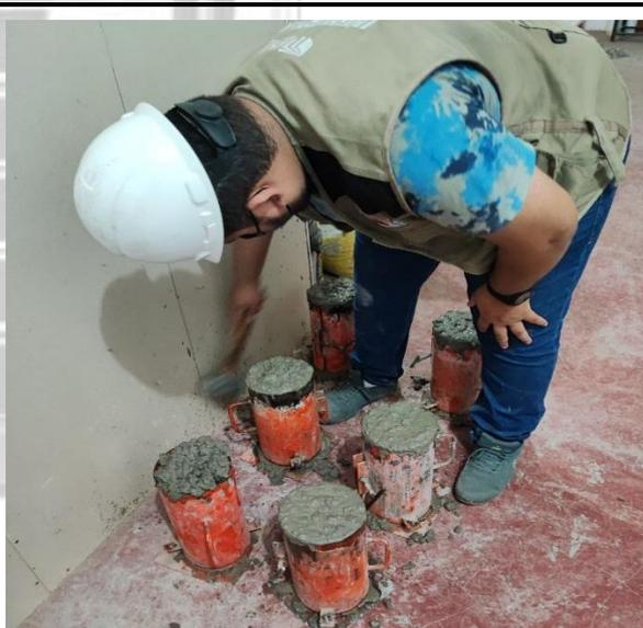
Fotos nº 15-16: En las imágenes podemos observar al personal realizando el moldeo de los testigos de concreto.
