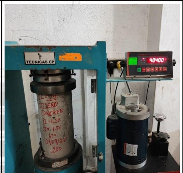
Fotos nº 21-22: En las imágenes podemos observar la resistencia a la compresión axial de los testigos de concreto
