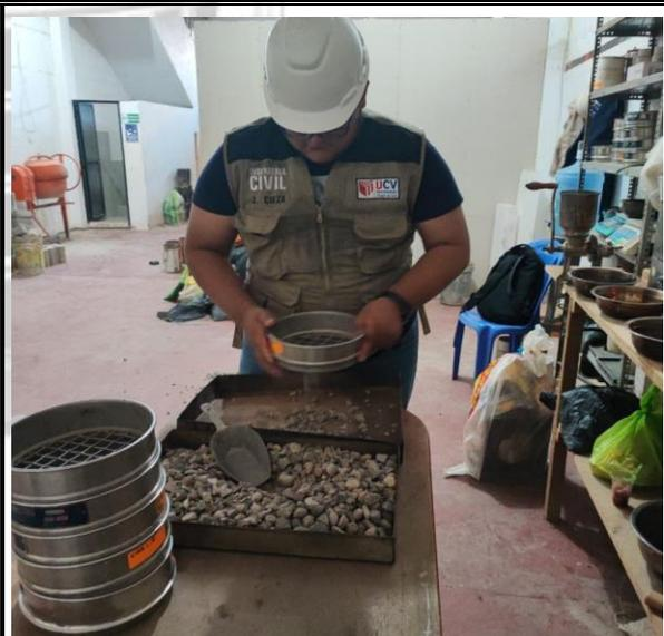
Fotos nº 03-04: En las imágenes se puede apreciar el ensayo de análisis granulométricos.
