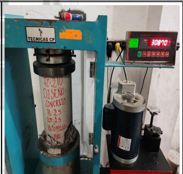
Fotos nº 23-24: En las imágenes podemos observar la resistencia a la compresión axial de los testigos de concreto
