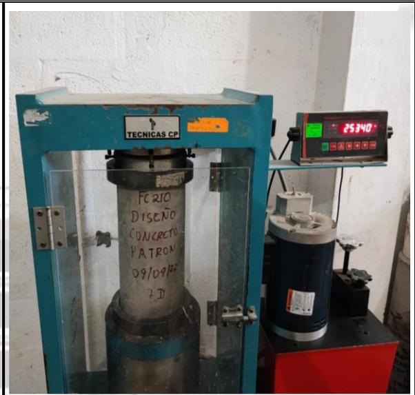
Fotos nº 17-18: En las imágenes podemos observar la resistencia a la compresión axial de los testigos de concreto
