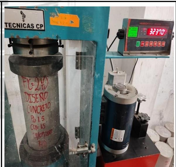
Fotos nº 19-20: En las imágenes podemos observar la resistencia a la compresión axial de los testigos de concreto
