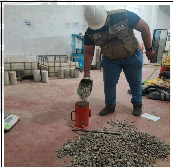
Fotos nº 07-08: En las imágenes podemos observar realización del ensayo de peso unitario.
