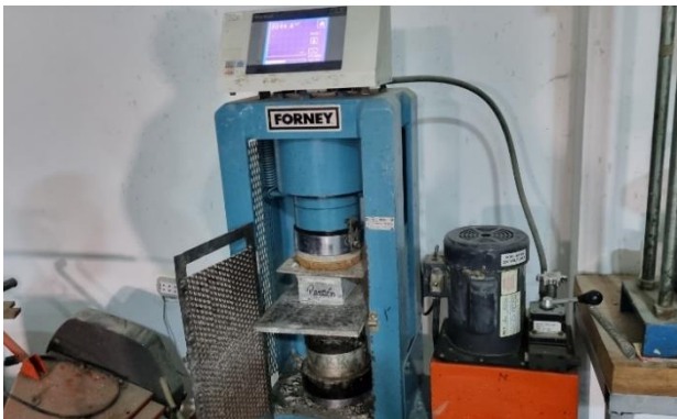
Figura 11: Ensayos de rotura. Fuente: Elaboración propia.
