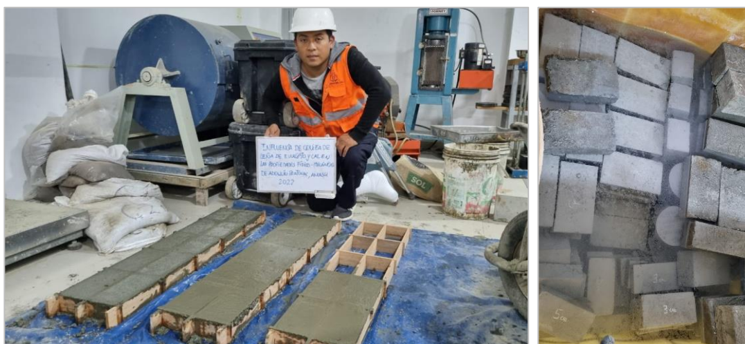
Figura 12. Elaboración de grupos de control y curado de adoquín peatonal Fuente: Elaboración propia
