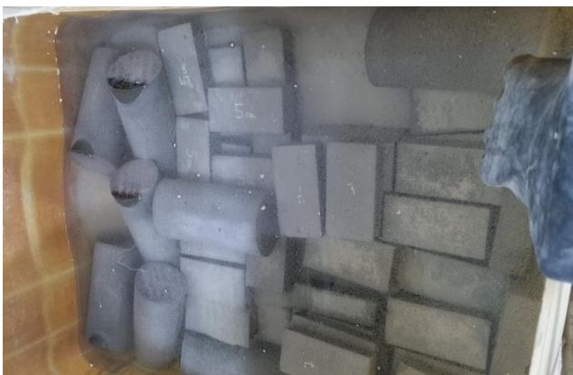
Figura 9: Curado de muestras de adoquín peatonal. Fuente: Elaboración propia.
