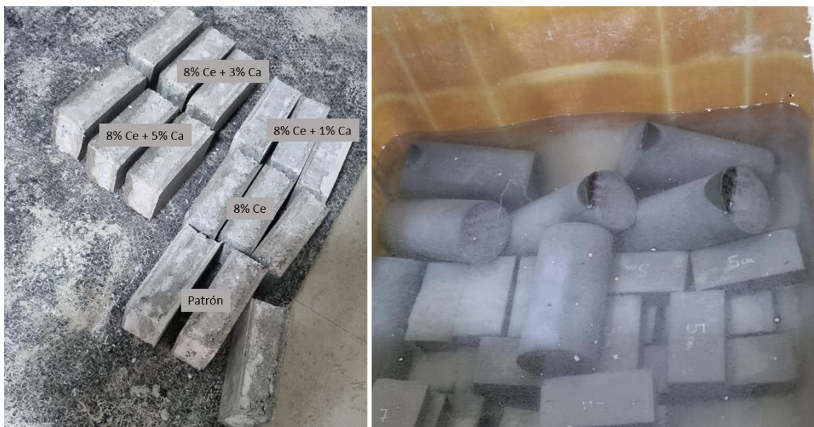
Figura 8. Grupos de control para ensayo de absorción y muestras en saturación Fuente: Elaboración propia
