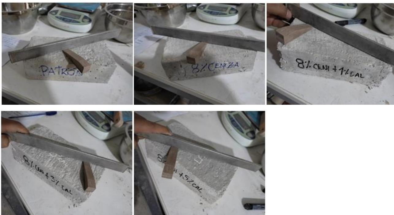
Figura 10. Ensayo de alabeo en cada grupo de control Fuente: Elaboración propia
