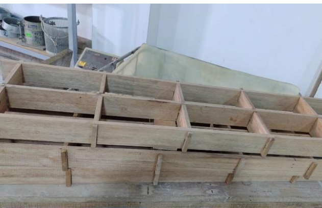
Figura 5: Molde para elaboración de adoquín. Fuente: Elaboración propia.
