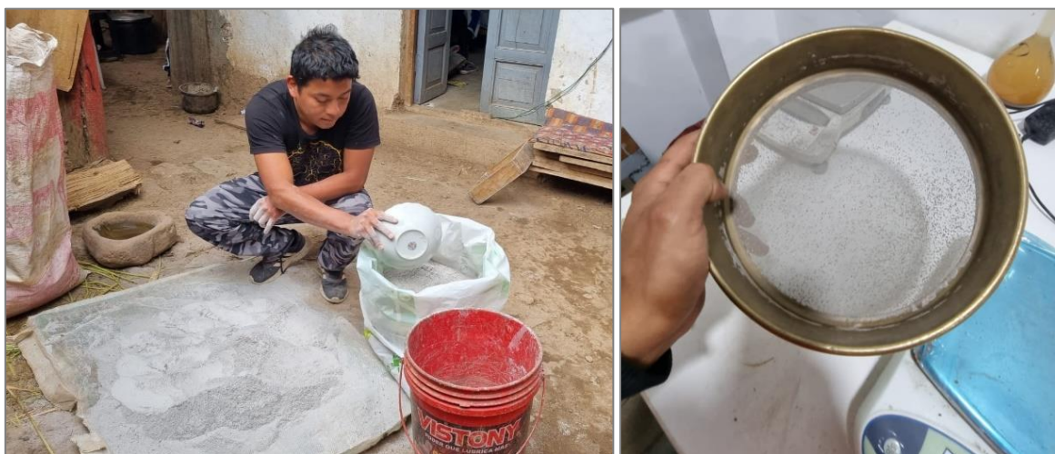
Figura 6. Recolección de ceniza y tamiz Fuente: Elaboración propia
