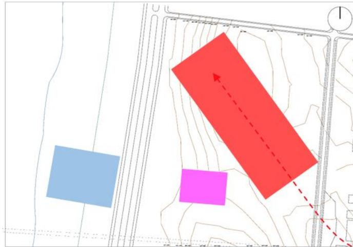
Se halla un punto inicial en la topografía que es una brecha en donde se van abriendo las curvas de nivel, desde donde se trazan ejes siguiendo las curvas topográficas de forma escalonada formando elementos de remate, generando terrazas y miradores hacia el oeste.
