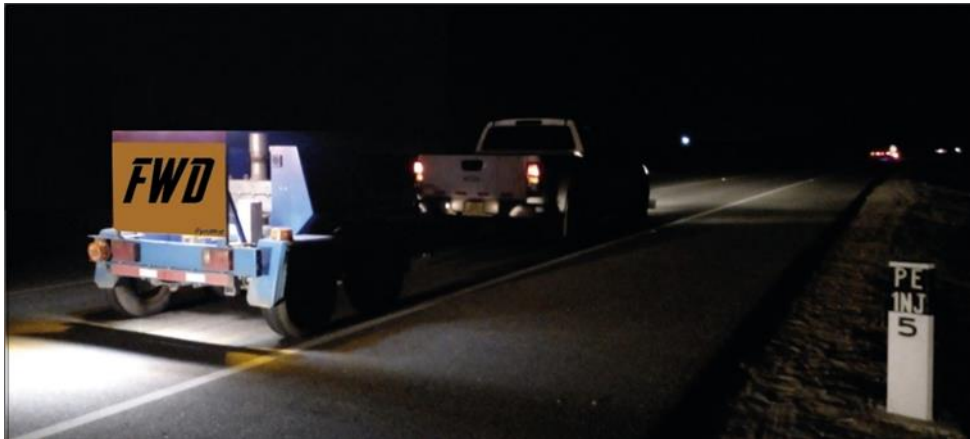
Figura 12. Medición de deflexiones con el deflectómetro de impacto
