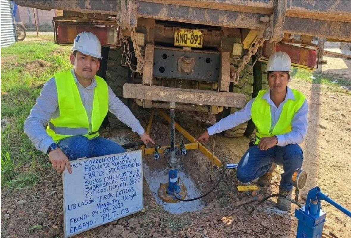
Fotografía 13: Ensayo Placa de Carga – 03
