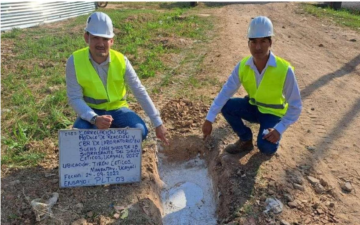
Fotografía 14: Huella de placa K-30 resultado del Ensayo Placa de Carga – 03
