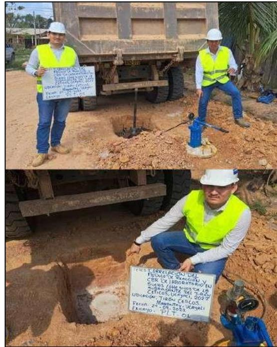
**Figura 09.** Ensayo de Placa de Carga en suelos Cohesivos.
