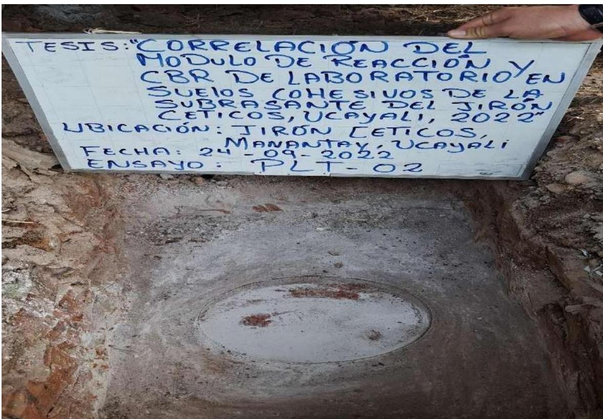
Fotografía 12: Huella de placa K-30 resultado del Ensayo Placa de Carga – 02
