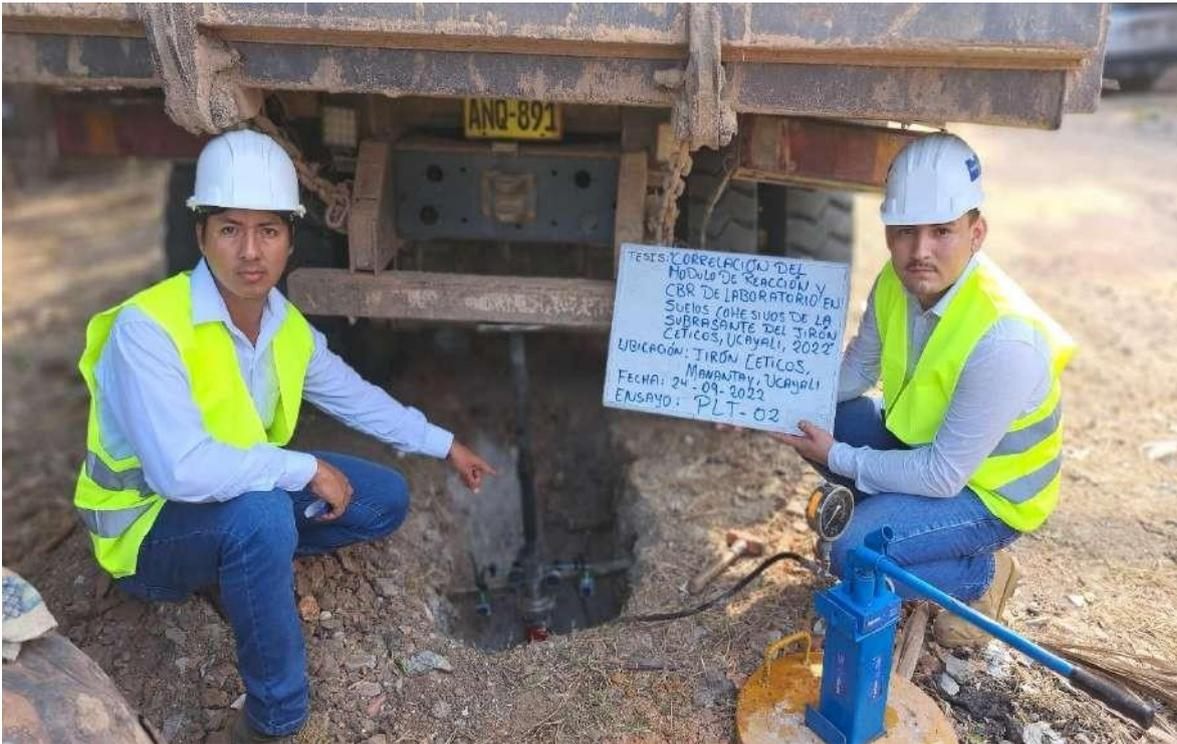
Fotografía 11: Ensayo Placa de Carga – 02
