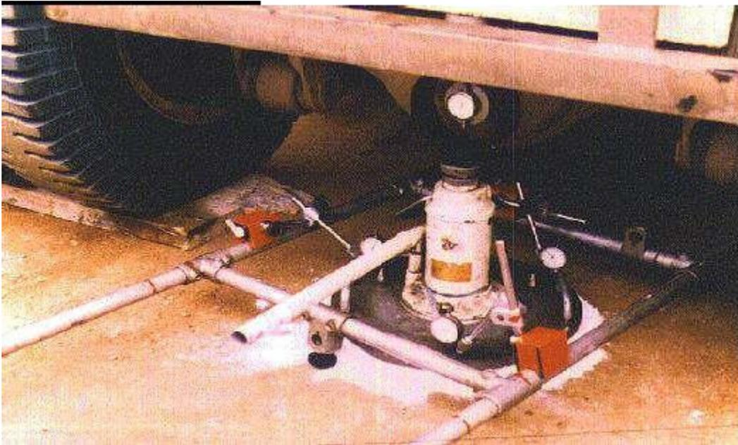
**Figura 2:** Ensayo de Placa de carga (Aravena R. y Kramer P., 1984).
