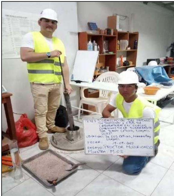
**Figura 11.** Ensayo Proctor modificado con arcillas de alta plasticidad "CH"
