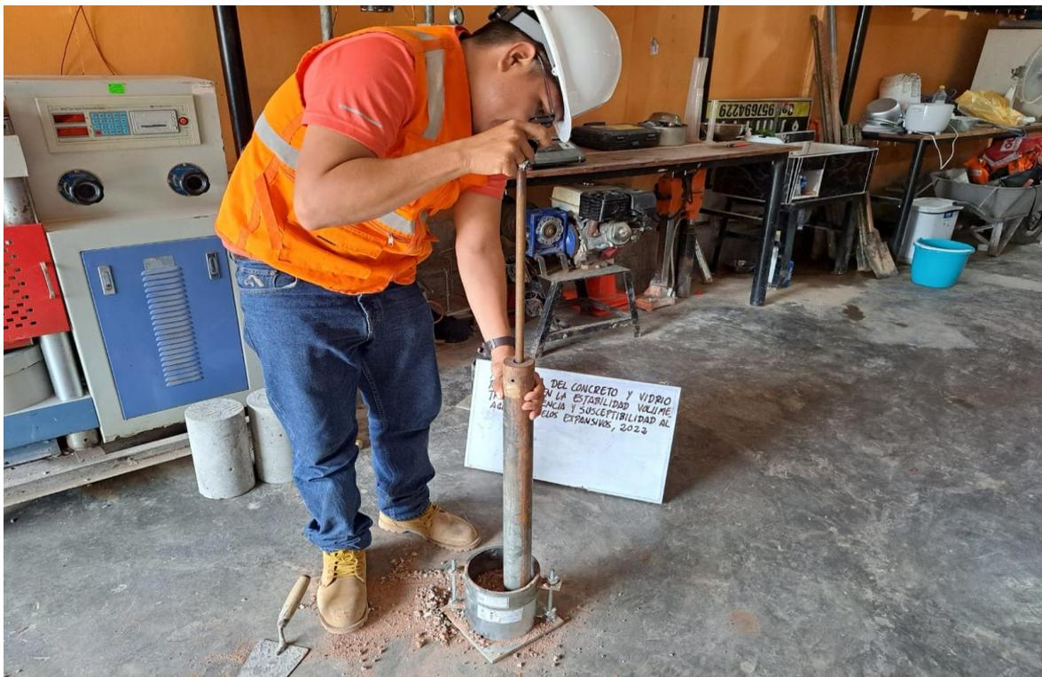
Imagen N°06: Golpes a la muestra para el ensayo proctor.
