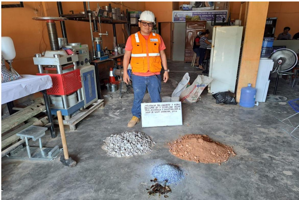
Imagen N°04: Presentación de los materiales triturados para los ensayos.
