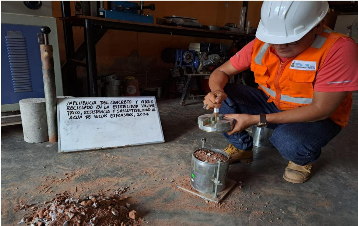
Imagen N°07: Colocación de materiales para las muestras del ensayo proctor modificado.
