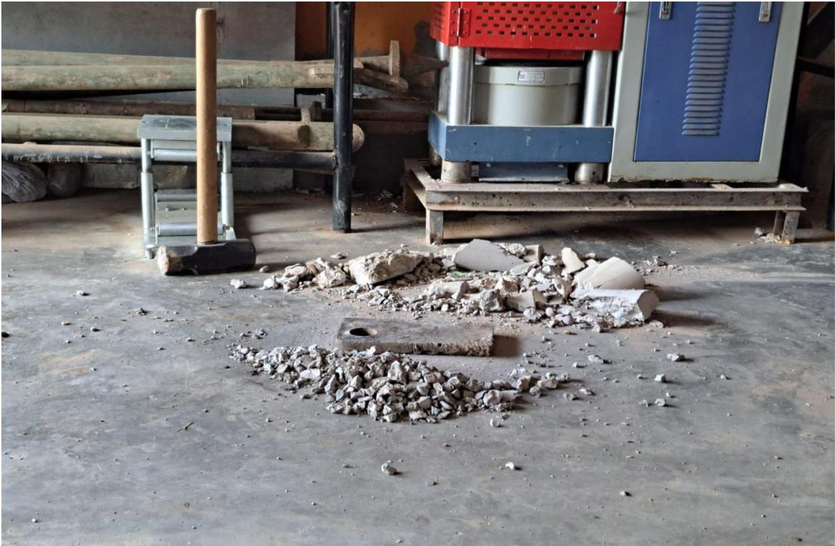
Imagen N°01: Proceso de trituración del concreto.
