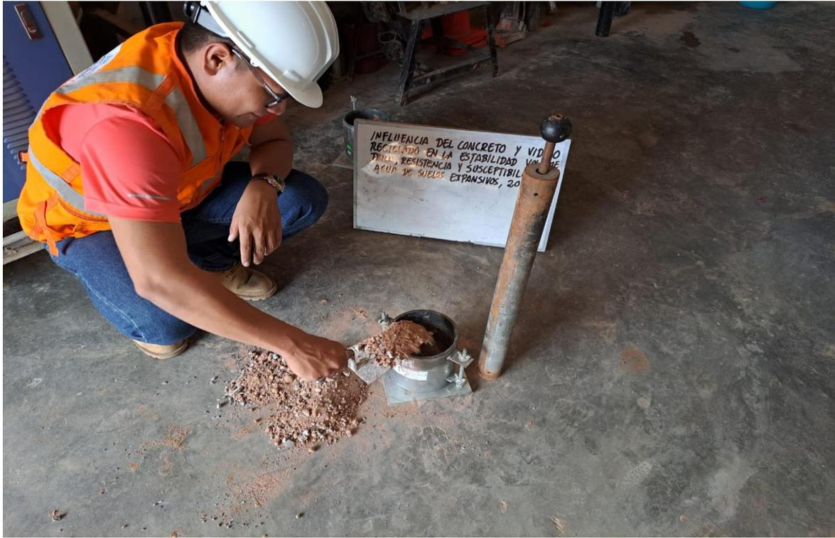
Imagen N°05: Colocación de muestra para ensayo proctor.
