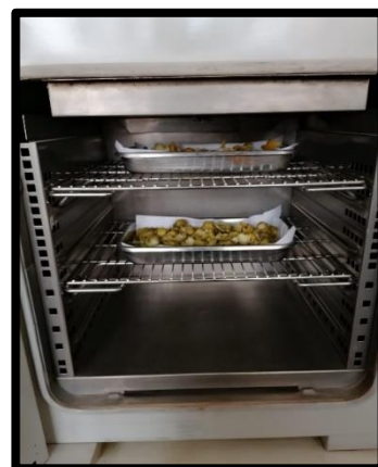
Figura 6: Secado de la cascara de limón a 90°C por 24 h
