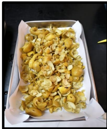
Figura 6: Secado de la cascara de limón a 90°C por 24 h
