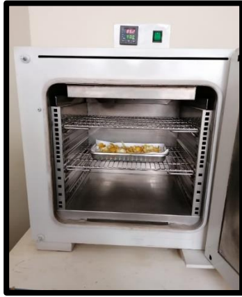
Figura 5: Secado de la cascara de naranja a 90°C por 24 h
