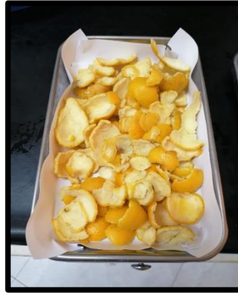
Figura 5: Secado de la cascara de naranja a 90°C por 24 h
