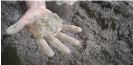
Foto 11: consistencia de la mezcla para la elaboración del ladrillo Fuente: Elaboración Propia
