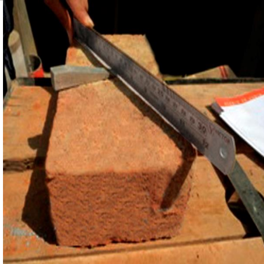
Foto 15: ensayos de alabeo Fuente: Elaboración Propia
