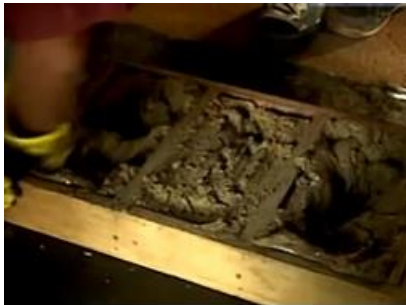
Foto 13: elaboración de ladrillos en los moldes Fuente: Elaboración Propia
