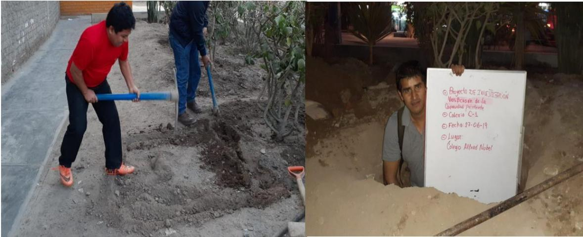
Figura 26: Calicota para la muestra de suelo. Fuente: Elaboración propia
