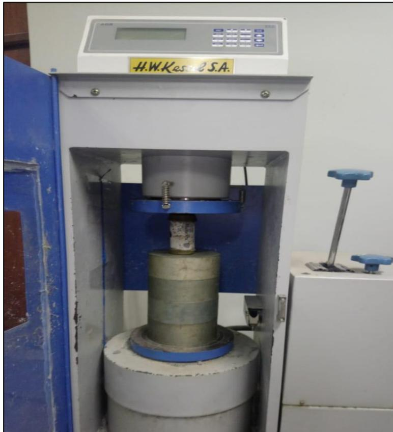
Figura 42: Proceso de rotura de la muestra para hallar la resistencia. Fuente: Elaboracion propia
