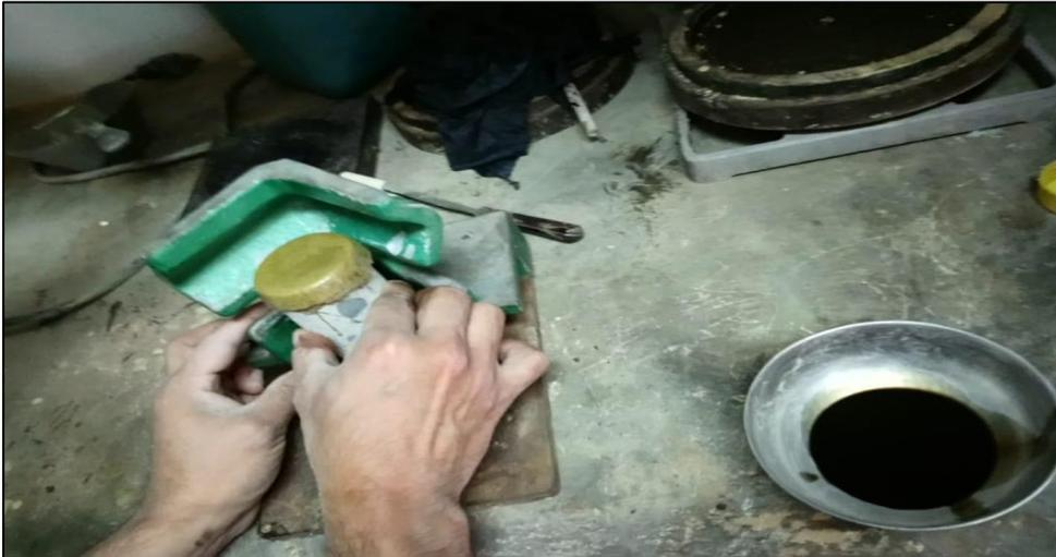
Figura 39: Alineamiento de la probeta con sulfato. Fuente: Elaboracion proia
