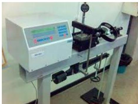
Figura 30: Instrumento para el corte directo. Fuente internet
