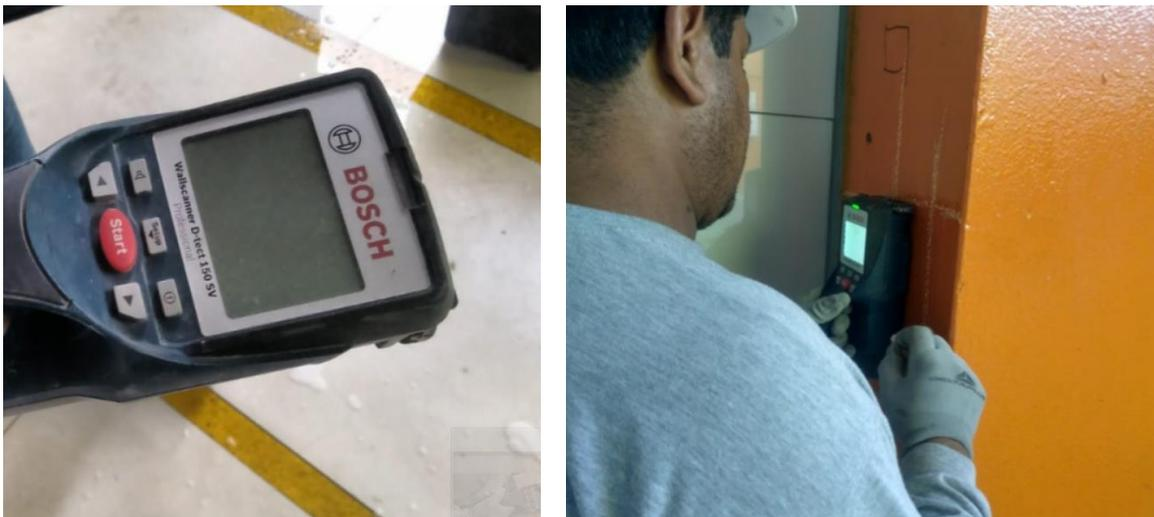
Figura 34: Instrumento escaner para detectar acero de refuerzo. Fuente: Elaboración propia
