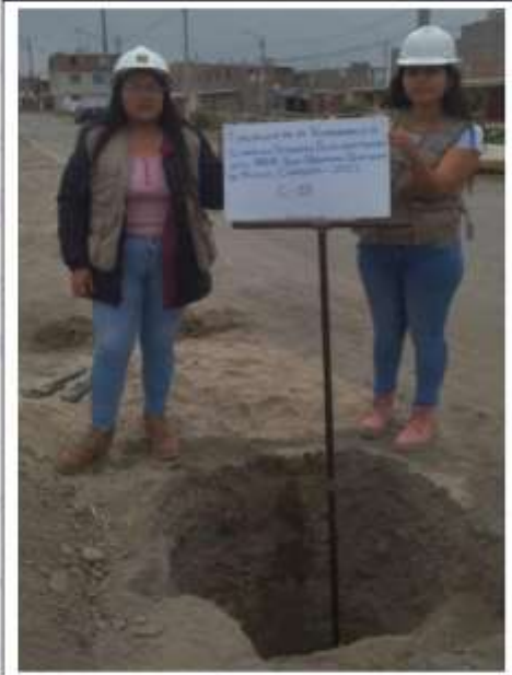
Foto N°01: Vista de ubicación de la calicata C-01, en su parte superficial presencia de material de relleno conformado por gravas y terreno natural de 0.00 a 0.70m.; seguidamente de arena mal graduada (SP) de compactación muy densa, seca y de color beige claro de 0.70 a 2.00m; y arena mal graduada (SP) de compactación muy densa, ligeramente húmeda y de color beige claro de 2.00 a 3.00m.
