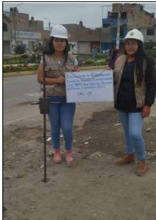
Fotografía 2. Realización de la auscultación DPL-01
