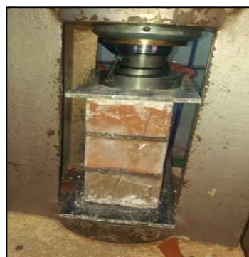
Figura 25. Ensayo de compresión axial en pilas de ladrillos artesanales.
