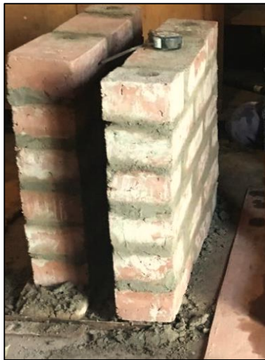
Figura 29. Muros de ladrillos artesanales elaborados.
