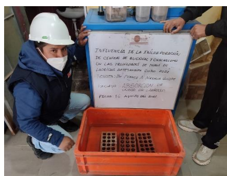
Figura 19. Ensayo de absorción de las unidades de ladrillos.
