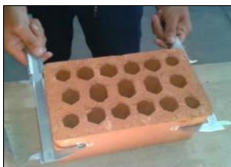
Figura 13. Ensayo de variación dimensional de unidades de ladrillos.
