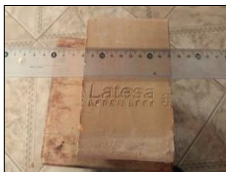
Figura 14. Toma de medidas de la unidad de ladrillo.
