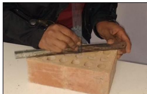
Figura 16. Toma de medidas del alabeo de ladrillos.
