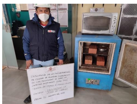
Figura 20. Secado en horno de las unidades de ladrillos.
