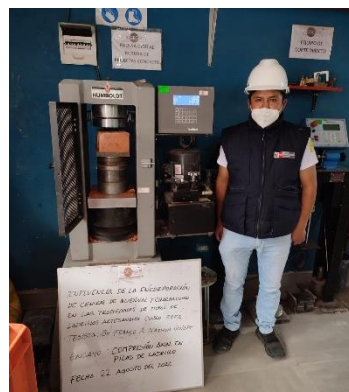
Figura 22. Ensayo de compresión simple de ladrillos artesanales.
