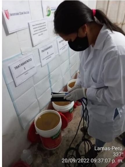
Figura 6: Medición de los parámetros pH, Oxígeno disuelto, Conductividad eléctrica, Temperatura y Aceites y grasas diariamente.
