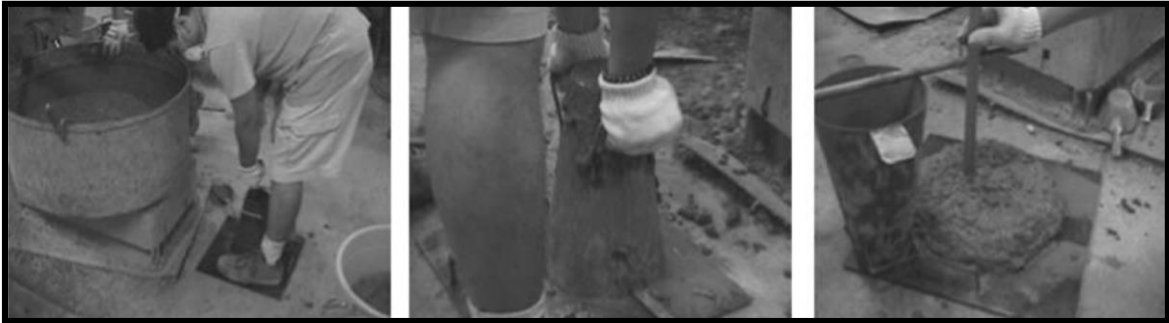
Figura 2. Secuencia de la prueba de asentamiento Fuente: Zongjin li, 2011
