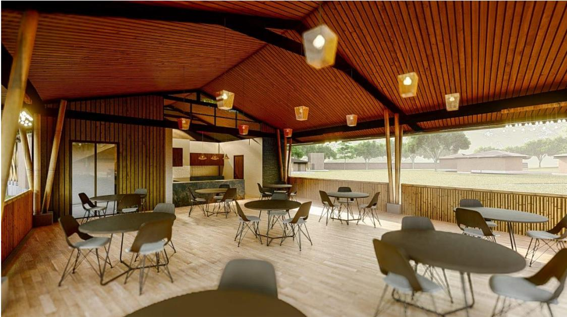
*Nota 1.* En esta figura se muestra la propuesta del interior de la Cafetería, las estructuras están compuesta por elementos de apoyos vertical con Bambú, y vigas metálicas como soporte estructural para el techo. En los ambientes del área de trabajo, almacén y SS. HH los cerramientos son de albañilería tarrajeados y pintados en color blanco.
