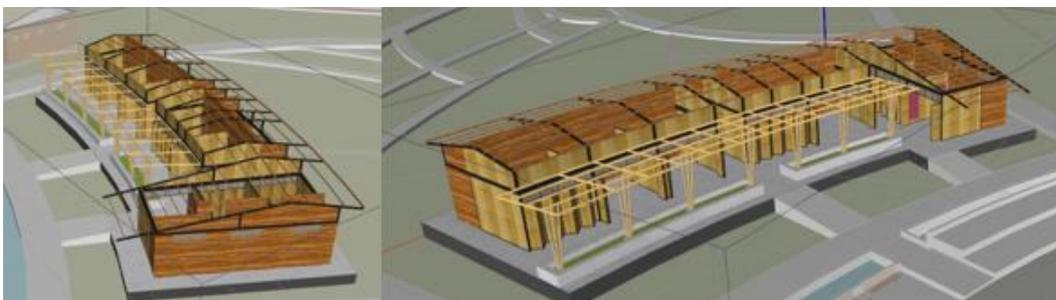
Nota 1. En esta figura se muestra el modelado que corresponde a Módulos de Souvenirs, se aprecia que contiene está hecha con estructuras livianas base de Perfiles metálicos, y también se propone columnas de Bambú en exteriores.
