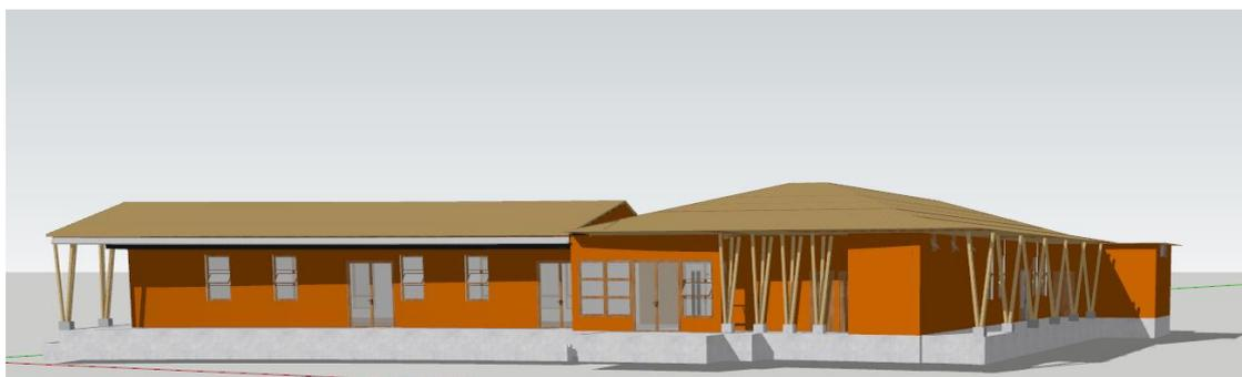
Nota 1. En esta figura se muestra la volumetría de los Talleres y Sum, se aprecia que el diseño está compuesto por techos inclinados y en elementos de apoyos con Bambú adosados en dados de concreto.
