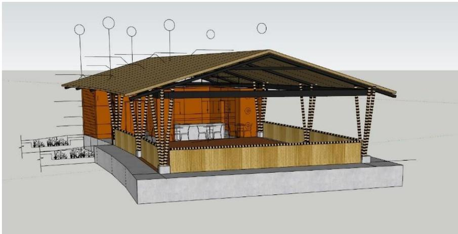
Nota. En esta figura se muestra la Volumetría de la Cafetería, contiene columnas de Bambú apoyadas sobre dados de concreto. Los techos son a base de estructura Metálica con vigas metálicas y correas de madera.
