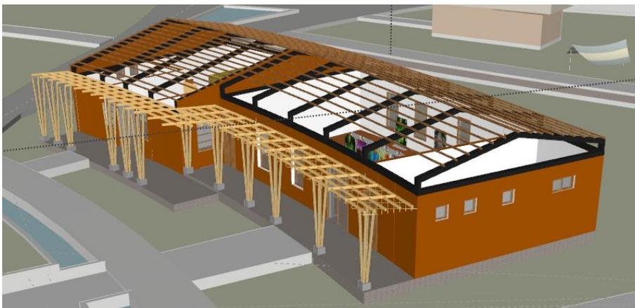
Nota 1. En esta figura se muestra el modelado que corresponde a los ambientes de Mini Museo y Salón de Exposiciones, se aprecia que contiene columnas de Bambú en exteriores.
