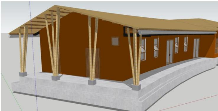
Nota. Se muestra el sistema drenaje pluvial propuesto a través de canaletas metálicas y cunetas perimetrales al borde del volumen.
