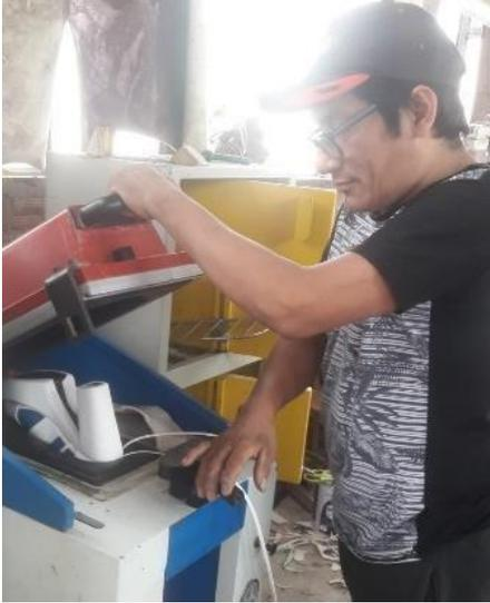
En la figura 4, se aprecia al trabajador realizando tarea de pegado del calzado en la pegadora a presión, aplicando una ligera fuerza al momento de cerrar la tapa, al igual que en la colocación del calzado para que quede exacto.
