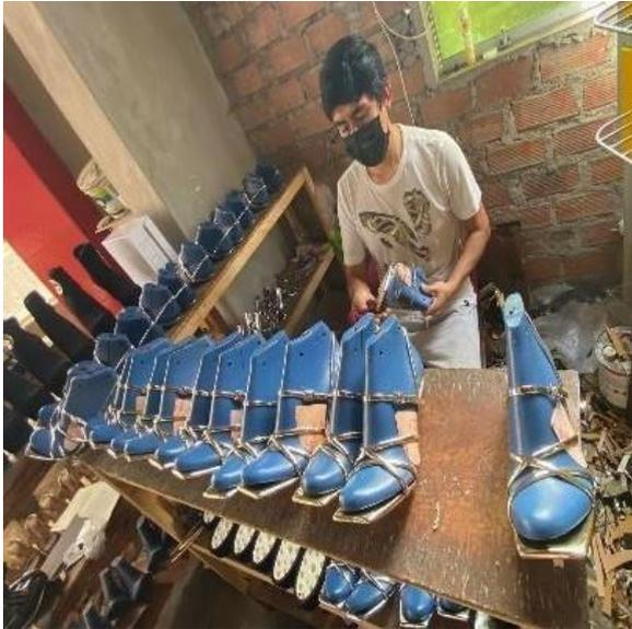
En la figura dos se observa a un colaborador ejecutando su tarea de modelamiento del calzado en la horma o prototipo de muestra para obtener una determinada talla, los materiales se encuentran en sus laterales tanto en la parte superior como inferior, los cuales debe estar haciendo uso sin descanso a excepción de su refrigerio.
