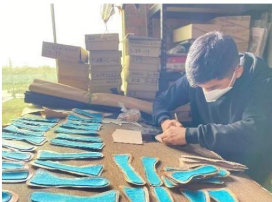
En la figura 5 se observa a un colaborador realizando una tarea de modelamientos y corte de plantillas inferiores y superiores para el armado del calzado.
